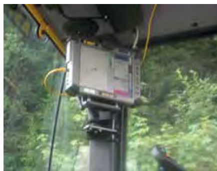
Bomag setzte drei Tandemwalzen mit der GPS-Ausstattung „Bomag Starfire“ ein.
