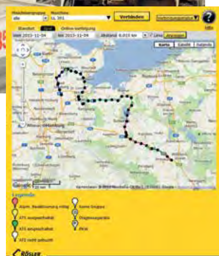
Rösler Obserwando zeigt mit der EQTrace Funktion den Weg der jeweiligen Maschine. Via Internet und Obserwando-Maske kann das im Büro nachverfolgt werden.
