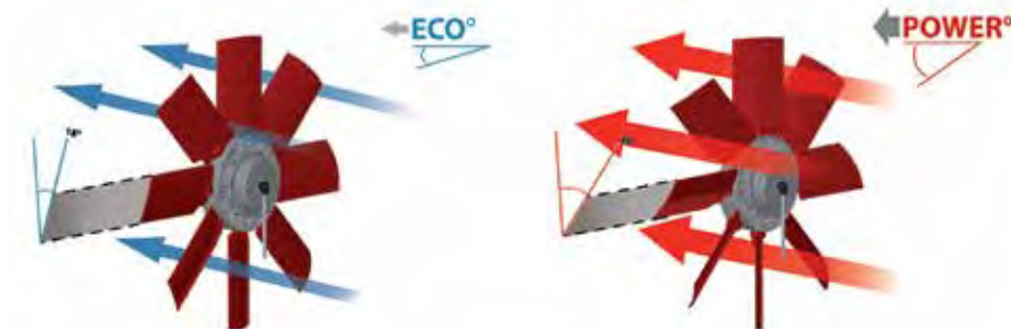
Die Leistungsaufnahme eines Ventilators richtet sich nach dem Winkel seiner Flügel.
