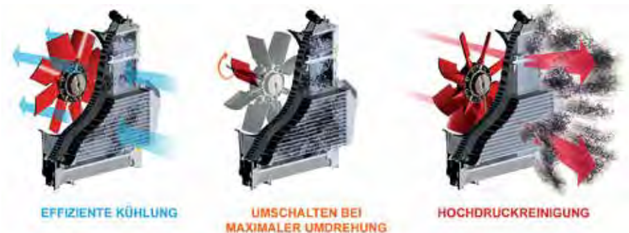
Funktionsprinzip des Cleanfix Umschalt-Ventilators.
