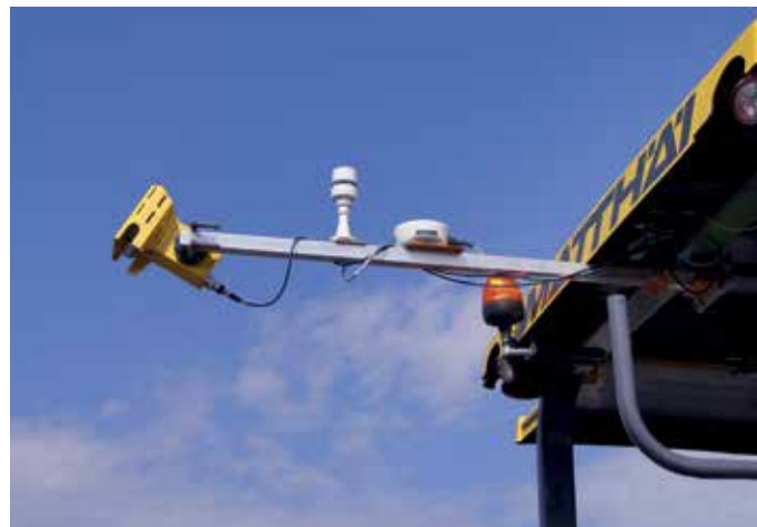
Scanner, Wetterstation und GNSS-Antenne werden platzsparend und ohne das Personal zu behindern auf einem simplen Vierkantholz am Fertigerdach montiert.
