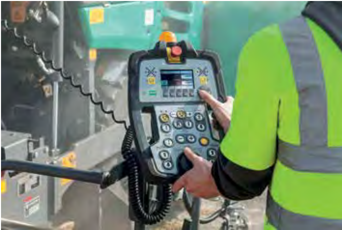
Selbst bei grellem Sonnenschein war das brillante neue Farbdisplay gut lesbar. Und mit dem neuen SmartWheel war präzises Aus- und Einfahren der Bohle ganz einfach.
