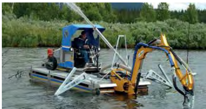
Kommt an jeden Einsatzort: Amphibischer Geräteträger Truxor, der mit einer leistungsstarken Tsurumi-Schlammpumpe eine effiziente Pumpstation darstellt (Foto: Dorotea Mekaniska)
