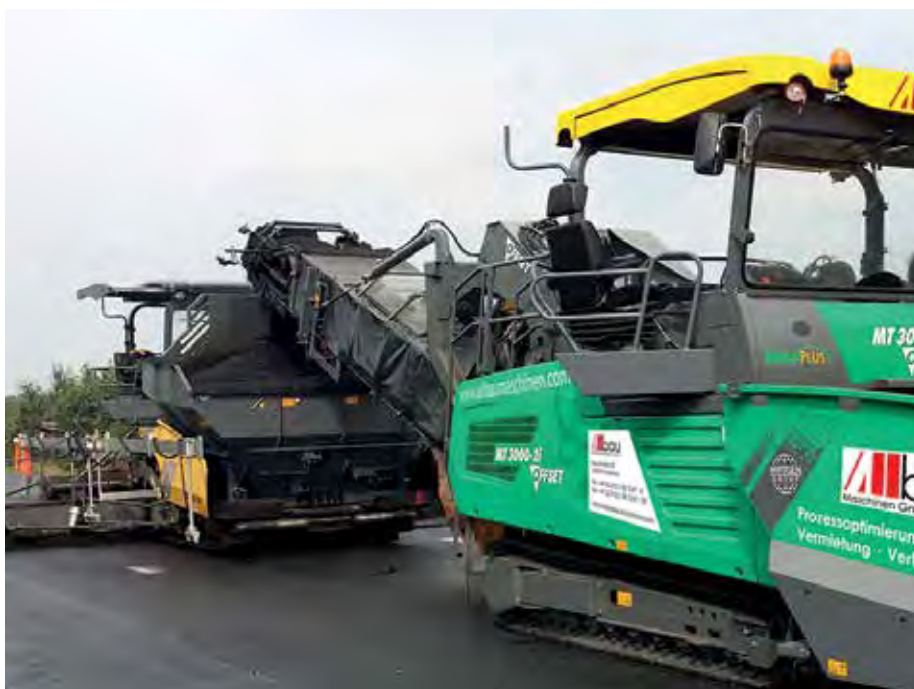
Eine Spezialität von Allbau ist die Vermietung von modernsten, leistungsfähigen Beschickern für den prozessoptimierten Straßenbau. (Foto: Allbau)
