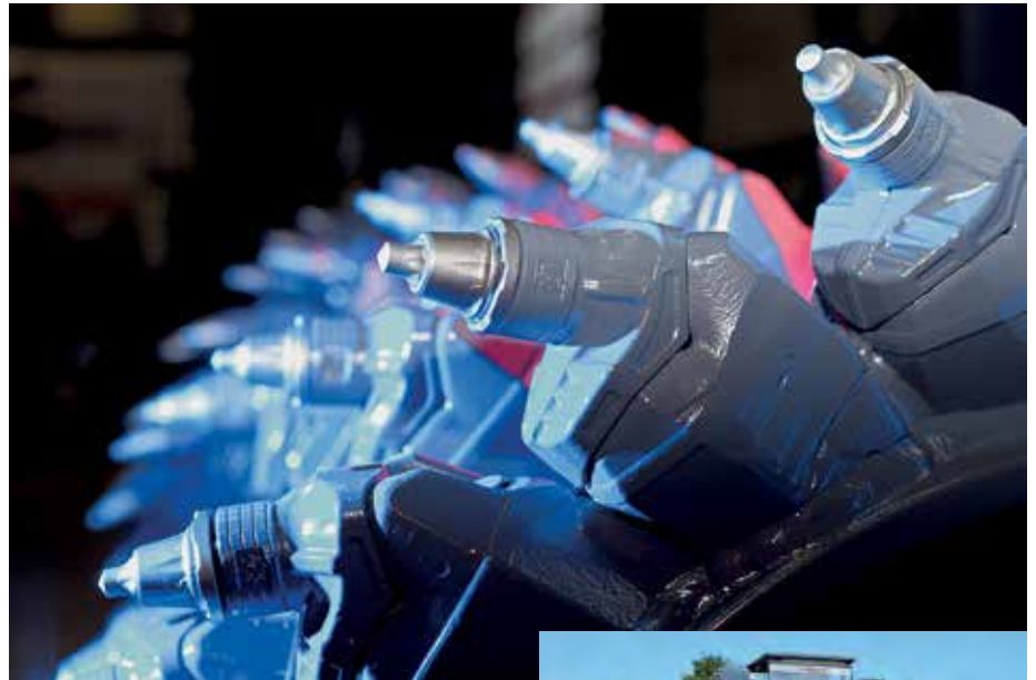
Die innovative Hartmetallspitzengeometrie der Generation X vereint die Vorteile der zylindrischen und kappenförmigen Hartmetallspitzen.
