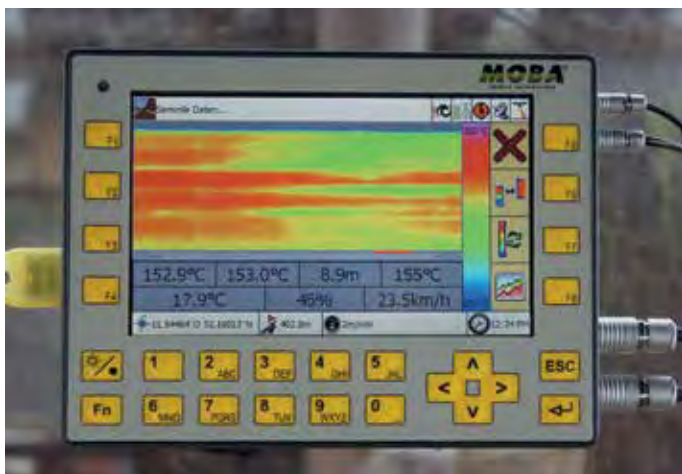
Auf dem Panel zeigt das System dem Personal in Echtzeit das Temperaturprofil und alle weiteren relevanten Informationen an.
