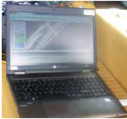
Die Walzen waren über GMS vernetzt, die Daten können direkt auf einen PC weitergeleitet werden.
