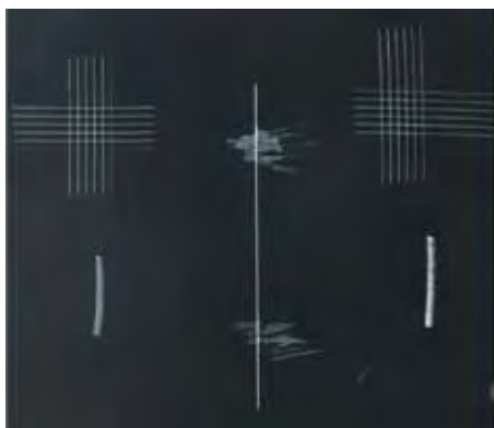
Der Salzprühtest mit 2000 Stunden Einsatz zeigt identische Ergebnisse: links die Zinkstaubgrundierung (Standard), rechts die thermische Spritzverzinkung (Option).
