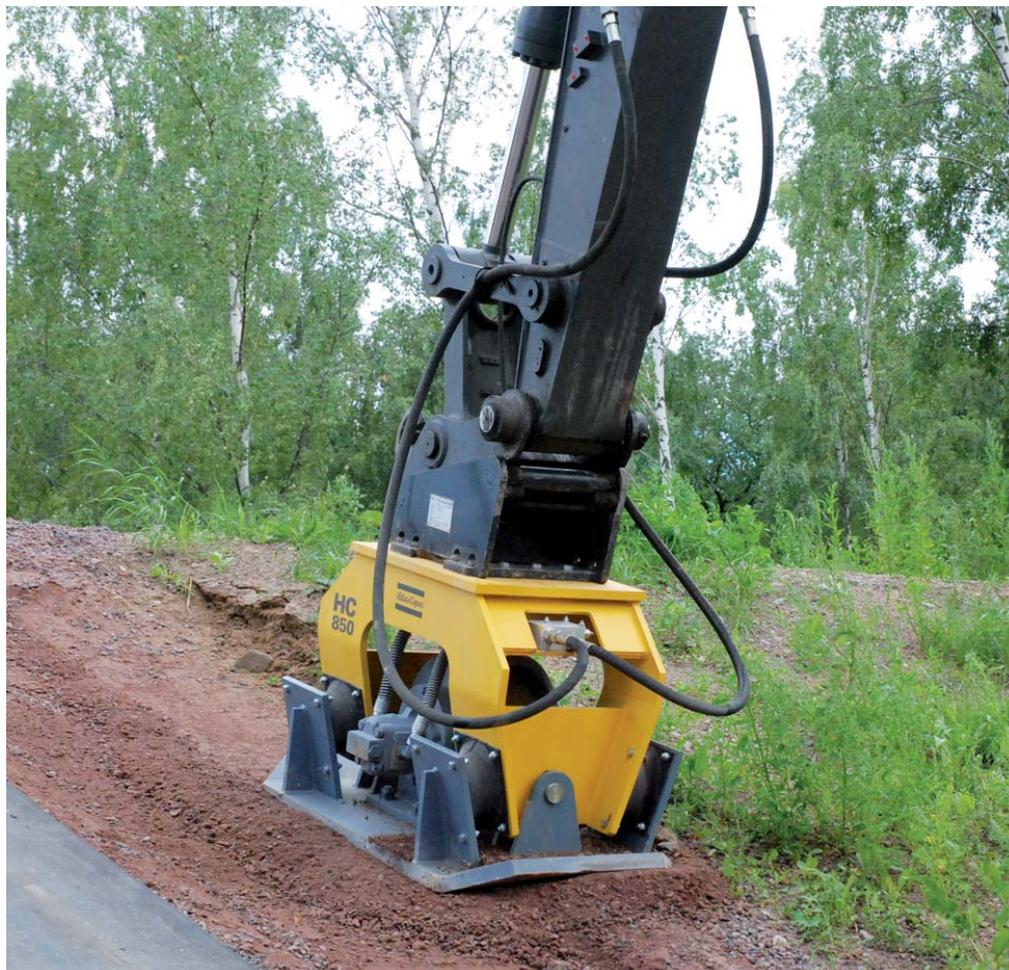
**Der neue Anbauverdichter** von Atlas Copco im typischen Einsatz. (Foto: Atlas Copco)
