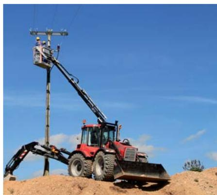
**Drei Maschinen** in einer: Huddig Volt integriert Bagger, Lader und Hubarbeitsbühne.
