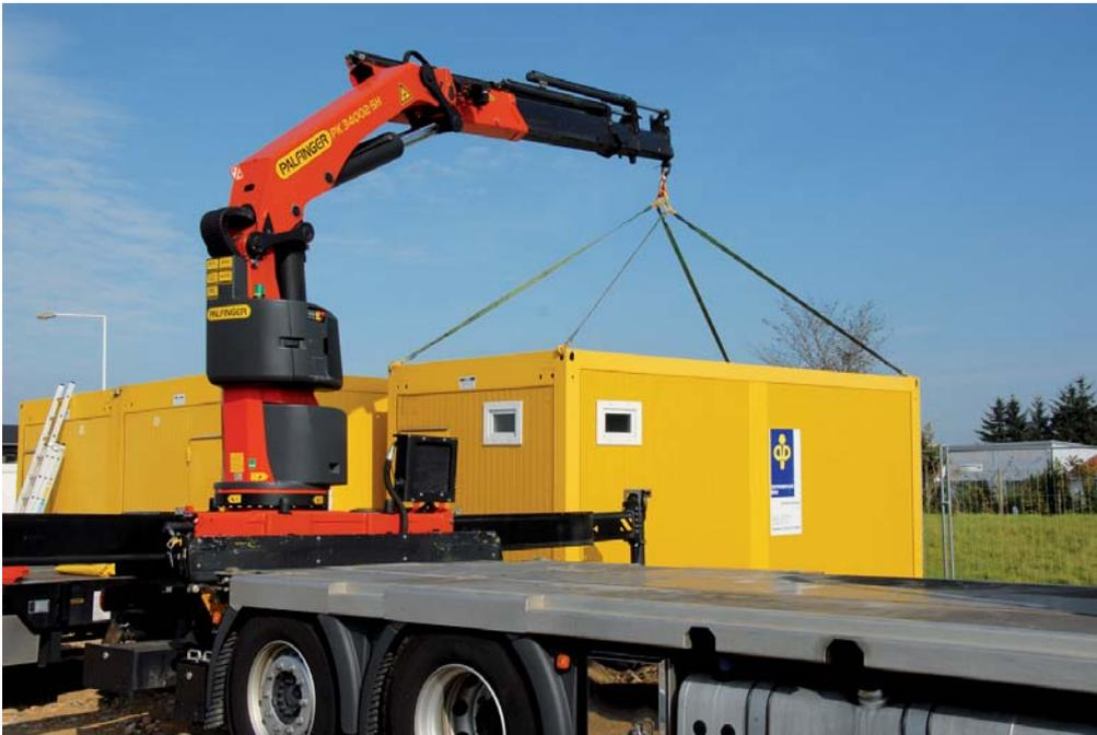
**Auch für den „Ein-Mann-Betrieb“ geeignet:** Mit der Fernsteuerung wird der Bürocontainer mit dem heckmontierten Kran vom Zugfahrzeug abgelassen. (Fotos: Palfinger)
