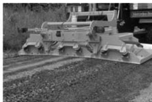
Drei-Plattenverdichter mit Dachprofil
