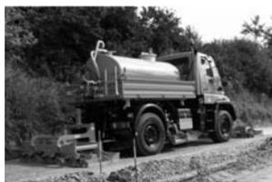
Drei-Plattenverdichter-Kombination mit Kantenplattenverdichter
