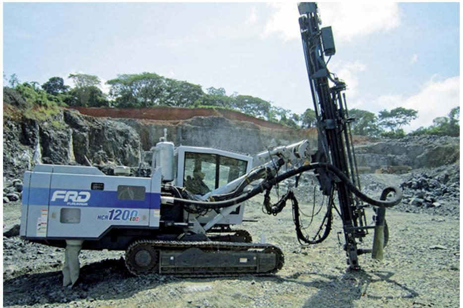
Ein FRD Bohrgerät mit Moba MDS-2000 ermöglicht kontrollierte Sprengungen mit glatten Abbruchkanten. (Fotos: Moba)
