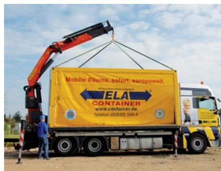
**Am Kran hängend,** wird der für den Transport mit einer Plane geschützte seitlich offene Container für die Montage vorbereitet.
