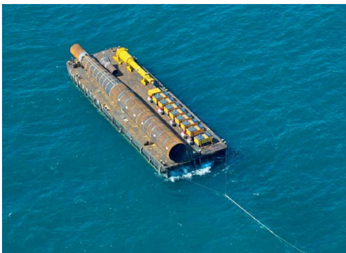
Auf dem Ponton befinden sich der Monopile, worauf die Forschungsplattform, ein Helideck und ein 80-m-Mast mit Messtechnik errichtet werden, die Ramme und die neun Kompressoren.
