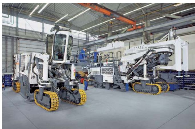
Ab 2009 werden Großgeräte wie die hier abgebildeten Surface Miner in der neuen Halle montiert. Die Produktion ist vollständig auf die Anforderungen der Spezialmaschinen zugeschnitten.
