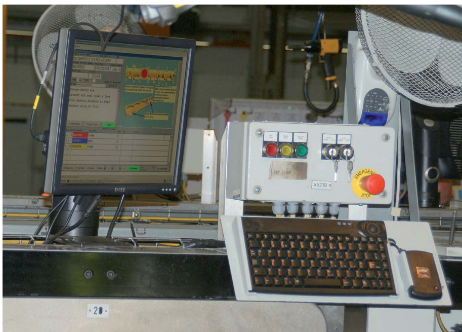
Auf dem Monitor sind die einzelnen Montageschritte vorgegeben, die nacheinander abgearbeitet werden müssen.
