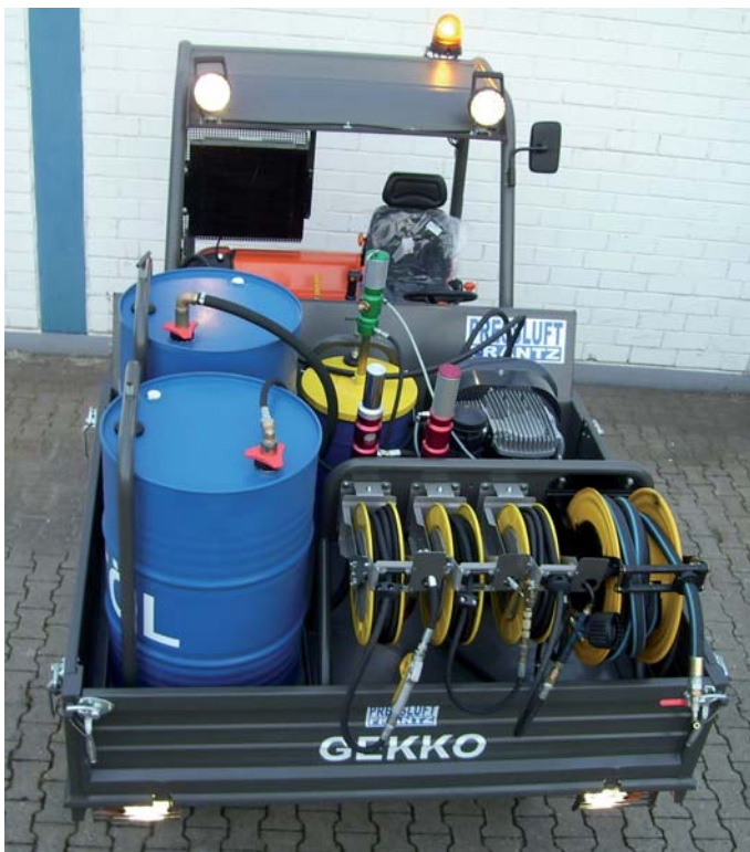
Zur Serviceeinheit gehören eine Öl- und Fettförderstation sowie eine Druckluftanlage, hier mit verschiedenen Schläuchen ausgestattet. (Fotos: Pressluft Frantz)
