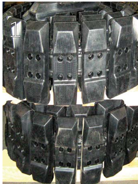
Für große und schwere Raupenbagger bietet LIS Gummielemente an: Sie können mit Gummipolster-Kettenplatten (1), mit Gummipolsterelementen, die am Kettenstrang angeschraubt werden (2), und mit anklemmbaren Gummipolsterelementen (3) ausgerüstet werden. (Fotos: LIS)
