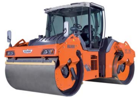
Die Tandemwalze HD+140 verfügt über ein neues Knickgelenk, einen großen Wassertank und einen ergonomisch gestalteten Fahrersitz.
