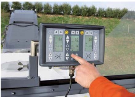
Maschinensteuerung und Nivelliersystem werden zur Einheit: Sie kommunizieren miteinander und automatisieren das Arbeiten. (Fotos: Wirtgen)
