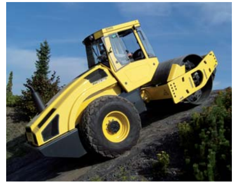
In Aktion: Hier nimmt ein Walzenzug BW 213 DH der 4. Generation problemlos eine große Steigung ohne Verdichtungsverluste.
