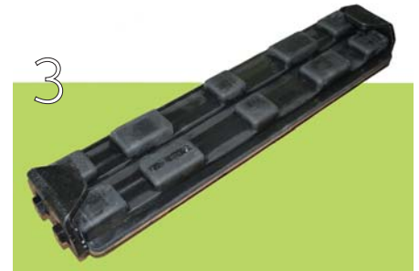
Für große und schwere Raupenbagger bietet LIS Gummielemente an: Sie können mit Gummipolster-Kettenplatten (1), mit Gummipolsterelementen, die am Kettenstrang angeschraubt werden (2), und mit anklemmbaren Gummipolsterelementen (3) ausgerüstet werden. (Fotos: LIS)
