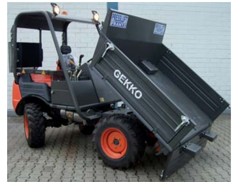
Als Transportfahrzeug kann die Pritsche 2 t aufnehmen und ist kippbar.
