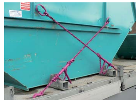
Die ICE 120-Zurrkette besitzt hervorragende Eigenschaften, hier in richtig angewendeter X-Zurrung. (Foto/Abb.: RUD)
