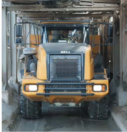
Die enge Silodurchfahrt ist mit 3,40 x 3 m ein echtes Nadelöhr.
