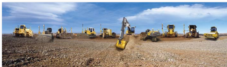
Die GCS Produktreihe von Trimble kann auf zahlreichen Maschinen installiert werden, z.B. auf Raupen, Walzen, Gradern, Scrapern, Baggern. (Foto: Trimble)
