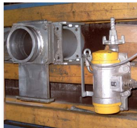
Die Außenvibratoren, hier im Einsatz, lieferten sehr gute Betonierergebnisse. (Fotos: Wacker)
