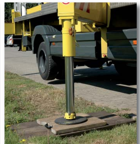
Richtig abgestützt: Eine Unterlegplatte bietet den Abstützpratzen eine feste Auflage und dem Fahrzeug einen sicheren Stand.
