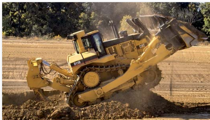
Geballte Kraft im Einsatz: der Kettendozer D11R mit 634 kW Antriebsleistung, 98,5 t Einsatzgewicht und einer Schildkapazität von 34,4 m 3 .
