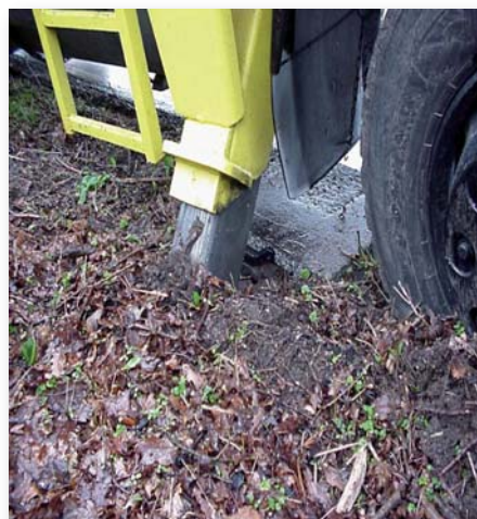
Falsch abgestützt: Der Abstützpratzen versinkt im Boden. Das Fahrzeug hat keinen festen Stand.
