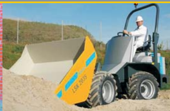
Dumper LSK 2035 – 3,5 to Nutzlast
