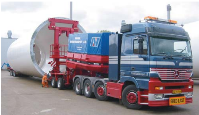
Als kompakt und wirtschaftlich entpuppt sich der neue Tiefladesattelanhänger EuroCompact. Auf 22 m Ladefläche transportiert er bis zu 80 t Gewicht.
