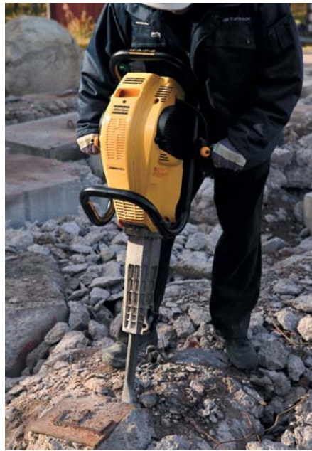
Ihr Leistungsgewicht von 2kW bei 25 kg macht die „Cobra mk1“ seit knapp zehn Jahren zum Spitzenmodell im Sortiment von Atlas Copco.
