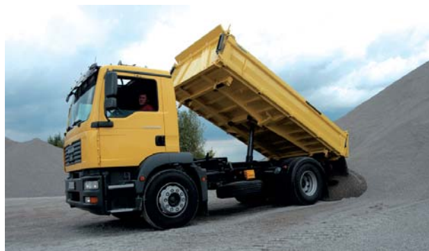
Der Meiller-Aufbau des TGM 18-2080 wiegt 1.650 kg. Die Öffnung der Bordwand wird durch Federkraft unterstützt.
