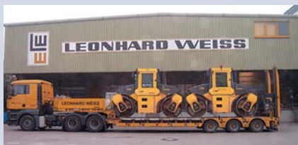
Einer für alles: Doll modifizierte einen Vario-Tiefladesattelaufleger vom Typ S3H-0 derart, dass dieser nun als multifunktionaler Semi-Tieflader zwei Walzenzüge, einen Grader mit Heckaufreißer und einen Bagger problemlos transportiert. (Fotos: Doll)
