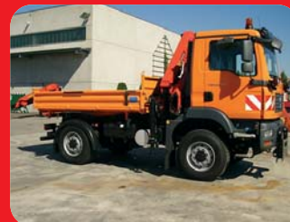
MAN 13.240 BL 4x4, kurzes Fahrerhaus, Euro4 Radstand 3250mm, Dreiseitenkipper 3200mm, Winterdienst PALFINGER Kran PK 8501 B4 HPLS, hydraulische Reichweite 9,6m, Hochstand
