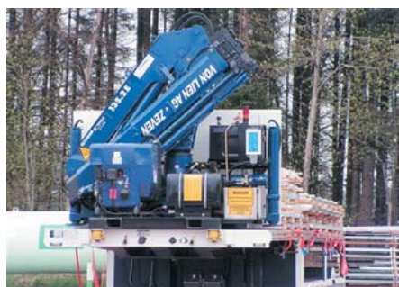
Der Ladekrantyp 135.2 E bietet mit einer Ausladung von 10 m eine Tragkraft von 1,13 t. Das Besondere: Sämtliche Arbeitsgänge werden bei diesen Modellen per Funk gesteuert.
