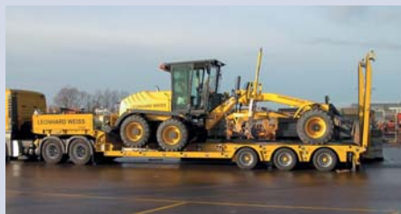
Einer für alles: Doll modifizierte einen Vario-Tiefladesattelaufleger vom Typ S3H-0 derart, dass dieser nun als multifunktionaler Semi-Tieflader zwei Walzenzüge, einen Grader mit Heckaufreißer und einen Bagger problemlos transportiert. (Fotos: Doll)
