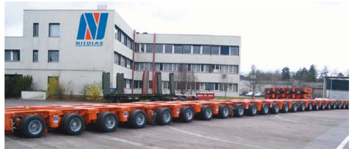
Die Schwerlast-Pendelachsfahrwerke eignen sich mit 22 t Achslast für den Straßen- und Industrieinsatz.
