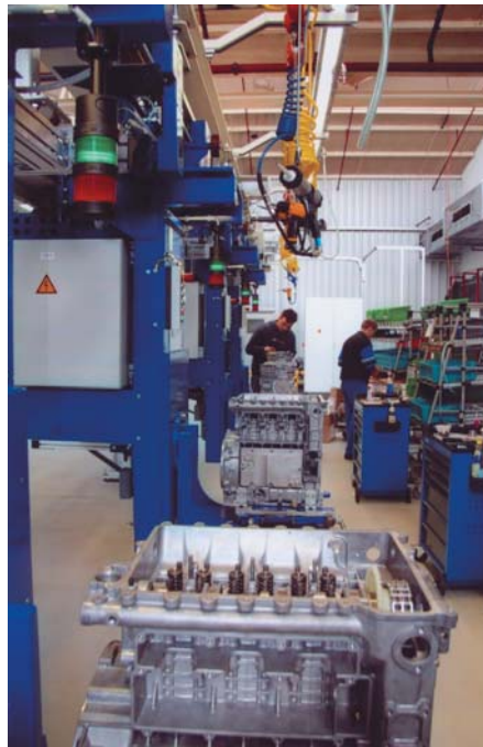
An 30 dieser neuen Arbeitsplätze produziert Hatz bis zu 40.000 Motoren der neuen flüssigkeitsgekühlten Baureihe W35 TOPIC pro Jahr.
