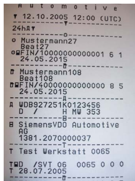
Der Ausdruck zeigt im Kopfteil die UTC-Zeit (hier 12:00 Uhr) an, die in Deutschland im Vergleich zur Ortszeit ein oder zwei Stunden weniger beträgt.
