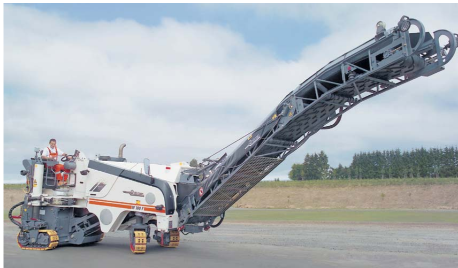
Die W 100 F besitzt eine maximale Fräsbreite von 1 m und fräst 32 cm tief. Sie ist standardmäßig mit Ketten oder optional mit Rädern erhältlich.
