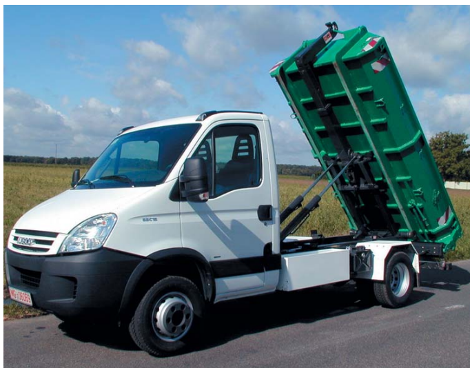
Den Iveco Daily gibt es auch als Abroll-Version, hier mit einem Abroller von Gotzen.
