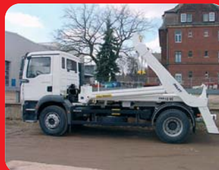
MAN 18.280 TGM 4x2 BB, kurzes Fahrerhaus, Radstand 3875mm PALIFT Absetzkipper PAK 13SC, Hubkraft 13t, für Behälter nach DIN 30720
