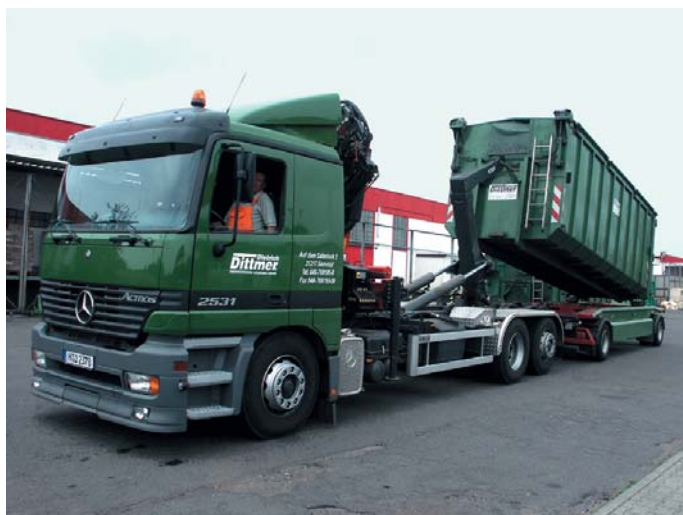
Der Palift Abrollkipper ist mit einem Hakengerät bestückt. Das Auf- und Absetzen bzw. das Umpritschen von Containern erfolgt in Minutenschnelle.
