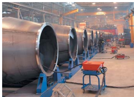
Die neue Fertigungslinie für Fahrmischertrommeln bei der Liebherr-Mischtechnik GmbH in Bad Schussenried, Deutschland. (Foto: Liebherr)
