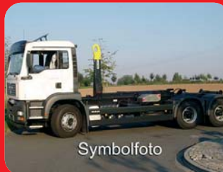
MAN 26.440 BL, 6x4, Langes Fahrerhaus, Radstand 4500mm, PALIFT Abrollkipper T20.65, Hubkraft 20t, Containerlänge 5.000 - 6500mm
