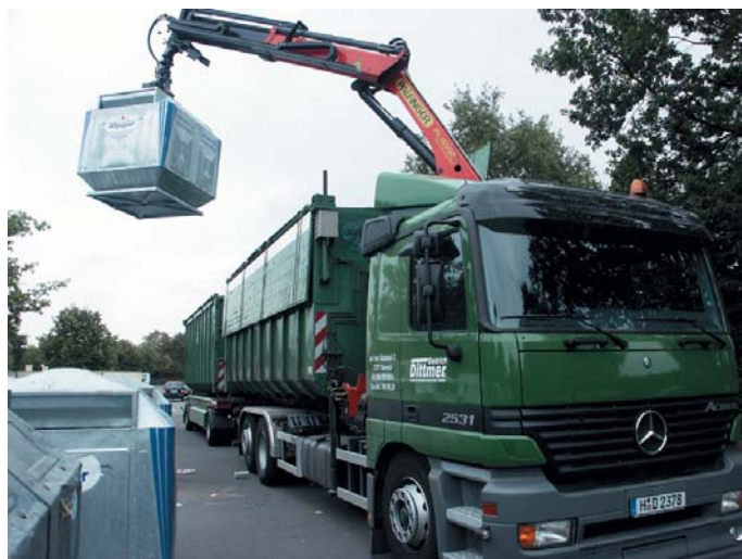
Das Befüllen oder die Entleerung der Container übernimmt ein Ladekran PK 16502 aus der neuen Performance-Baureihe. (Fotos: Sepp Rixner)
