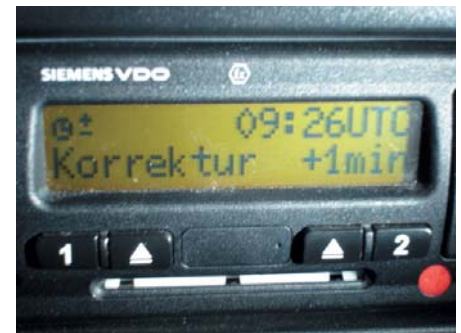
Bei UTC-Zeitabweichungen bis zu 20 Minuten kann der Fahrer täglich eine Minute manuell über eine Eingabe korrigieren.
