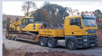
Einer für alles: Doll modifizierte einen Vario-Tiefladesattelaufleger vom Typ S3H-0 derart, dass dieser nun als multifunktionaler Semi-Tieflader zwei Walzenzüge, einen Grader mit Heckaufreißer und einen Bagger problemlos transportiert. (Fotos: Doll)
