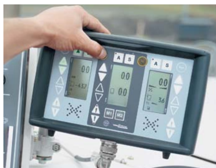
Alles im Blick: Auf dem übersichtlichen Bedien- und Anzeigepanel des Nivelliersystems Level Pro erkennt der Fahrer sofort alle wichtigen Werte.
