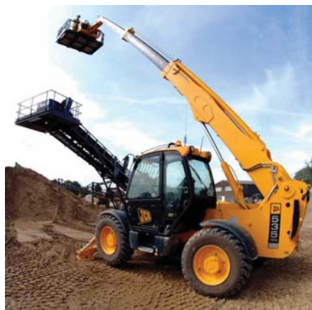
Die großen JCB Teleskopen sind im Handumdrehen mit einer Arbeitsbühne ausrüstbar. Per Funk-Fernbedienung können die Maschinenfunktionen von der Arbeitsplattform aus ausgeführt werden. (Foto: JCB)
