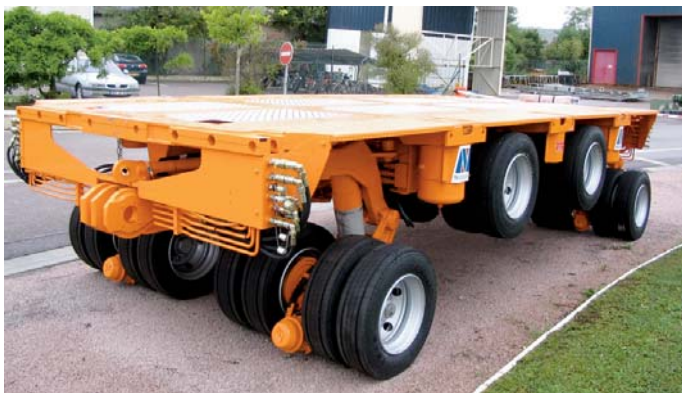
Schergewichte transportiert das 4-achsige MDED-Modul auf Straßen und im Industrietransport.
