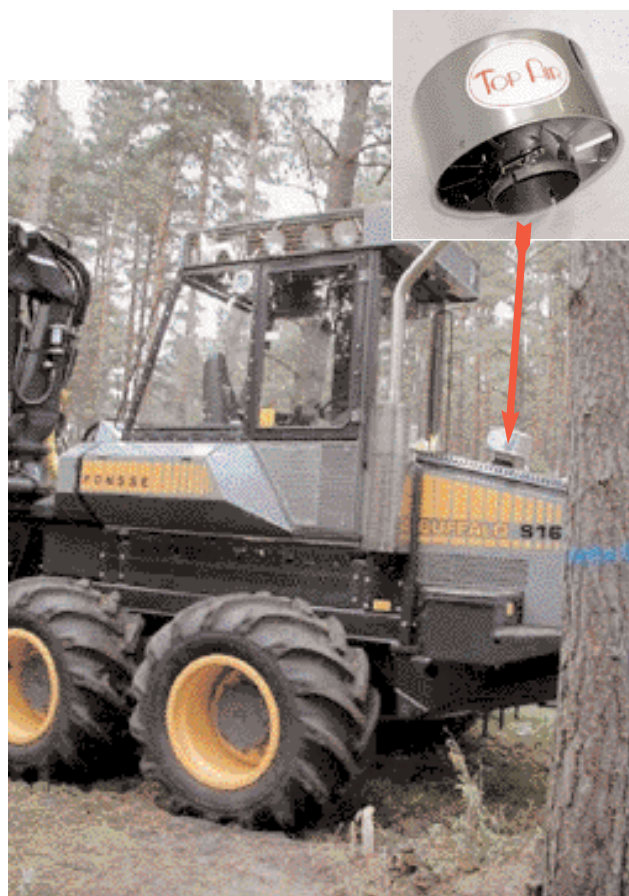
Der Luftfilter-Vorabscheider Top-Air schont Motor, Umwelt und Portmonee. Ihn gibt's in Alu- und glasfaserverstärkter Ausführung. (Foto: Neffgen)
