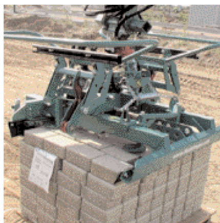
Die neue Verlegezange von Hunklinger kann einen Versatz der Steine sowohl in Längs- als auch in Querrichtung verschieben.
