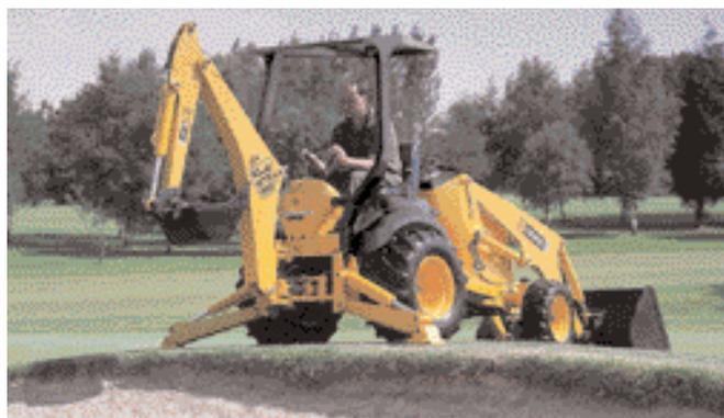
eine Grabbtiefe von 2,54 m und besitzt eine Standardlöfelfbreite von 305 mm. Das Hubgerüst ist trotz seiner kompakten Bauweise für höchste Leistungen konstruiert und lässt eine optimale Sicht auf die Frontanbaugeräte zu, z.B. auf die Standardschaufel mit 0,25 m<sup>3</sup> Inhalt. Fahrer profitieren vom großen JCB-Angebot an Anbaugeräten für Minibagger – sie alle sind mit dem Multibagger kompatibel
