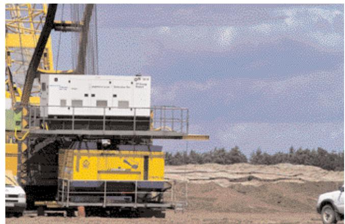
Stromaggregat und CompAir-Kompressor: Gemeinsam für die Bodenverdichtung in der Tiefe. (Fotos: CompAir Drucklufttechnik)
