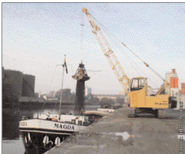
Nobas UB 35 S im Umschlagbetrieb mit Schüttgutgreifer.
