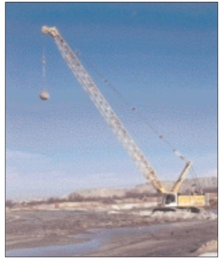
Liebherr Hydro-Seilbagger HS 855 HD – mit Automatiksteuerung zur dynamischen Bodenverdichtung (Bild 2).
