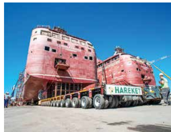
Maßarbeit: Langsam schiebt sich der Goldhofer-Selbstfahrer unter den 124 m langen Koloss.
