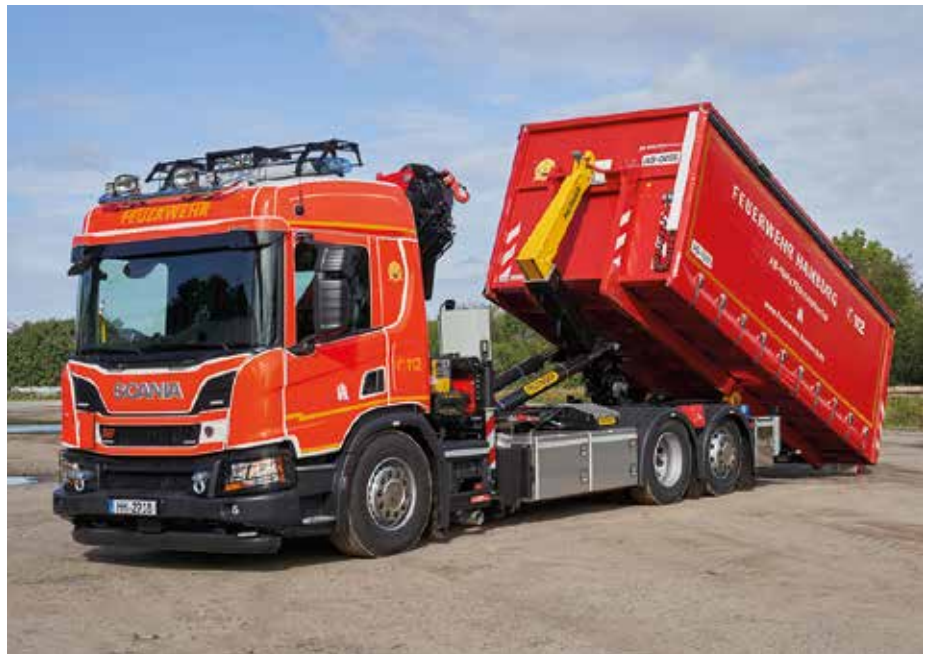
Bedarfsgerecht: Die KFB Soltau GmbH hat fünf neue Scania-Fahrgestelle mit Palfinger-Telescop-Abrollkippern ausgestattet. (Fotos: Palfinger)
