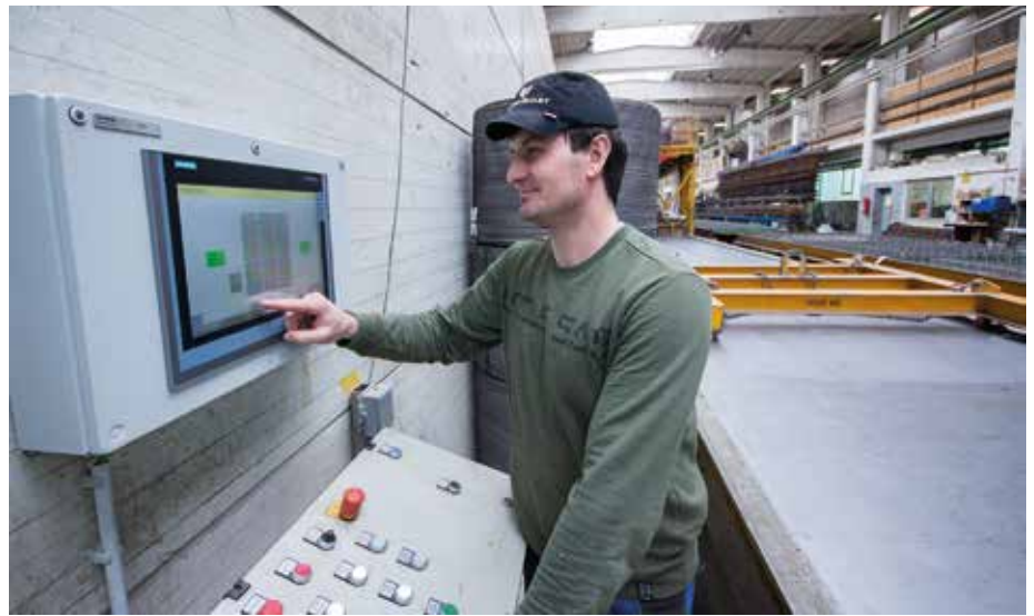
Alles im Blick: Der große Touch-Bildschirm mitten in der Produktion visualisiert die Umlaufanlage und die Härtekammerbelegung. (Foto: Quast)
