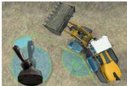
Optimal abgestimmt: Bei der neuen Joysticklenkung entspricht die Position des Joysticks stets dem jeweiligen Knickwinkel des Radladers.
