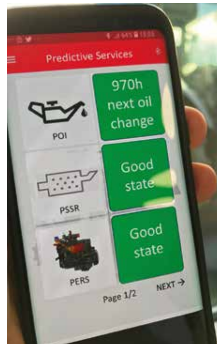
Das Uptime Package von Deutz ermittelt maximale Servicezeiten aufgrund der tatsächlichen Anwendung des Gerätes. (Foto: Deutz AG)
