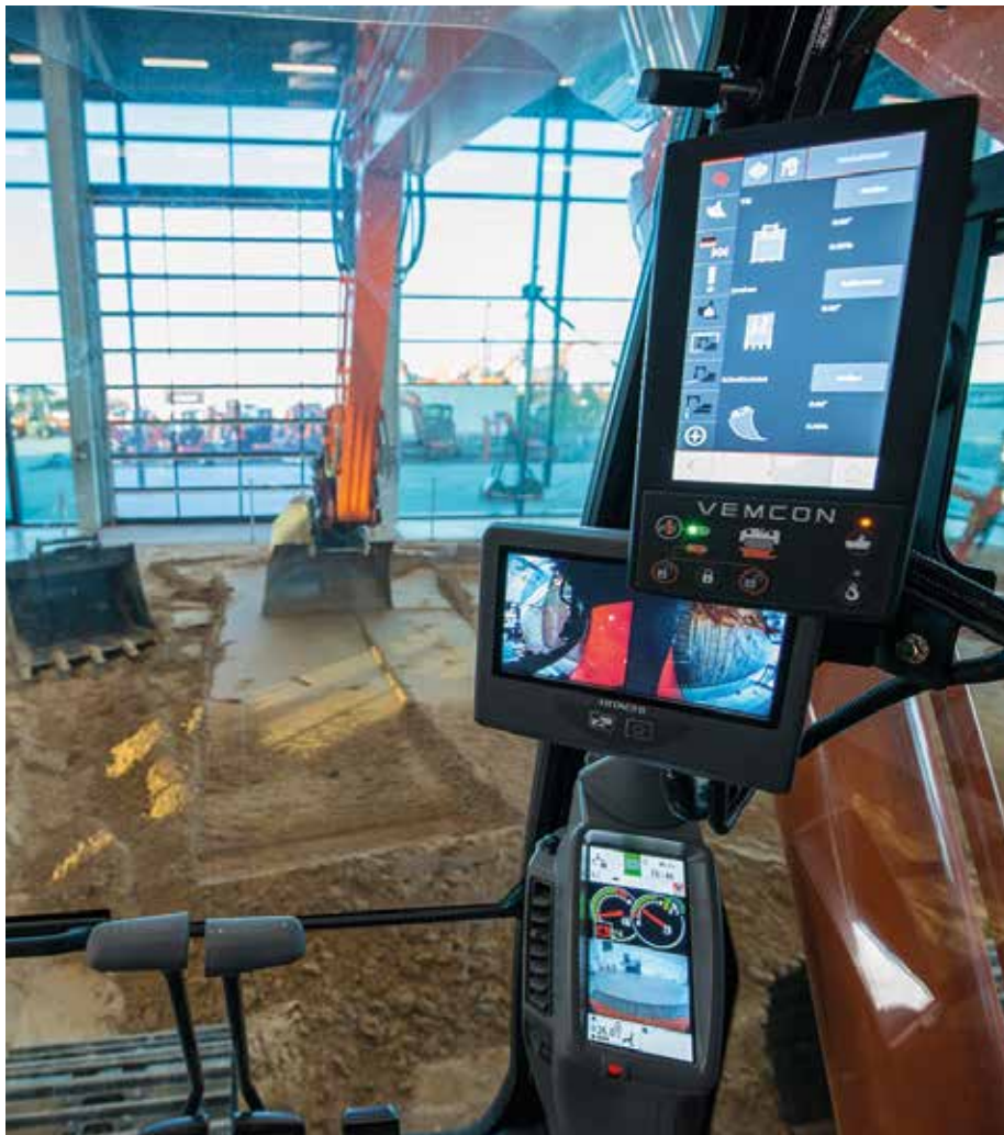
Übersichtlich: Der CoPilot (oben rechts) ersetzt sämtliche Geräte zur Steuerung und Überwachung der Maschine. (Foto: Kiesel)
