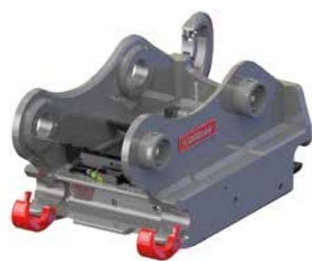
Vollhydraulischer Schnellwechsler für Bagger mit mechanischer Fallsicherung und Sichtanzeige MRL. (Foto: Oilquick)
