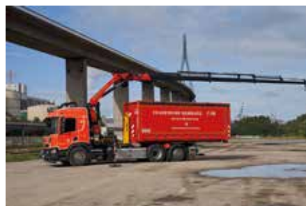
Sonderausstattung: Das sechste neue Fahrzeug der Wache F32 erhielt zusätzlich einen fest aufgebauten Palfinger-Ladekran vom Typ PK 18502 SH.
