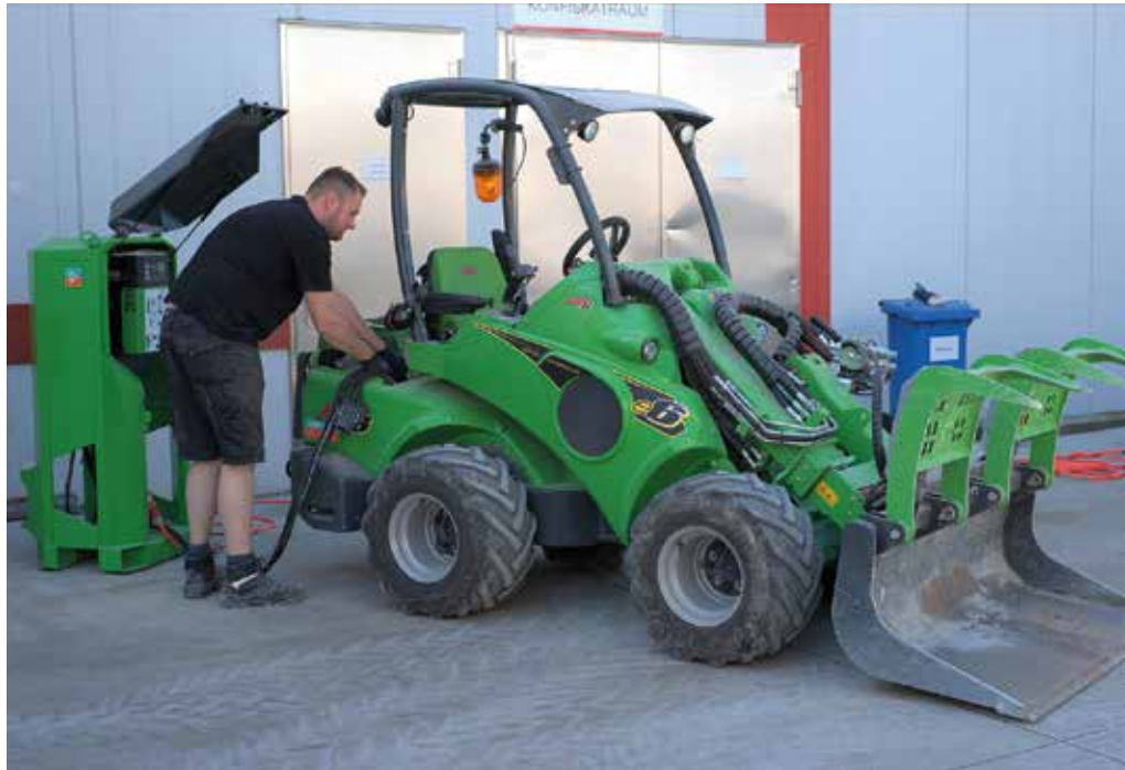
Bitte volltanken: In rund einer Stunde ist die Lithium-Ionen-Batterie des Avant e6 wieder geladen. (Foto: Avant)
