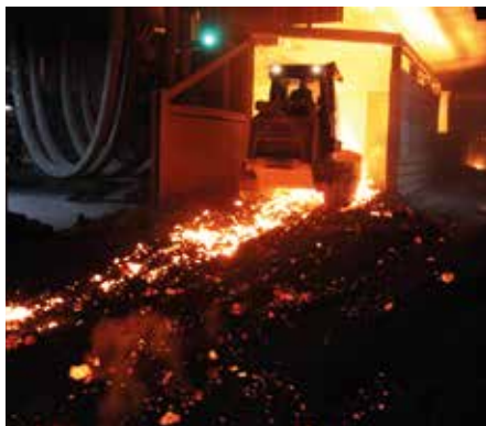
Laderraupe am Limit: Im Stahlwerk Peiner Träger in Peine wird glühend heiße Elektroofen-Schlacke verladen.
