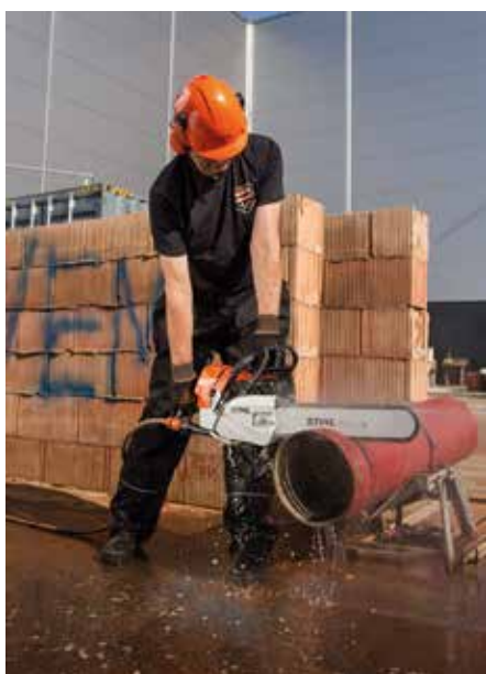
Die Diamant-Trennkette Stihl 36 GGM ermöglicht das Trennen duktiler Gussrohre bei Rohrverlege- und Reparaturarbeiten im Nassschnitt.
