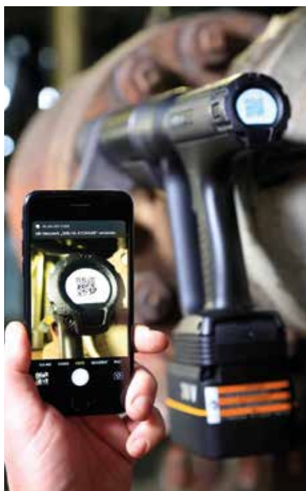
Der Akkuschrauber SRB HA dokumentiert alle relevanten Daten und gewährleistet die Rückverfolgbarkeit der Montage- und Servicearbeiten. (Foto: Atlas Copco Tools Central Europe GmbH)
