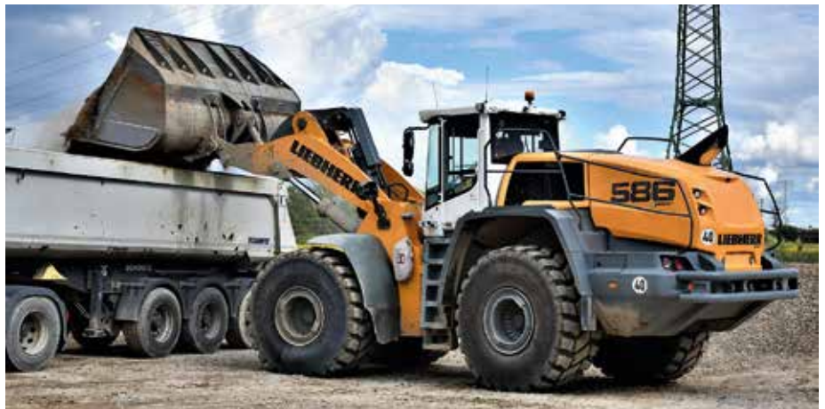
Schnell geladen: Der neue L 586 XPower benötigt nur zwei Ladespiele, um einen Lkw mit aufbereitetem Material zu befüllen. (Fotos: Liebherr)
