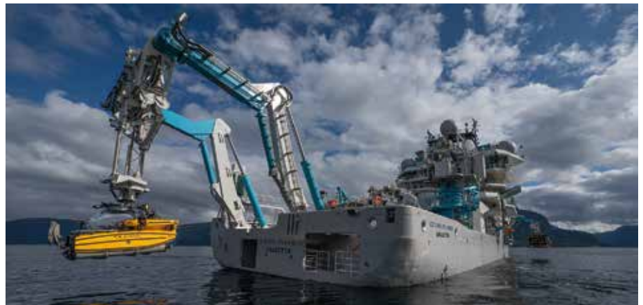
Kraftprotz: Der 40 t-Kran mit A-Rahmen auf der OceanXplorer ist stark genug, um Tauchboote, gezogene Sonaranlagen und andere schwere Geräte zu starten. (Foto: OceanX / Andy Mann)
