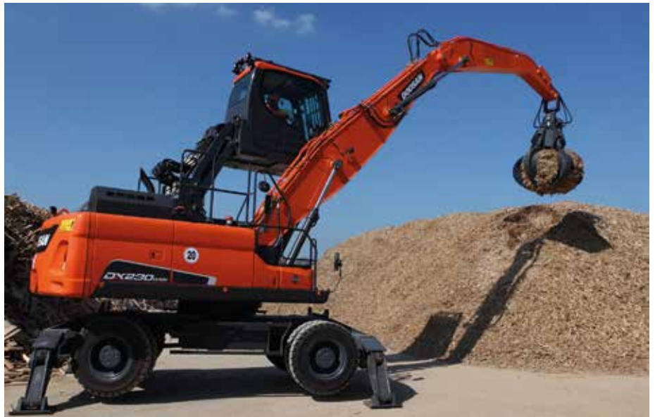
Den Arbeitsbereich im Blick: Die Hubkabine des DX230WMH-5 bietet eine hervorragende Rundumsicht. (Foto: Doosan)
