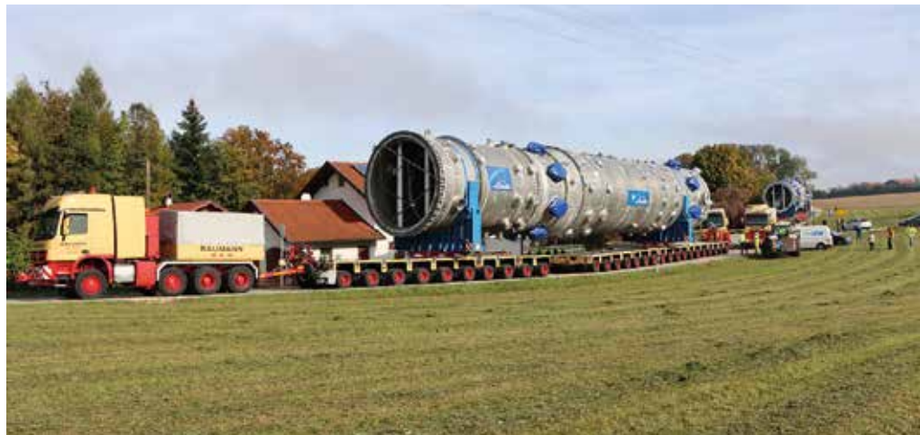
Besonderer Transport: Auf Goldhofer-Schwerlastmodulen der Baureihe THP/SL-L rollen zwei riesige Wärmetauscher über Bayerns Straßen. (Fotos: Goldhofer)
