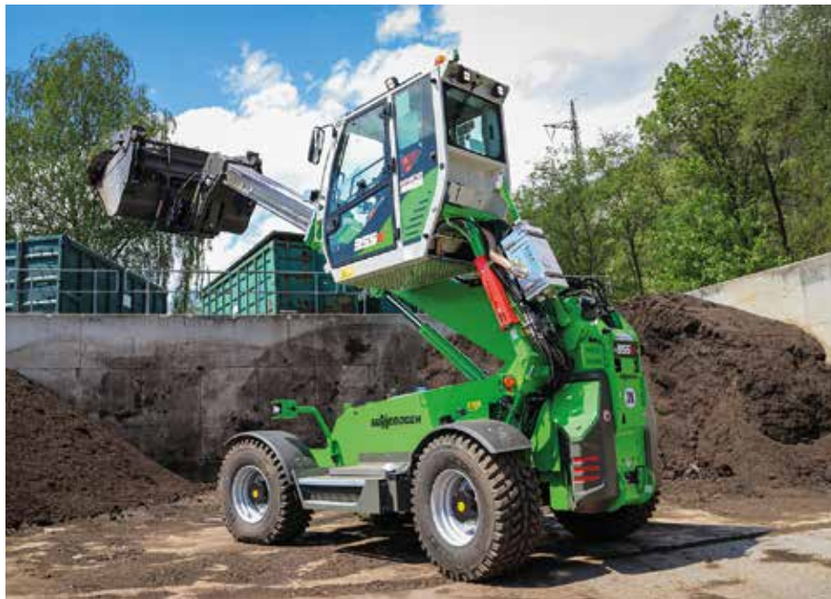
Komfortabel und sicher: Dank der hochfahrbaren Kabine des Teleskopladers 355 E hat Fahrer seinen Arbeitsbereich im Blick. (Foto: Sennebogen)
