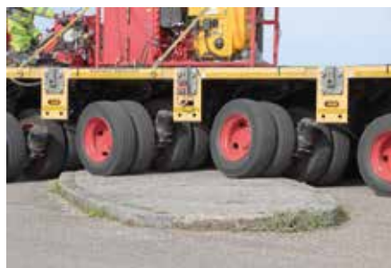
Kein Hindernis: Dank des Pendelachssystems mit seinem hydraulischen Achsausgleich von +/-300 mm stellen Verkehrsinseln kein Problem dar.
