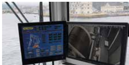
Optimale Bedienung: Der A-Rahmen, die Schleppwinde und die AHC-Winde lassen sich innerhalb der Kabine vollständig einsehen und steuern. (Foto: Palfinger)
