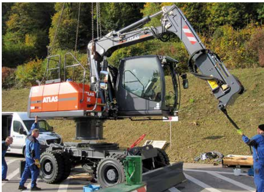
Baggerhochzeit in Eberbach: Bei der Gelita AG wird die Turmerhöhung unter den Oberwagen des Atlas160 MH blue montiert, bevor Ober- und Unterwagen wieder verbunden werden. (Foto: Atlas GmbH)
