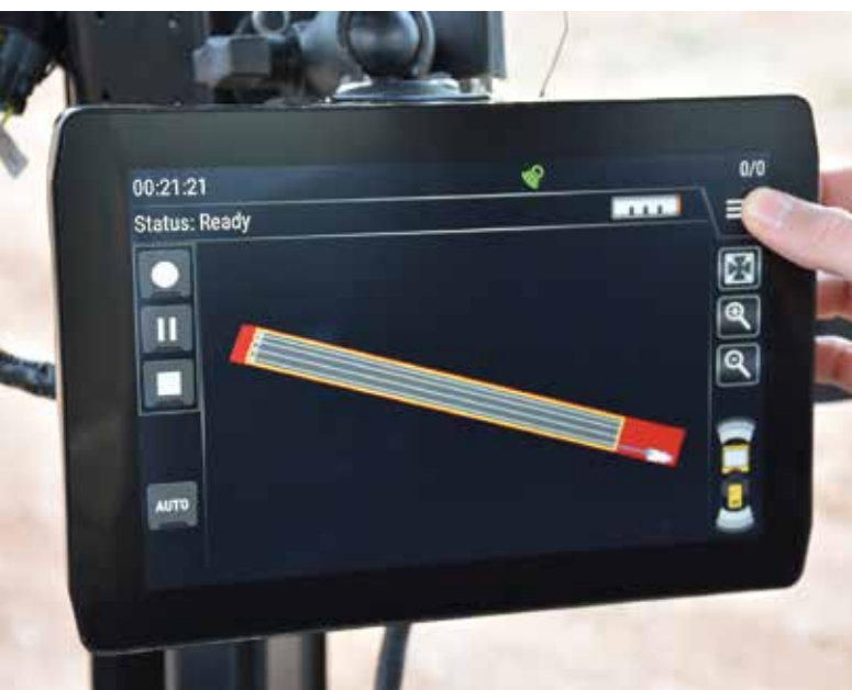
Präzises Arbeiten: Über den Touchscreen-Monitor bildet der Bediener die Grenzen des zu verdichtenden Bereichs ab.
