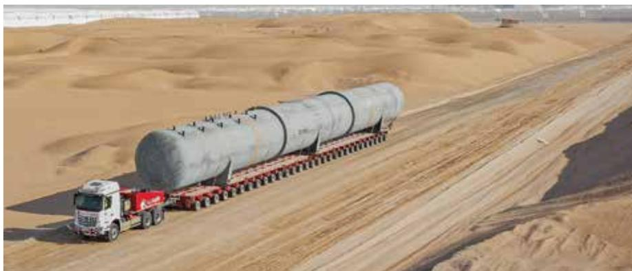
**Auf 30 Achslinien ans Ziel:** 52 m lange und 235 t schwere Tanks werden auf Goldhofer-Schwerlastmodulen des Typs THP/ISL zum weltgrößten Solarpark in Seih AL-Dahal geliefert. (Foto: Al Faris)
