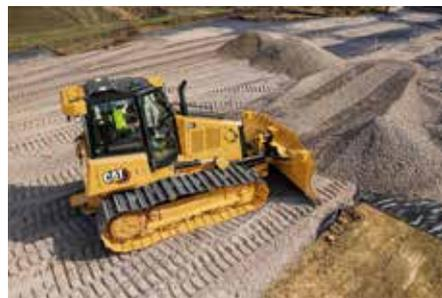
**Optimiert:** Der neue Cat D4 bietet dank der nach vorne tief abfallenden Motorhaube eine um bis zu 30 % bessere Sicht auf den Bereich vor dem Schild.
