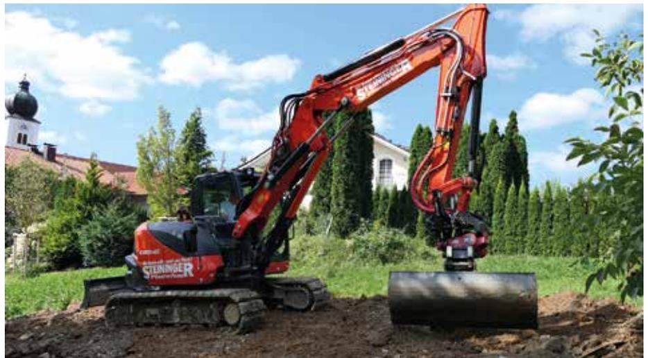
**Zeitsparend:** Dank der 360-Grad-Endlosdrehung des Rototilt muss der Bagger seltener umpositioniert werden. Der Schnellwechsler sorgt dafür, dass das benötigte Anbaugerät innerhalb von Sekunden zur Verfügung steht. (Foto: Rototilt)
