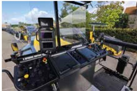
**Optimal abgestimmt:** Über die beiden 7-Zoll-Vollfarbdisplays hat der Maschinist alle relevanten Informationen im Blick.
