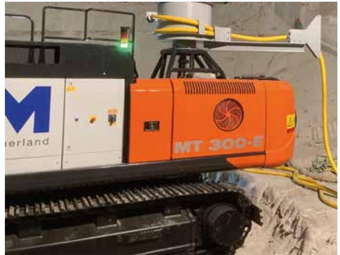
**Gut gelöst:** Die elektrisch betriebene Maschine ausgestattet mit einer endlos drehbaren Stromdurchführung.
