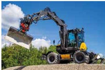
**Integrierte Allround-Lösung:** Mecalac-Tiltrotatoren bieten ein breites Einsatzspektrum und sind relativ leicht. (Foto: Mecalac)
