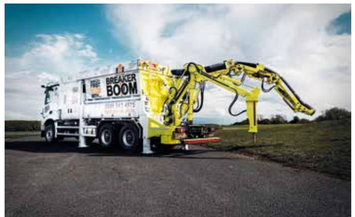
**Neuheit:** Der „Breaker Boom“ besitzt neben dem hydraulischen Schlauchträger und dem Saugstutzen einen zweiten Arm mitsamt separatem Hydraulik-Kreislauf.
