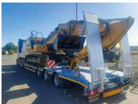
**Einfacher Transport:** Die großzügig dimensionierte Baggerstielmulde des Sattelauflegers Stepstar ermöglicht die Aufnahme von Baggern mit langen Stielen. (Foto: Goldhofer)
