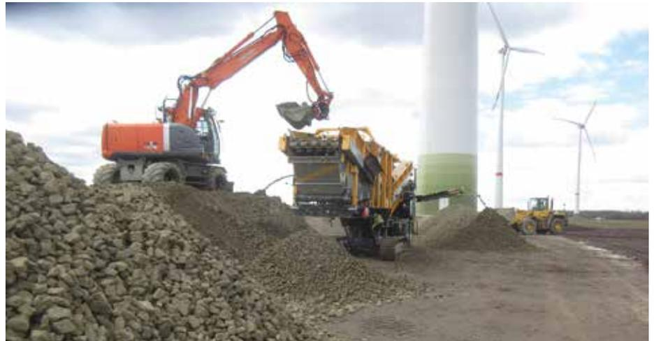
**Das rad- und raupemobile Sternsieb 3-mtb** beim Rückbau von Schotterwegen. Das Aufgabematerial wird bei 60 mm und danach bei 22 mm gesiebt. (Foto: Backers Maschinenbau GmbH)
