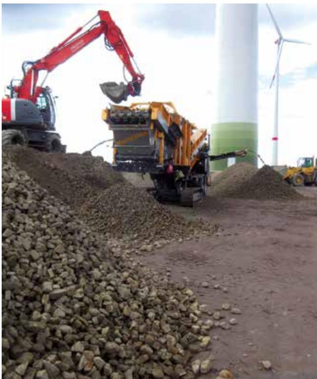
Bodenrecycling mit dem 3- Fraktionen Sternsieb 3-mtb der Firma Backers Maschinenbau GmbH
