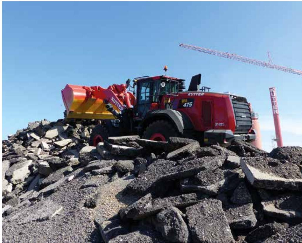
**Kraftvoll:** Asphalt-Fräsgut auf Halde zu schieben ist eine der Aufgaben, die der neue Komatsu WA475-10 bei Kutter im firmeneigenen Asphaltwerk bei Woringen übernimmt. (Foto: Kuhn)
