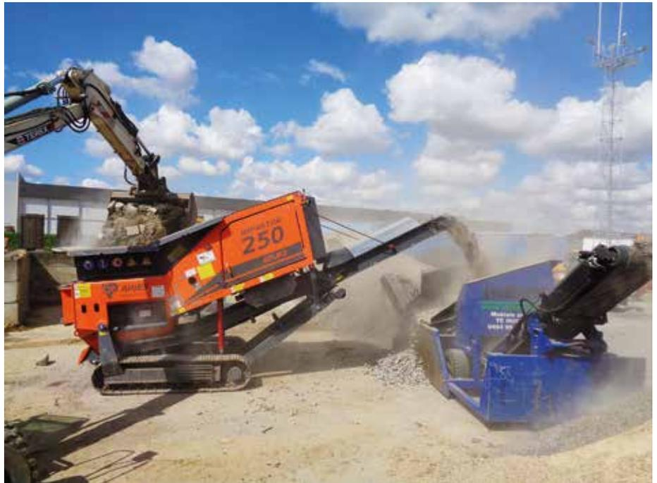
**Kleine Maschine, großer Hunger:** Der Impaktor 250 evo von Arjes wird vom Cat-Bagger mit Bauschutt gefüttert. (Foto: Nicolas Maes)
