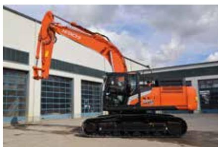
**Ursprungsmaschine:** Der 30 t-Bagger von Hitachi vor dem Umbau, bei er u.a. einen neuen Unterwagen, einen schmaleren Oberwagen, eine angepasste Hydraulik und einen Elektroantrieb erhielt.
