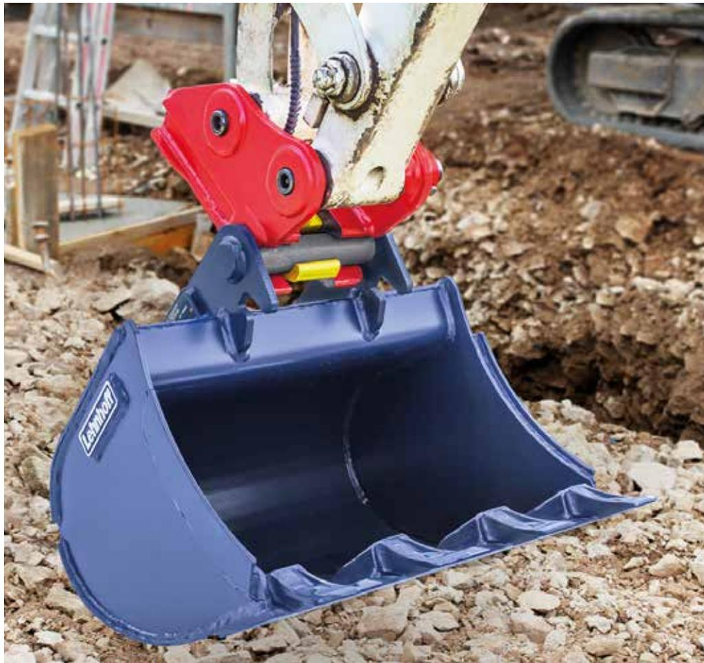
**Gesteigerte Sicherheit:** Die zusätzliche, mittig angeordnete Sicherheitsklaue des hydraulischen Schnellwechslers von Lehnhoff umschließt die Welle. (Lehnhoff Hartstahl GmbH)
