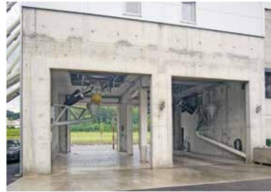
**Praktische Lösung:** Auch die Betonabgaben in den Mischer-Durchfahrten sind an die stationäre Restbeton-Recyclinganlage angeschlossen.
