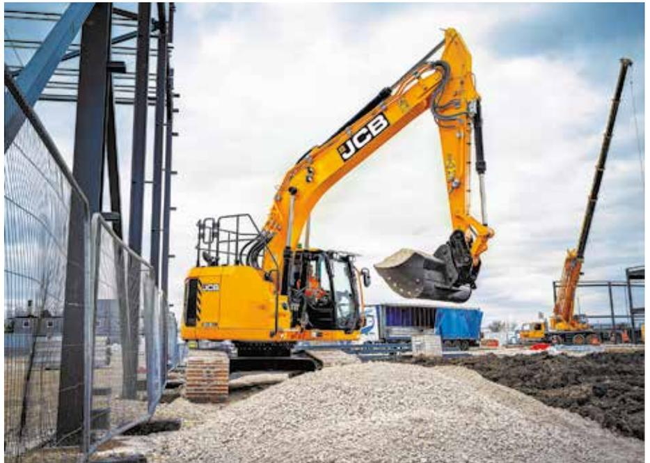
**Wenig Platzbedarf:** Mit einem Heckschwenkradius von nur 1.720 mm empfiehlt sich der 245XR für den Straßen- und Kanalbau und beengte Baustellen. (Foto: JCB)
