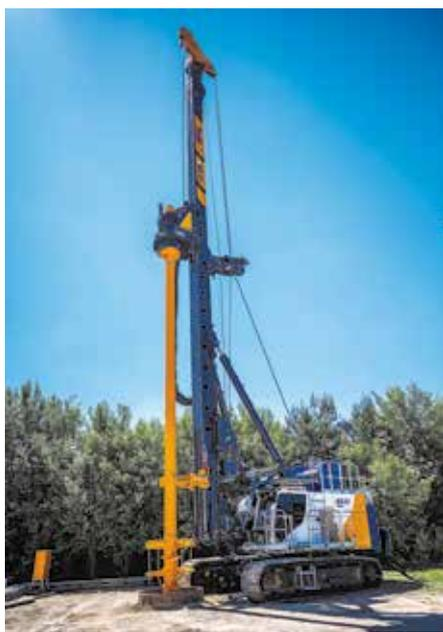
**Premiere:** Die eBG 33 ist das erste elektrifizierte Bohrgerät des von Bauer und mit mehr als 400 kW Antriebsleistung im mittleren Segment der Bohrgerätereihe angesiedelt. (Foto: Bauer Group)
