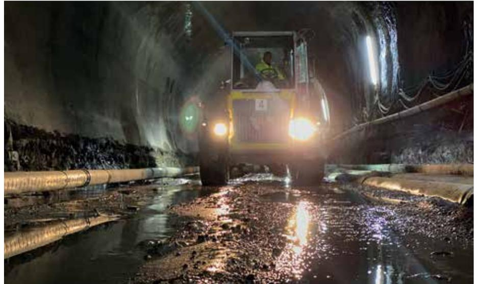
**Schnell und sicher:** Dank der um 180 Grad drehbaren Bedien- und Sitzkonsole der Dual View Dumper entfällt das zeitraubende und gefährliche Rückwärtsfahren. (Foto: Wacker Neuson)
