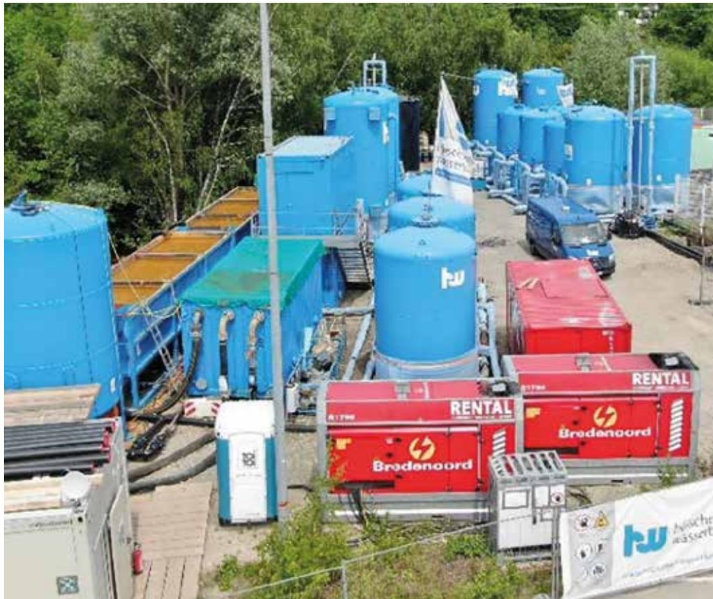
**Komplexes Pumpsystem:** Bredenoord-Aggregate in den Leistungsklassen von 35 kVA bis 80 kVA stellen die ständige Energieversorgung bei einem Gas-Infrastrukturprojekt in Niedersachsen sicher. (Foto: Bredenoord)
