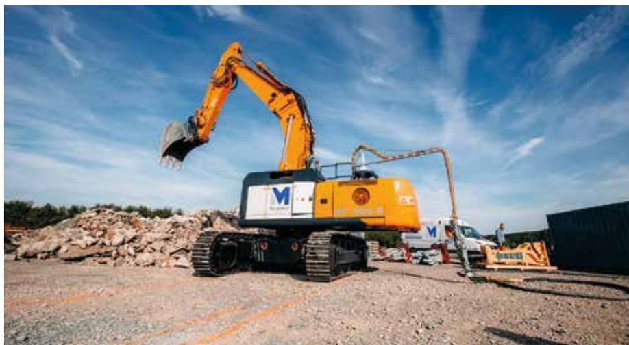
**Modifizierter Kettenbagger:** Die maschinen + technik Sauerland GmbH & Co. KG hat einen elektrisch betriebenen und ferngesteuerten Abbruchbagger für Rückbauarbeiten im Kernkraftwerk Stade realisiert. (Fotos: m+t Sauerland)
