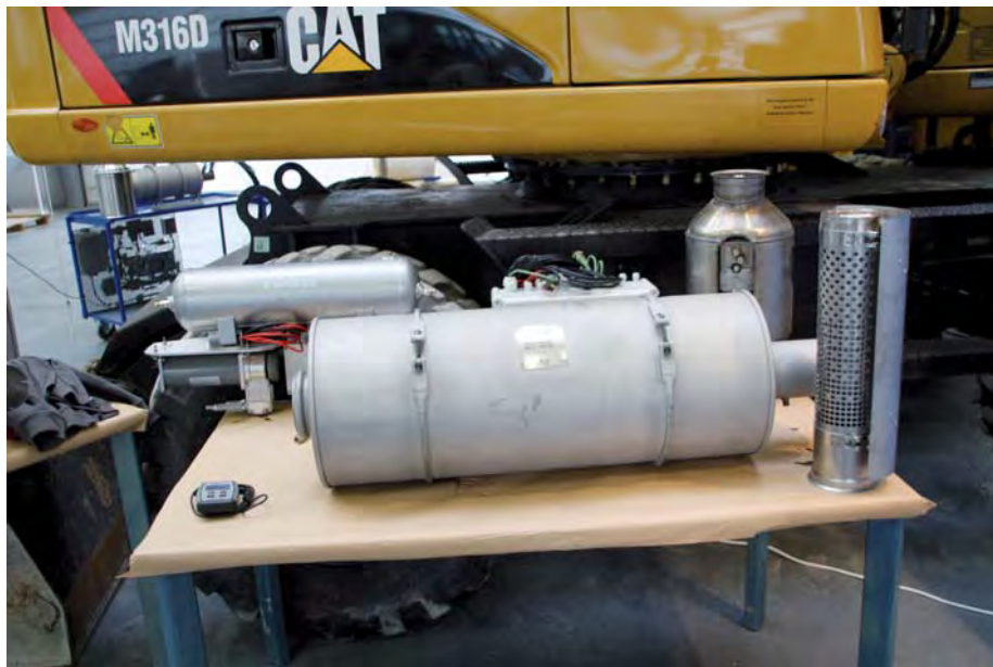
Filter-Nachrüstsysteme wie hier beispielsweise von Caterpillar könnten für ältere Maschinen bald flächendeckend zur Pflicht werden. (Foto: Zeppelin)
