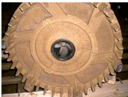
Die Unterseite des Tauchbelüfters zeigt erheblichen Eisenbesatz, der allerdings technisch ohne Relevanz ist.
