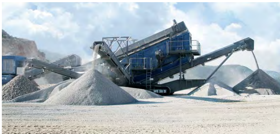
Das Modell Mobiscreen MS 20 D verfügt über drei Siebdecks mit jeweils 12,3 m² Siebfläche. (Foto: Kleemann)
