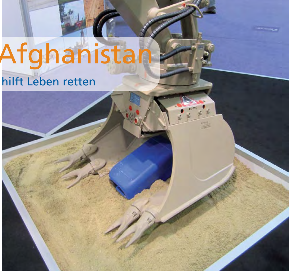
Der Greiflöffel kann sowohl Erdarbeiten als auch Greif- und Sortieraufgaben lösen. (Fotos: Burde)
