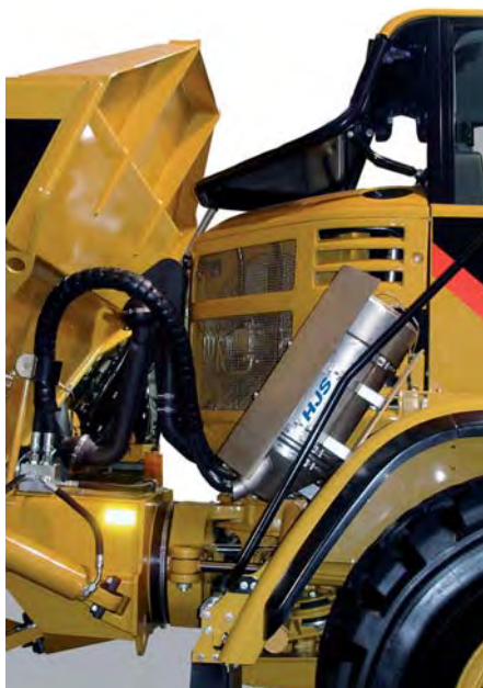
Das SMF-Abgassystem (Sintermetallfilter) von HJS, hier eingebaut in einem Cat-Dumper. (Foto: HJS)
