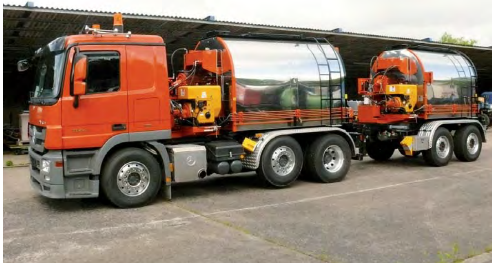
Zwei Hatz Motoren treiben das Rührwerk dieses Gussasphalt-Transportkochers an. (Foto: Hatz)
