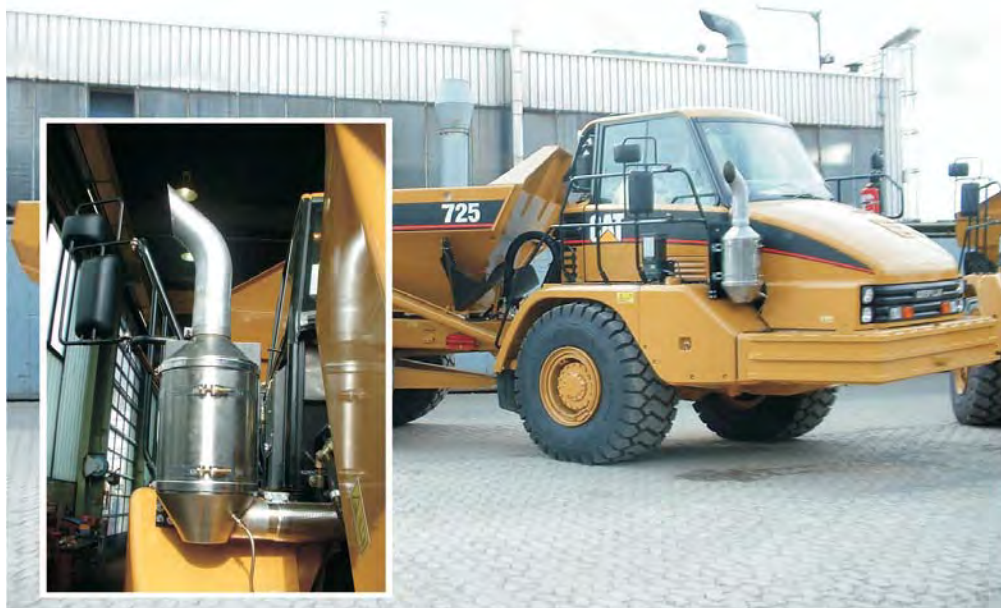
Dieselfilter wie sie typischerweise in Baumaschinen zum Einsatz kommen, hier bei einem Cat-Dumper. (Fotos: Puritech)
