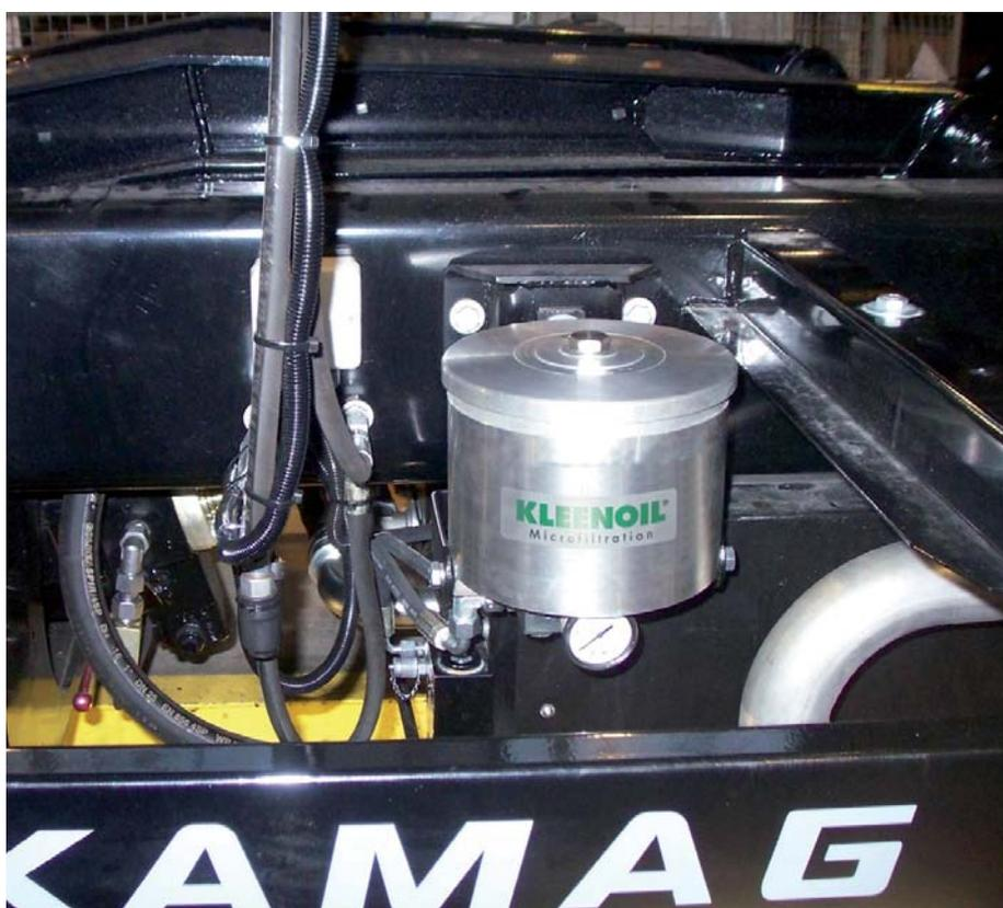
**Nebenstromfiltration** in Verbindung mit einer ständigen Überwachung des Öls sorgt für Sicherheit. (Fotos: Kleen-oil)
