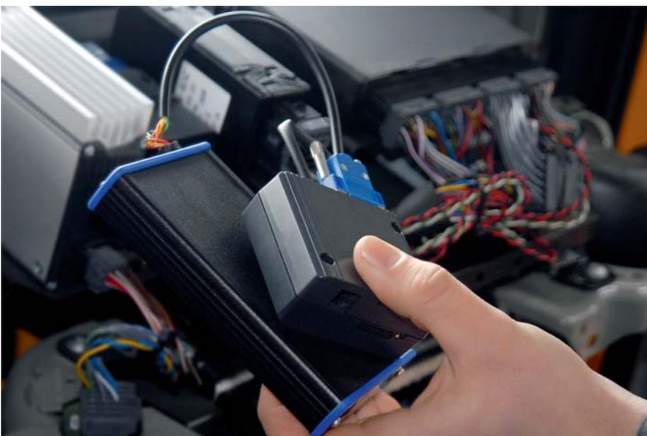
**MD log** ist ein herstellerübergreifendes System zur Analyse von Fahrzeugdaten. (Fotos: Modern Drive)
