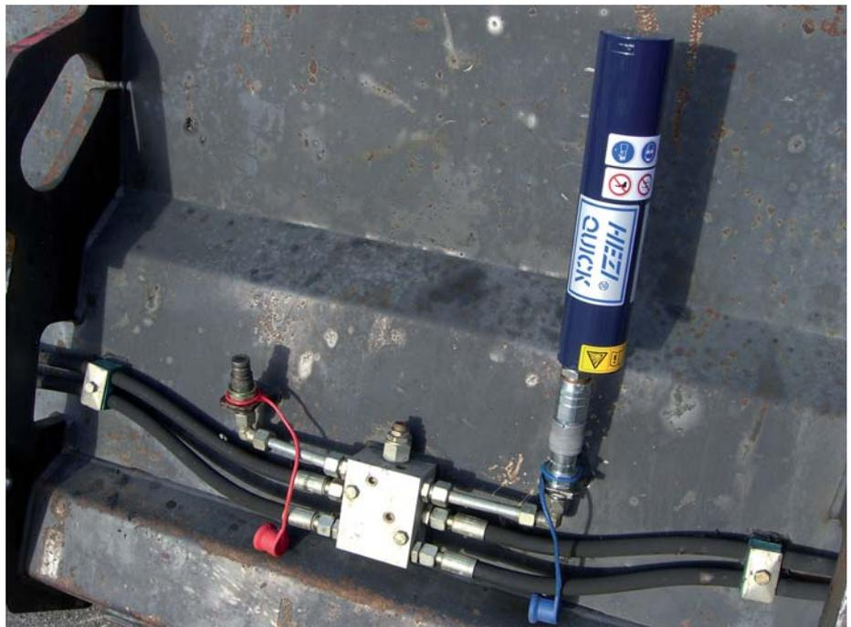
**Der Druckentlastungszyylinder** erlaubt die sichere, fast drucklose Entladung und Speicherung von sich ausdehnendem Öl. (Fotos: Hezi Shop)
