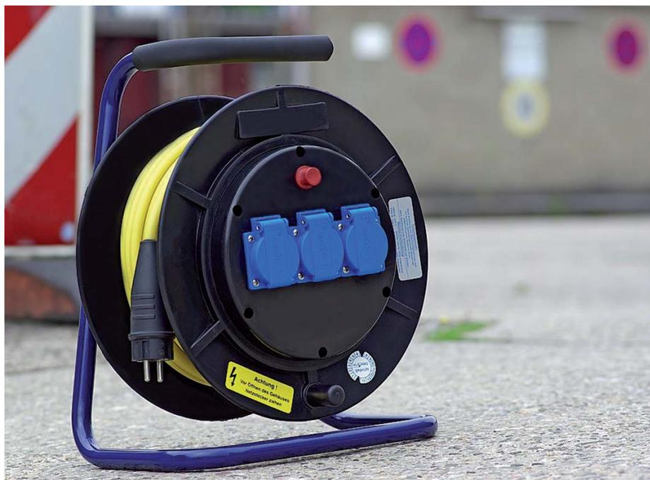
Leitungsroller müssen die Anforderungen nach Prüfgrundsatz GS-ET-35 erfüllen.
