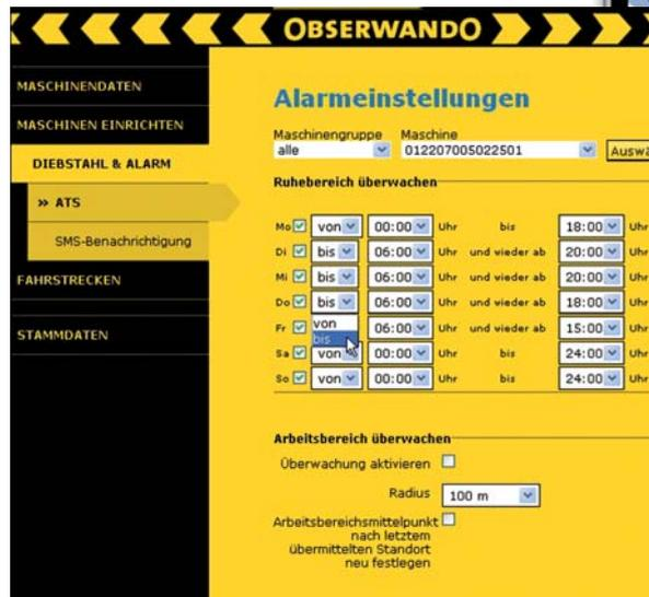
Diebstahlüberwachung per Telematik auch bei längeren Ruhezeiten. (Fotos: Rösler)
