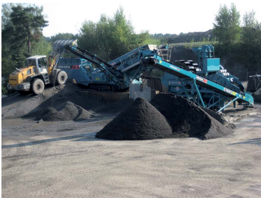
Die raupenmobile Turbo Chieftain 1400 von Powerscreen wäscht und klassiert das Aufgabematerial, hier mit Waschsieb. (Foto: Powerscreen)
