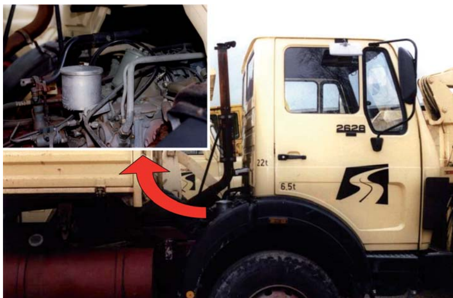
Ein Schleith-Lkw mit montiertem Nebenstromfilter aus dem Jahre 1988. (Fotos: Kleenoil Panolin)
