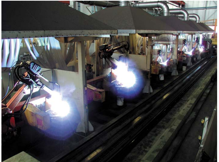
Auf zwei robotergesteuerten Linien erfolgt bei Berco das Schweißen der Leitradkörper.
