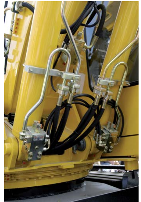
Hydraulikschlauchleitungen bilden die Adern von Maschinen und Anlagen, denn sie sorgen für die Energieübertragung.
