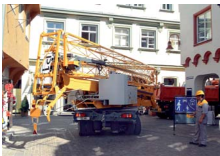
Manövrieren in engen Gassen? – Mit dem gelenkten Unterwagen kein Problem. (Fotos: Liebherr)
