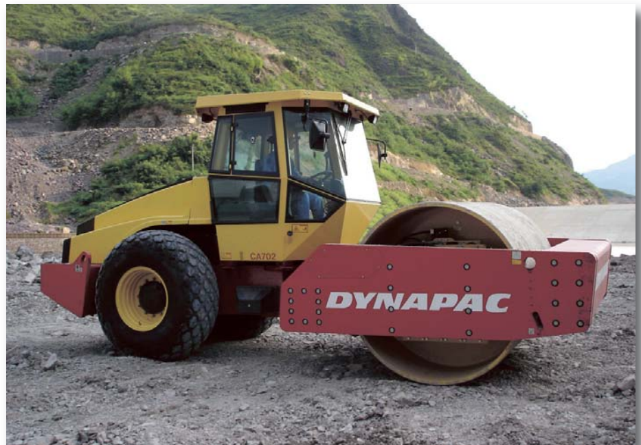
Die CA702D ist ein 27-t-Walzenzug für Hochleistungsanwendungen, wie hier abgebildet bei einem Staudammprojekt in China. (Fotos: Dynapac)
