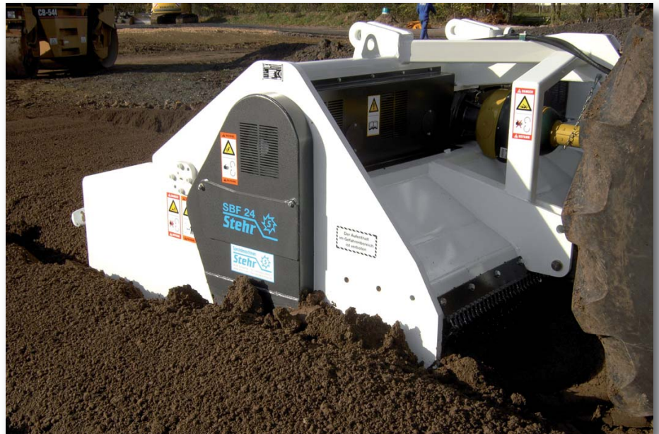
Alternative: Die Anbau-Bodenstabilisierungsfräse SBF 24 L bereitet den Boden im mix-in-place-Verfahren auf und bringt ihn vor Ort wieder ein.
