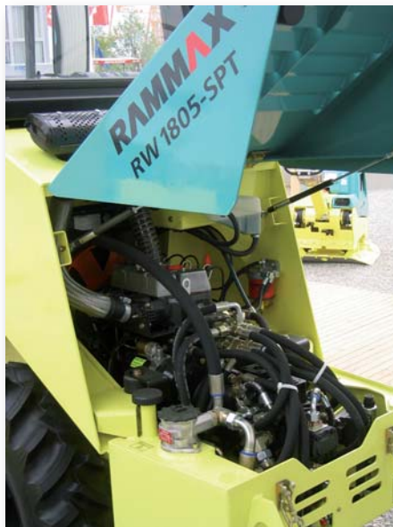
Die Grabenwalze RW 1805-SPT der Rammax-Produktlinie bietet viel Power – geliefert vom 27,6 kW starken wassergekühlten CHD plus LDW 1603 Lombardini Dieselmotor.
