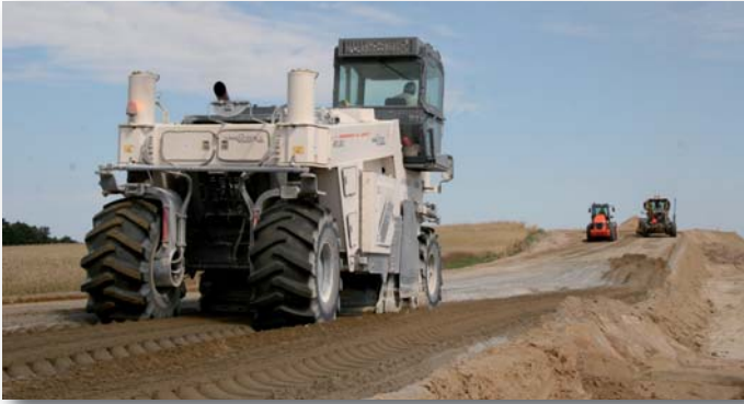
Die einzeln aufgehängten Räder des WR 2500 S sind unabhängig voneinander in der Höhe verstellbar. Die Maschine kann jederzeit parallel zum Boden oder mit Neigung stabilisieren. (Fotos: Wirtgen)
