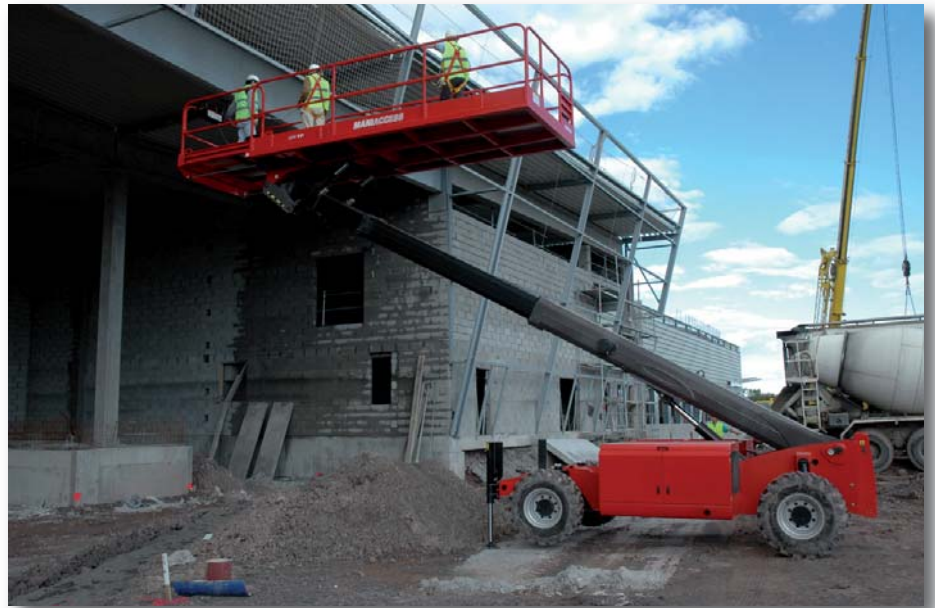
Die neue Maniaccess 150 TP hat einen deutlich vergrößerten Arbeitsbereich bei geringem Platzbedarf als vergleichbare andere Modelle. (Foto: Manitou)
