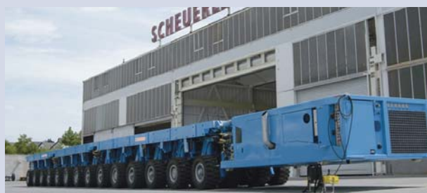
Modultransporter können miteinander gekoppelt werden und Lasten von 10.000 t transportieren. (Foto: Scheuerle)
