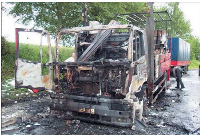
Lkw-Brandschaden: Die Ladungssicherung war auch nach brandbedingter Notbremsung in Ordnung. (Fotos: André Konstantin Hidde)
