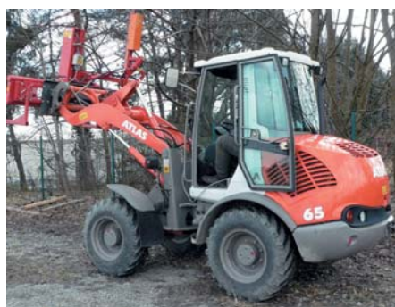
Der neue Geräteträger Atlas AGT 65 während der Testphase der High-Flow-Hydraulik, hier mit Baumschneide-Anbauwerkzeug.
