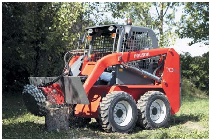
Ausgestattet mit einer Baumstumpffräse leistet der Kompaktlader von Neuson ganze Arbeit. Innerhalb kurzer Zeit ist der Baumstumpf beseitigt und die Arbeit erledigt.
