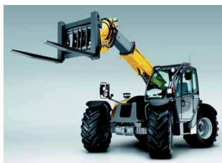
Stand sicher und ohne zu kippen schafft der Teleskop 4009 problemlos eine Stapelhöhe von 9 m bei maximaler Last von 3 t. (Foto: Kramer)
