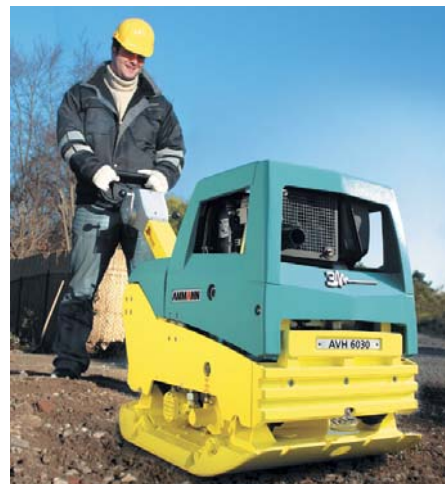
Die AVH 6030 mit ihrer Servolenkung ist mit Abstand die am meisten verkaufte Platte mit der 3-Wellen-Technik.
