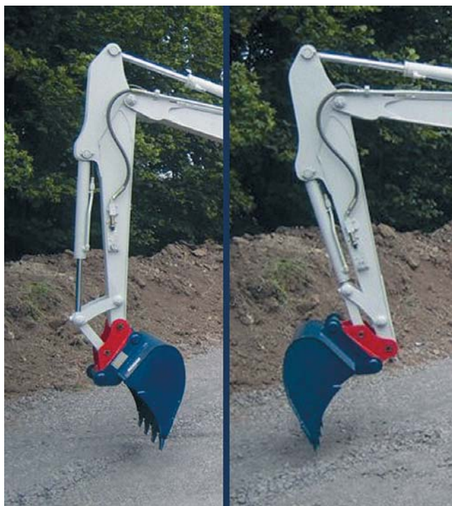
Der Symlockadapter ermöglicht das Drehen des Löffels bei gleich bleibender Ausrichtung des Baggerstiels. (Foto: Lehnhoff)
