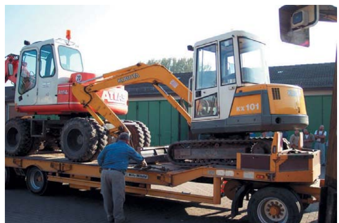
Richtiges Sichern von Baumaschinen auf Tiefladern, Pritschen oder Anhängern: Zurrgurte müssen meist durch Spannseile und Spannketten ersetzt werden.
