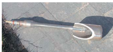
Tracto-Technik hat den neuen Überbohrkopf, hier im Bild, patentieren lassen.
