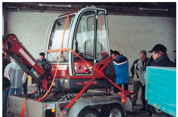
Schulungsschwerpunkt: Verzurren von Minibaggern auf Anhängern. Hier ist der Anhänger in der Nutzlast unterdimensioniert und nicht geeignet.
