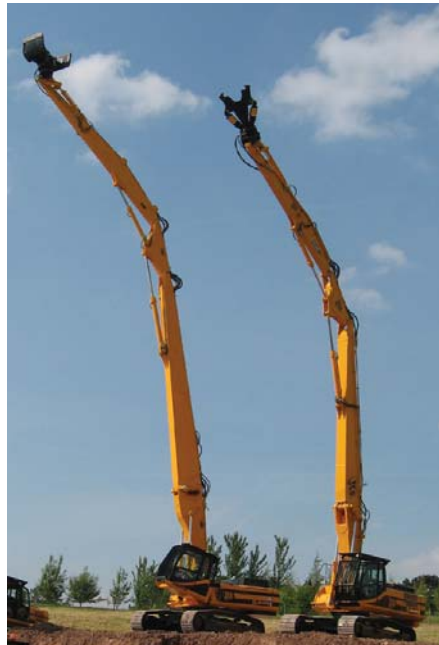
Überzeugten im Abbruch: Der JS 460 (l.) mit zweiteiligem Ausleger und der JS 330 HRD mit dem von JCB entwickelten modularen, dreiteiligen Abbruchausleger. (Foto: JCB)
