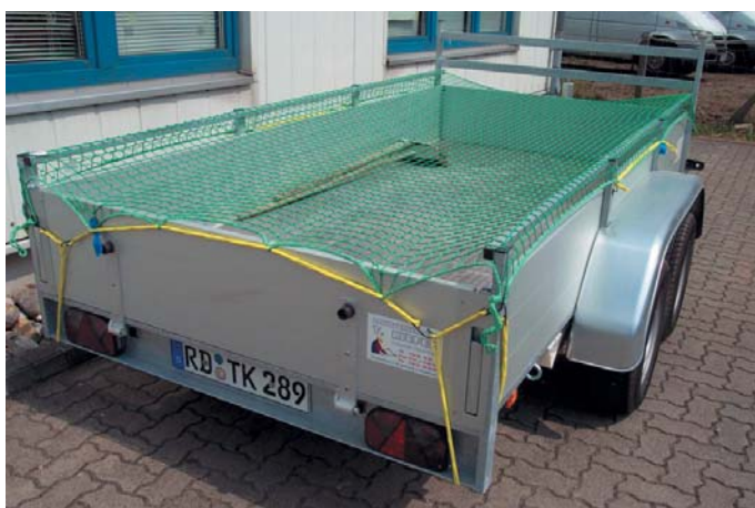
Netze sind eine günstige Lösung zur Sicherung und sollten in Kombination mit Formschluss und Spanngurten eingesetzt werden.
