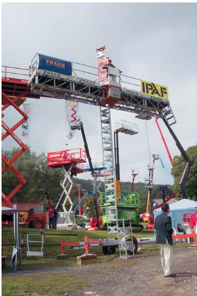
Die Mastkletterbühne macht sich beim Transport ganz klein und kann dennoch hoch hinaus. (Foto: Fraco)
