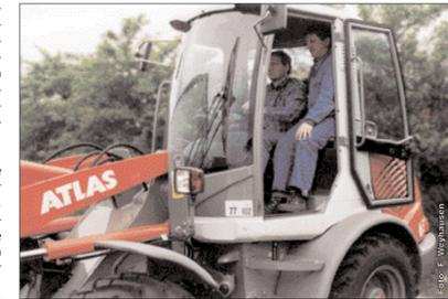
Kabinengröße und Notsitzfläche lassen die Mitnahme eines Beifahrers zu.
