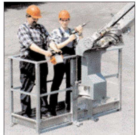
Bild 18: Durch Anbau einer Arbeitsbühne wird der leichte Autokran rasch zur fahrbaren Hubarbeitsbühne (Boecker).
