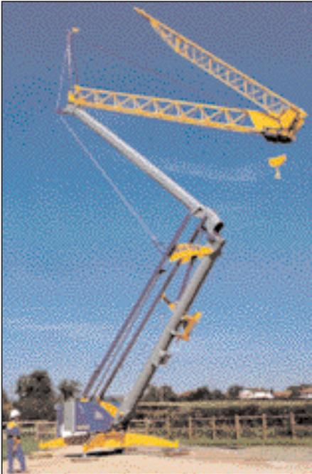
Bild 5: Rasche Montage eines Unterdrehers mit Katzausleger mit Hilfe mehrerer Hydraulikzylinder (Potain).
