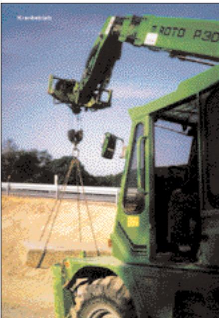
Bild 14: Teleskopmaschine mit angebauter Winde transportiert Betonplatten in unwegsamem Gelände (Merlot).
