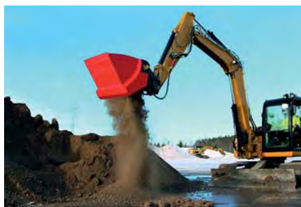
Die Allu-Schaukelseparatoren verarbeiten Abfallboden zum Baustoff Boden. (Foto: Allu)
