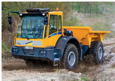
Der Bergmann-Dumper 3012 mit 12 t Nutzlast vereint Geländegängigkeit und Straßentauglichkeit. (Foto: Bergmann)
