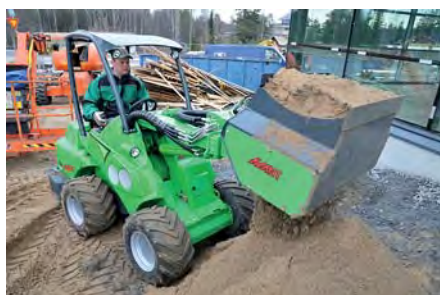
Die Siebschaufel mit 1.100 mm Arbeitsbreite und einem Volumen von 180 l siebt und sortiert größere und kleinere Partikel 0-22 mm, ohne diese zu zerkleinern.
