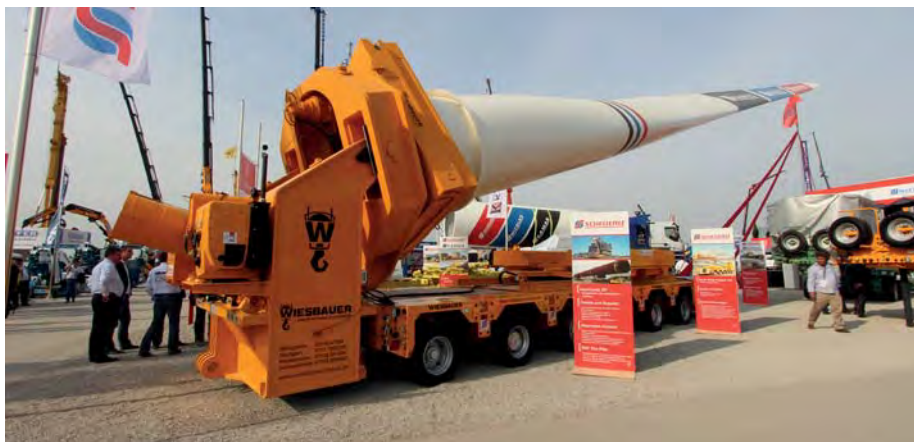
Der Hatz SilentPACK 2L41C Dieselmotor bewegt den Scheuerle Rotorblattadapter bis zu 60° vertikal und bis zu +/-110° um die eigene Achse und hilft so, schwierige Hürden beim Transport der oftmals über 50 m langen Rotorblätter zu überwinden. (Foto: Hatz)
