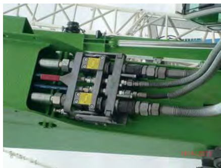
Die Pister-Multikupplensysteme PMK können bei allen Baumaschinen jeder Größe zum Einsatz kommen und bestechen durch das extrem flache Design. (Foto: Hain)
