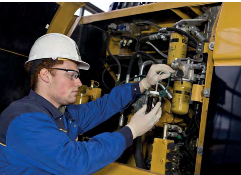
Ein weiterer Baustein des Condition Monitorings ist die Diagnose von Öl und Kühlmittel von Baumaschinen.
