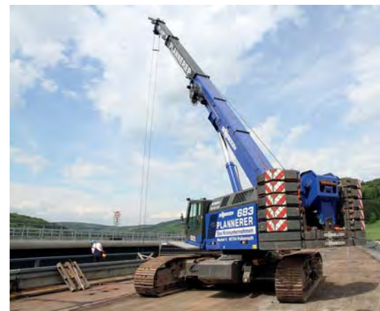
Der Fahrer kann die Maschine mittels externer Funkfernbedienung steuern und hat so die schwere Last stets sicher im Blick. (Fotos: Sennebogen)
