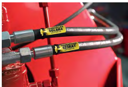
Hydraulik-Schlauchleitungen mit X-Code.
