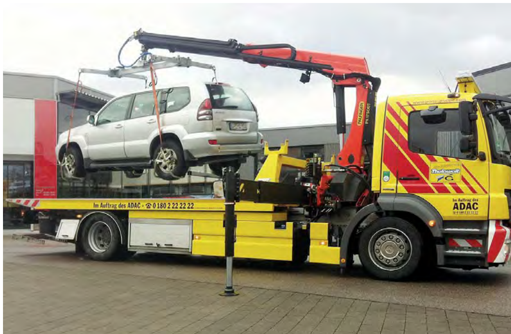
Der neue Abschleppkran PK 17500 T besticht durch sein sehr gutes Eigengewicht-Hubkraft-Verhältnis. Die KTL-Beschichtung und die wartungsfreien Schubarme stehen für Langlebigkeit und einen hohen Wiederverkaufswert. (Fotos: Palfinger)
