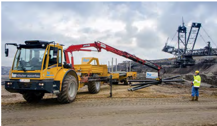
Der Dumper-eigene ferngesteuerte Ladekran ermöglicht das geländeunabhängige Be- und Entladen. (Foto: Bergmann)
