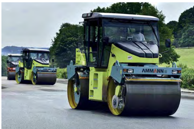
Die schweren Tandemwalzen Ammann AV95-ACE mit starrem Rahmen und geteilten Bandagen bringen eine optimale Verdichtungsenergie auf Asphalt auch in engen Kurven. (Foto: Ammann)
