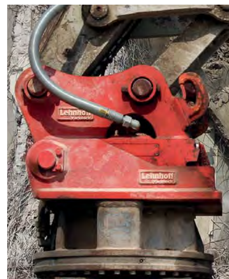
Die Schnellwechsler Variolock VL 400 bis VL 1000 von Lehnhoff wurden für Heavy-Duty-Einsätze geschaffen. (Fotos: Lehnhoff)
