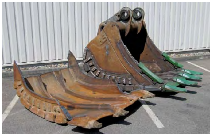
Repariert, geschärft und aufgepanzert gehen regenerierte und mit Esco-Zähnen bissstark ausgestattete Löffel zurück in die Praxis. (Fotos: HS-Schoch)
