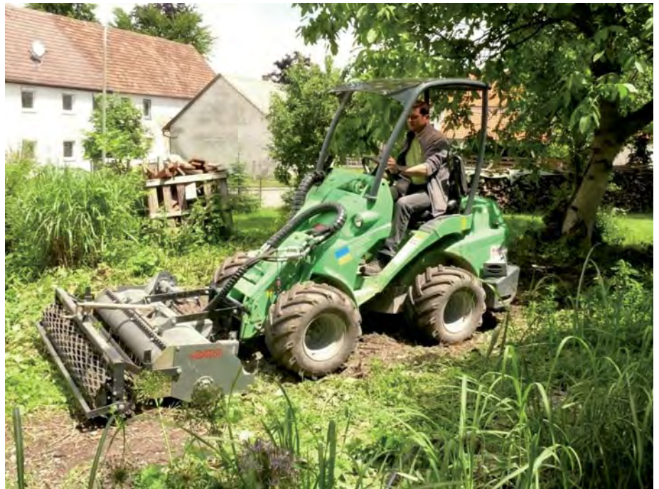
Die Umkehrfräse ist ein wichtiges Anbaugerät und wird oft mit dem Avant-Modell 630 genutzt. (Foto: Avant)
