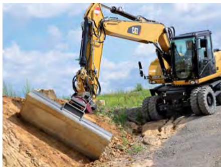
Mit dem RotoTop können Böschungen in jedem Winkel abgezogen werden. (Foto: Holp)
