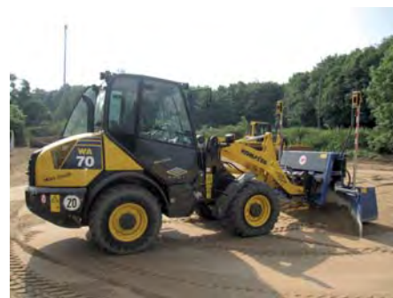
Die Radlader-Planiereinrichtung „Bullblaster“ ist mit modernster Topcon-3D-LPS sowie mit GPS-Steuerungstechnologie ausgestattet. (Foto: Wansor)
