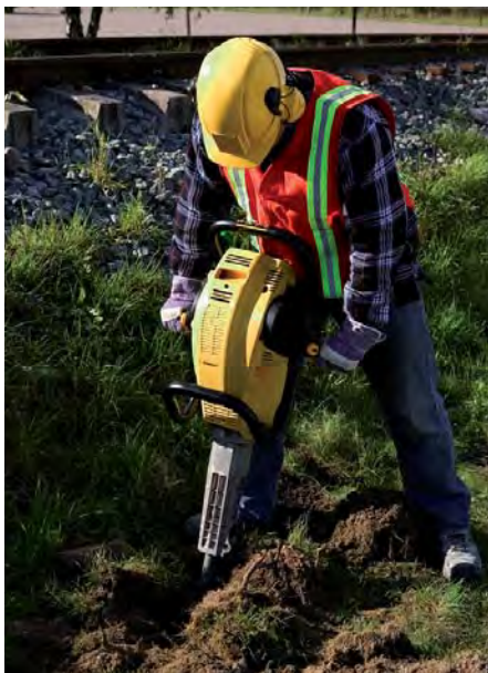
Benzinbetriebene Aufbrechhämmer wie der Cobra TT brechen Beton auf und treiben Pfähle z. B. für Zäune ein. (Foto: Atlas Copco)
