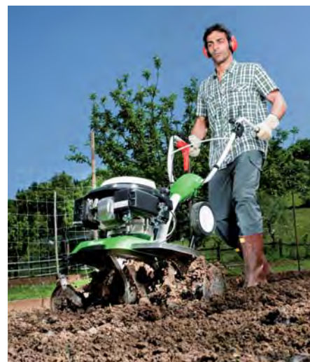
Die neue Motorhacke Viking HB 685 erbringt mit einem 2,9 kW starken Motor mehr Leistung für die Bodenkultivierung. (Foto: Viking)
