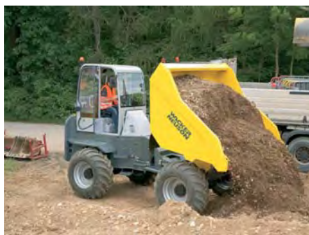
Raddumper wie der 10001 CAB von Wacker Neuson sind eine geländegängige Alternative zu kleinen Lkws. (Foto: Wacker Neuson)
