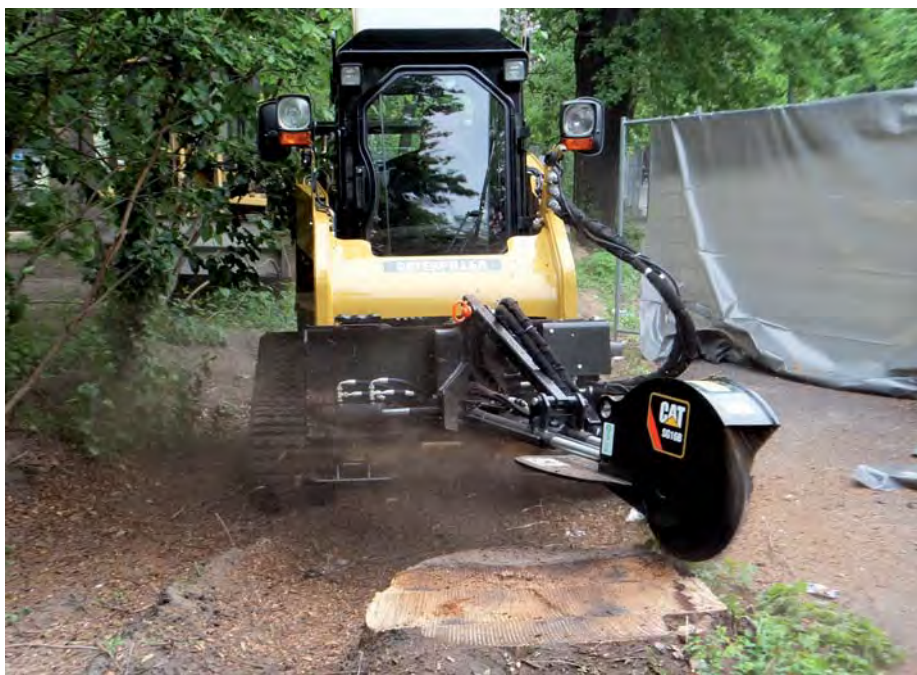
Die Kompaktmaschine wurde u.a. mit einer Baumstumpffräse, Gabelzinken, einer Klappschaufel, einem Kehrbesen und einem Hammer ausgestattet. (Foto: Otto Kittel)
