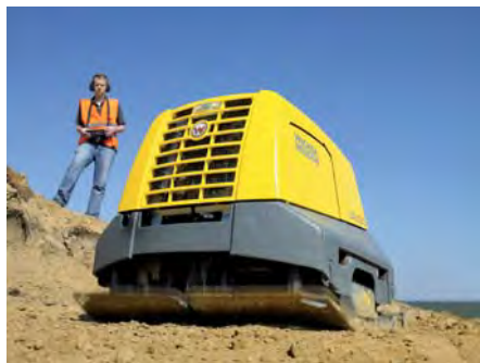
Die ferngesteuerte Verdichtungsplatte DPU 130 hat sich auf vielen Baustellen als zuverlässige Maschine bewährt. (Foto: Wacker Neuson)
