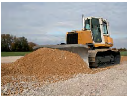
Die Planierraupe PR 714 Litronic ist äußerst manövrierfähig und eignet sich besonders gut für Arbeiten auf engstem Raum. (Foto: Liebherr)
