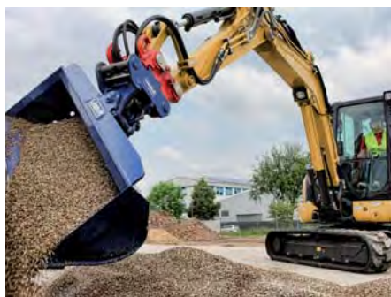
Mit vollhydraulischem Variolock-Schnellwechsler, Symlock-Adapter und Schwenklöffel lässt sich wendig und flexibel graben und verfüllen. (Foto: Lehnhoff)
