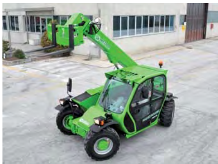
Der neue kompakte Teleskopstapler Merlo P 25.6 L ist mit seiner Höhe von 1,77 m besonders niedrig. (Foto: Merlo)
