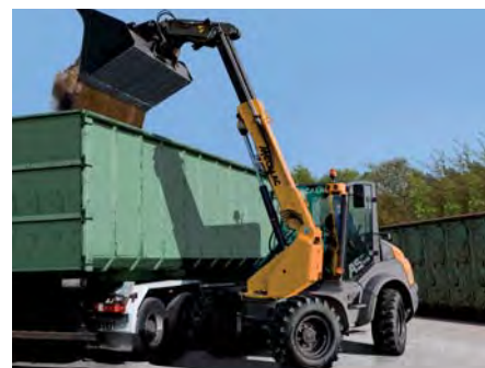
Der Mecalac AS 900tele ist für Arbeiten mit Hubhöhen von bis zu 4,72 m geeignet – ideal für das Befüllen hochwandiger Lkws. (Foto: Mecalac)
