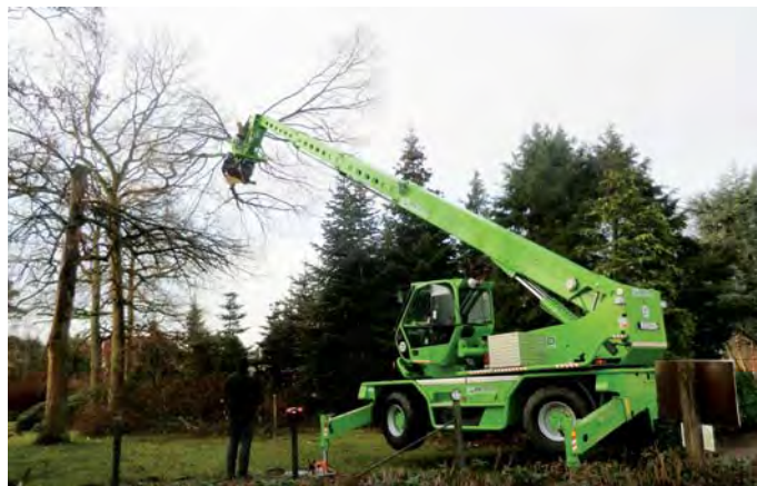
Bäume fällen oder auskronen ist mit der hydraulischen Greifsäge am Roto-Ausleger keine schweißtreibende Arbeit mehr.
