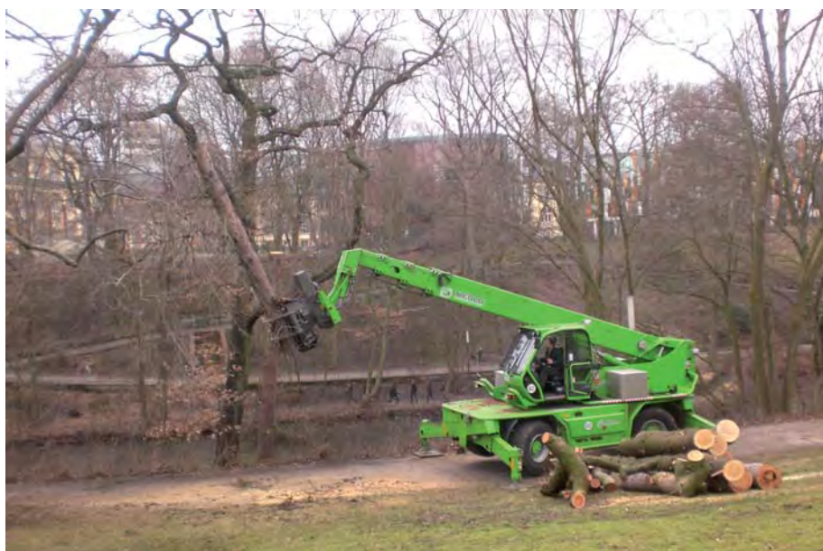
Für den Fäll-Teleskopen Roto 60.24 MCSS sind 3 t Resttragkraft am 24 m langen ausgefahrenen Teleskoparm kein Problem.
