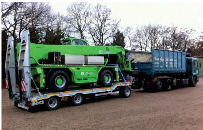
Bei weit entfernten Arbeitseinsätzen wird der Teleskopstapler einfach per Tieflader transportiert. (Fotos: Merlo)
