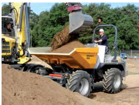
Mit einer 6-t-Nutzlast ist der Bergmann-Dumper 2060 in der Ausführung als Rundkipper ein flexibles Transportgerät. (Foto: Bergmann)
