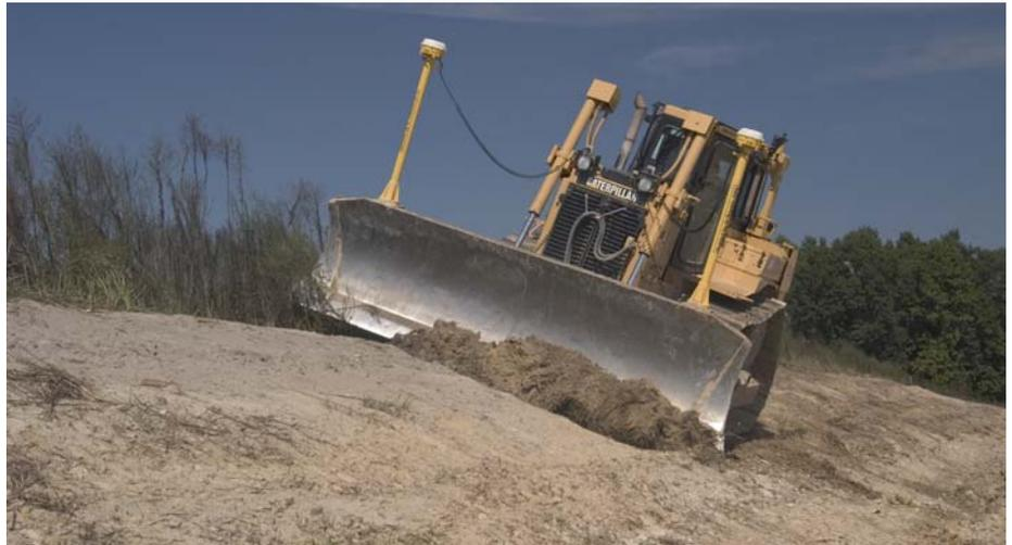
**Maschinenführer erhalten** dank der Version 10.8 des GCS900 Maschinensteuerungssystem exakte Daten um z.B. mit einer Planierraupe eine Feinplanie zu erstellen. (Foto: Trimble)
