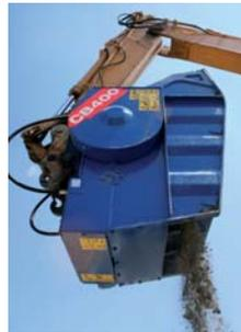
*Der CB 400 ist schnell einsatzbereit und bereitet Abbruchmassen direkt am Entstehungsort auf. (Foto: LST)*
