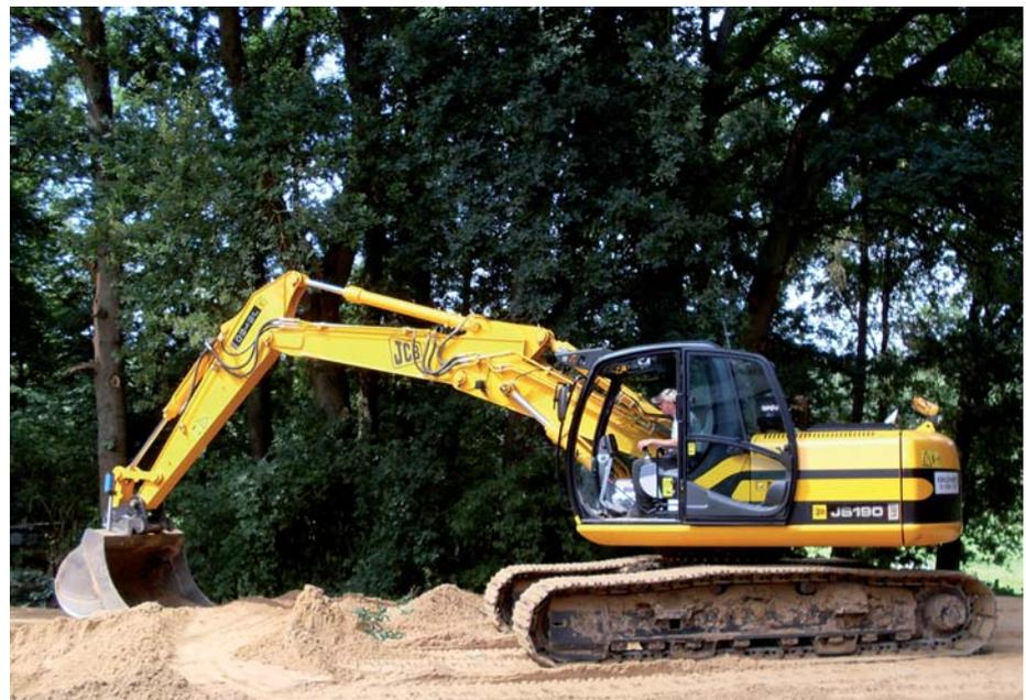
**Die Kombination** aus dem Oberwagen des 20-t-Baggers JS 190 mit dem Unterswagen des 22-Tonnners JS 210 garantiert optimale Standfestigkeit und außergewöhnlich geringen Bodendruck. (Foto: JCB)
