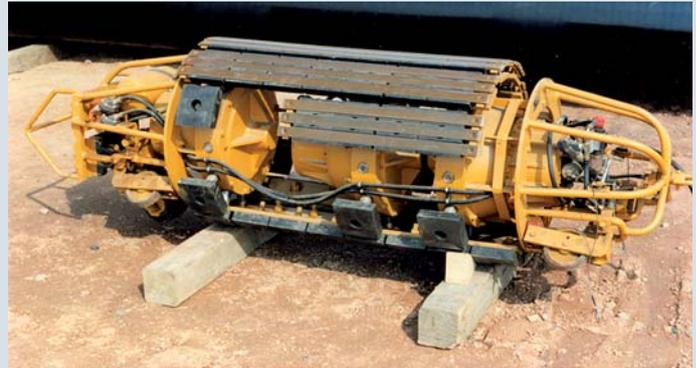
**Bei dieser Rohrbiegemaschine** ist gut zu erkennen, dass sie das schon isolierte Rohr sehr präzise in den gewünschten Winkel bringt, ohne die Außenisolierung zu beschädigen.
