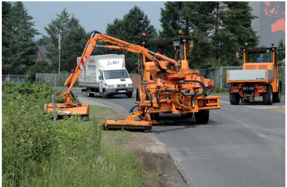
**Der Geräteträger GT 3006** ist durch seine Anbaumöglichkeiten vorn, seitlich und hinten mit vielen unterschiedlichen Arbeitsgeräten äußerst flexibel einsetzbar, hier z. B. bei Straßen-Mäharbeiten. (Foto: Bergmann)
