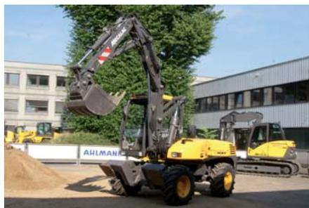
**An den Mobilbagger 12MXT** können verschiedene Werkzeuge wie Greifer, Schwenklöffel, Mäh- und Mulchgeräte montiert werden.
