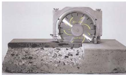
**So funktioniert's:** Die Technologie ist eine Kombination von Soff-Cut-Diamant-Trennscheiben in Verbindung mit einer so genannten Skid Plate. Die Drehung der Trennscheibe gegen den Uhrzeigersinn in Kombination mit der Skid Plate übt einen Druck auf die Betonoberfläche auf, um Ausbrüche an der Fugenkante zu verhindern. (Fotos: Husqvarna)
