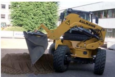
**Der AS 90** mit einem Schaufelvolumen von 0,9 – 1,4 m<sup>3</sup> ist der meistverkaufte Schwenklader aus dem Hause Ahlmann. (Fotos: VDBUM)
