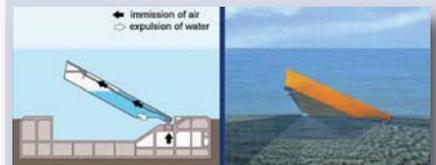
Wenn jedoch das Hochwasser 110 cm über Normalnull erreicht, wird mittels Pressluft das Wasser aus den Tanks gedrückt.
