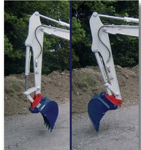
Mit dem Symlock-Adapter lässt sich der Löffel um 180° drehen und ein Tieflöffel eignet sich auch für einen Hochlöffeleinsatz.
