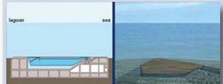
Bei normalem Wasserstand liegen die Bollwerke mit Wasser gefüllt unsichtbar am Meeresboden.
