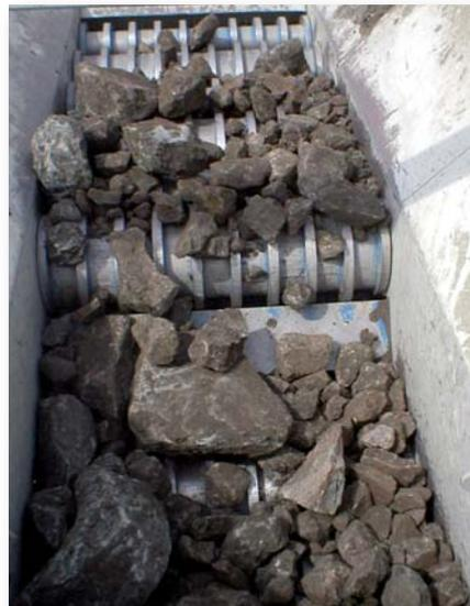
Direkt beschickter Primärrollenrost 4.000 x 1.200 mm mit einer Spaltweite von 80 mm.
