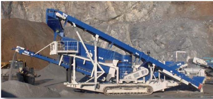
Die Nachbrechanlage Mobicon MCO 11 S, hier im Bild, hat einen Stundenumsatz von bis zu 250 t.
