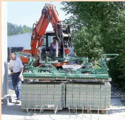
Die P02 twin nimmt gleich zwei Stein-Reihen auf und verlegt sie. Das spart Zeit und vor allem Geld, denn sie erzielt die doppelte Verlegeleistung als vergleichbare Maschinenvarianten. (Foto: Hunklinger)
