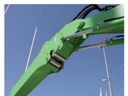
*Die Aufnahme des Geräts erfolgt per Haken und wird völlig automatisch arretiert und angekuppelt. (Fotos: Sennebogen)*
