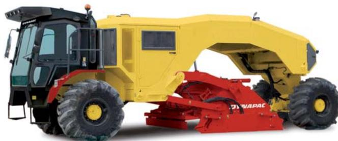
*Der neue Dynapac Bodenstabilisierer DS400 ist ausgelegt für Frästiefen von bis zu 53 cm und kann mit unterschiedlicher Rotorbestückung an alle denkbaren Bedingungen angepasst werden. (Foto: Dynapac)*
