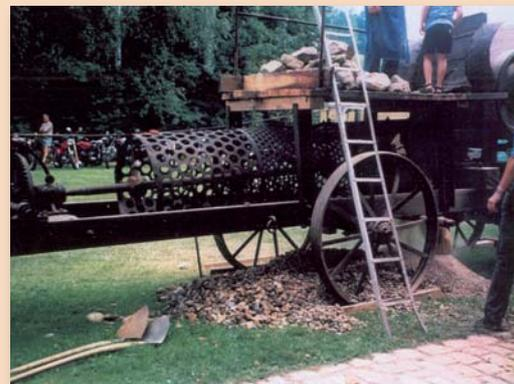
So fing alles an: Steinbrecher der Marke „Rockstroh“ aus dem Jahre 1904. Das radmobile Gerät bringt ein Einsatzgewicht von sechs Tonnen auf die Waage. Wie vor fast 100 Jahren Material abgeseibt wurde, zeigt das rechte Bild. (Fotos: privat)
