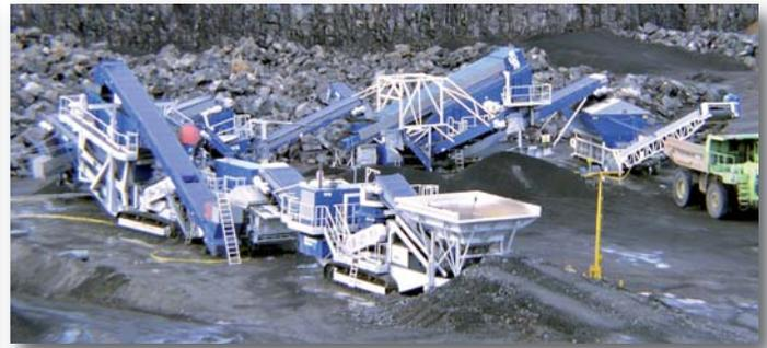
Mobile Brech- und Siebanlage mit drei Brechstufen, ein Backenbrecher und zwei Kegelbrecher, sowie zwei Siebanlagen zur Herstellung von Asphaltkörnungen aus Basalt 0/4, 4/6, 6/10, 10/14 und 14/20 mm.
