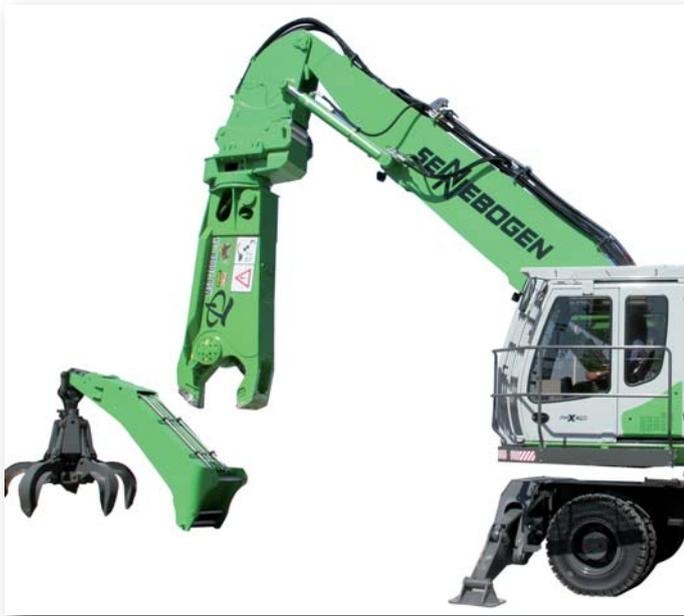
*Für den schnellen Wechsel von Greifer und Schere entwickelte Sennebogen ein Schnellwechselsystem für Materialumschlagmaschinen.*
