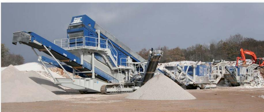
Mobile Brech- und Siebanlage mit zwei Brechstufen, ein Backenbrecher und ein Prallbrecher, sowie mit einer Siebanlage zur Herstellung von Betonkörnungen aus Jurakalkstein 0/4, 4/6, 6/10, 10/14 und 14/25 mm.
