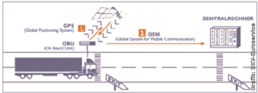
Bild 2: Automatisches Mauterfassungssystem.
