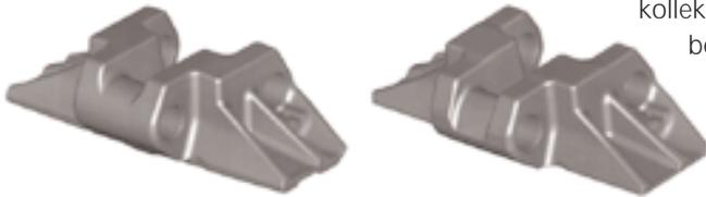
Bild 4: Modell des Kettensegmentes (links Ausgangsgeometrie, rechts 100 % verschlissen).
