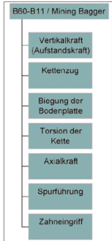
Bild 2: Lastfälle (bauformunabhängig).
