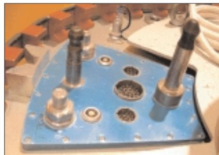
Andockplatte für die Kapselversorgung bei Experimenten in der Schwerelosigkeit.
