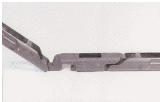
Das Gestänge wird zeitsparend eingeklinkt und nicht miteinander verschraubt (patentiert)
