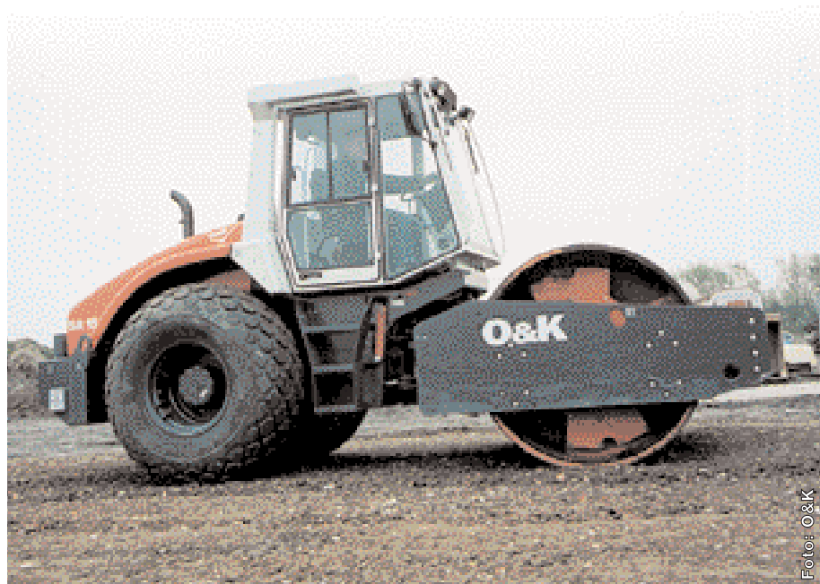
Der O&K-Walzenzug SR 15 S mit 14,4 t Dienstgewicht gestattet mit seinen gut abgestuften vier Fahrstufen, seiner einfachen Bedienung und der guten Übersichtlichkeit ein sehr schnelles Arbeiten
