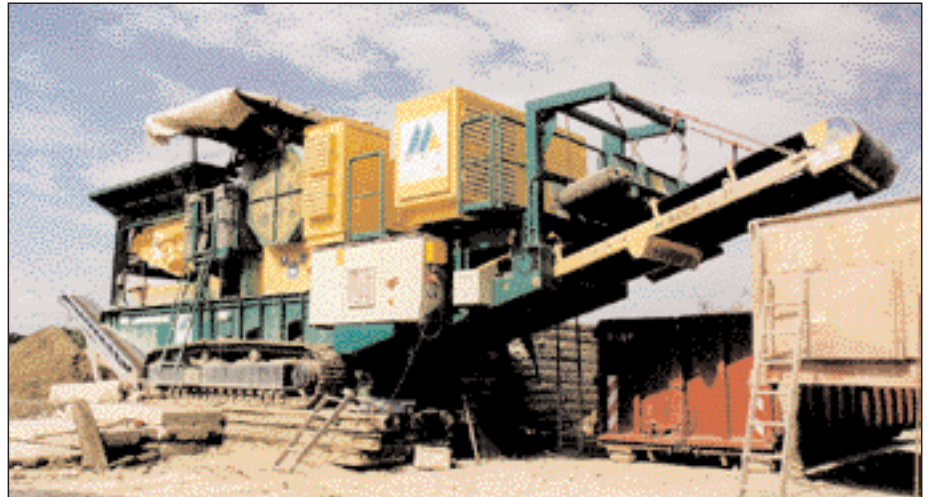
Raupenmobiler MFL-Einschwingen-Backenbrecher vom Typ STE 108-75/T für wirtschaftliches Baustoffrecycling
