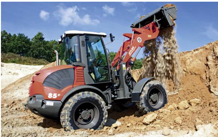
Im AR 85e kommt ein dieselhydraulisches Hybridsystem zum Einsatz. (Foto: Atlas Weyhausen)
