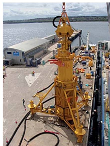
Mit Gezeiten-turbine-Monopfahl hat die Bauer-Gruppe gezeigt, dass gebohrte Monopfahlgründungen mit einem Unterwasserbohrgerät wirtschaftlich realisierbar sind. (Foto: Bauer)
