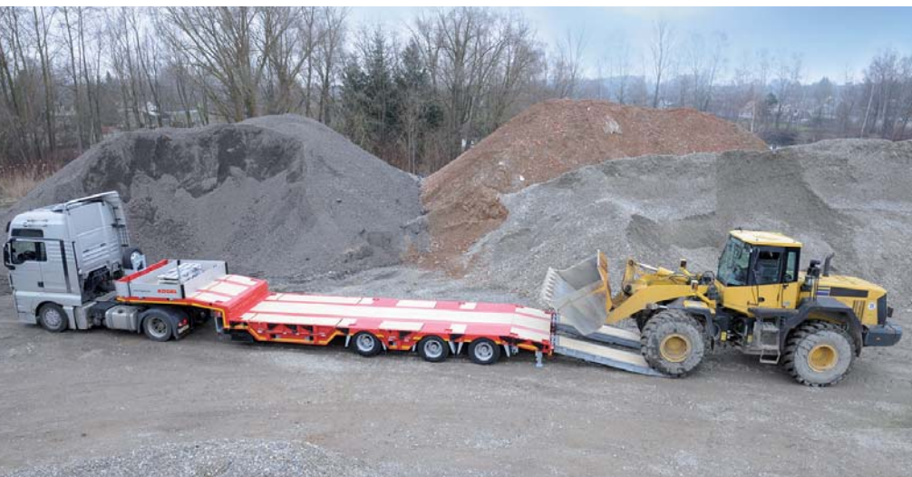
Der 3-Achs-Satteltieflader eignet sich insbesondere für den Transport schwerer Baumaschinen. (Foto: Kögel)
