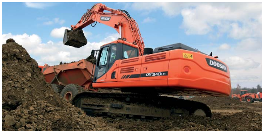
Elektronisch geregelt werden Hydraulik und Motorleistung besser aufeinander abgestimmt. (Foto: Doosan)
