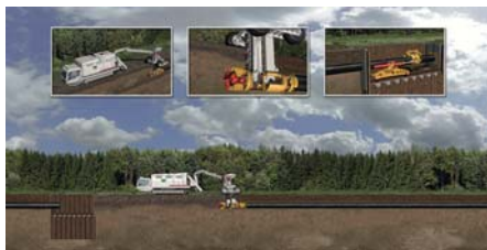
Pipe Express von Herrenknecht löst den Boden, der über eine mitgeführte Fräseinheit direkt zu Tage gefördert wird. Gleichzeitig wird die Pipeline unterirdisch verlegt. (Grafik: Herrenknecht)
