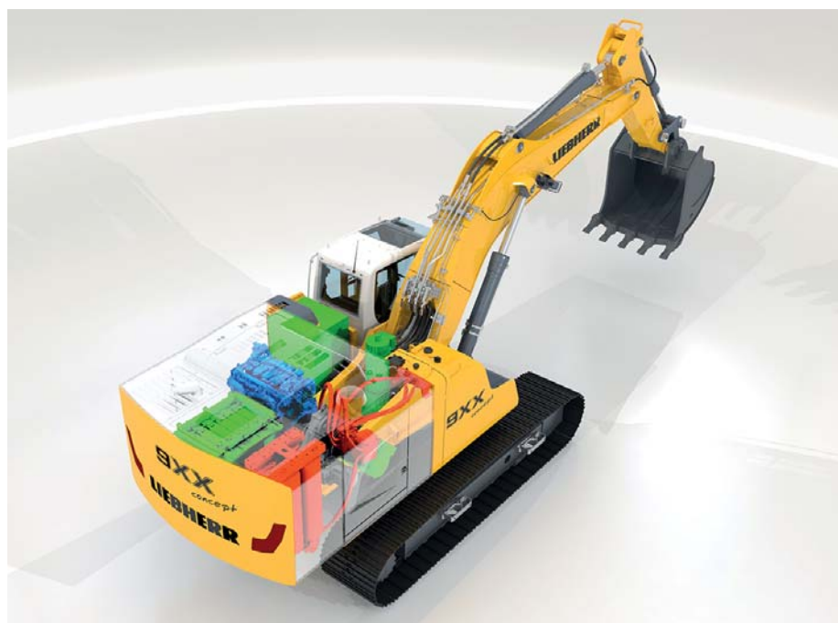
Konzeptstudie des R 9XX concept. Die Kombination von elektrischem und hydraulischem Antrieb erhöht die Leistung des Dieselmotors bis zum Zweifachen. (Grafik: Liebherr)
