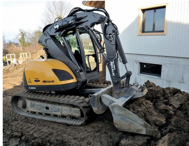
Dieser im GaLaBau beliebte Mecalac 8MCR vereint konventionellen Raupenbagger und Hochleistungs-Kompaktlader in einer 10 km/h schnellen Maschine. (Foto: Mecalac)
