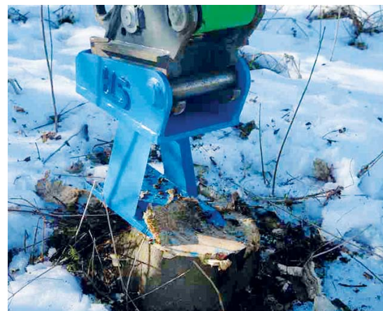
Mit dem Wurzel-König lassen sich Baumstümpfe und Wurzelstöcke ohne Einsatz von Fräsen roden. (Foto: HS-Schoch)
