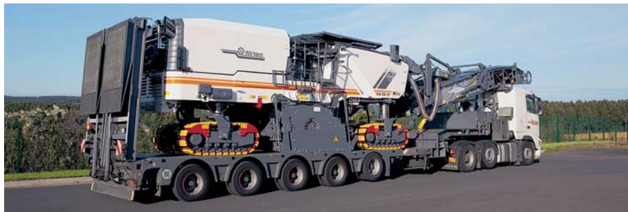
Mühsam: Der Transport von Großfräsen erfordert eine streckenbezogene Ausnahmegenehmigung. (Foto: Wirtgen)
