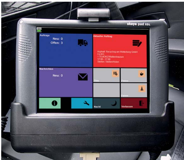
Der Tablet PC zeigt dem Fahrer den Tagesplan und kurzfristige Änderungen an, verbessert also die Disposition.
