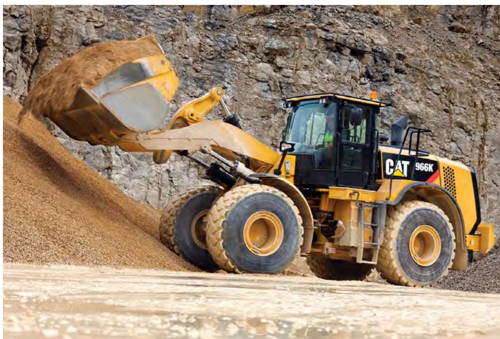
Noch sparsamer mit CVT-Getriebe: Der neue Cat Radlader 966K XE. (Foto: Caterpillar/Zeppelin)
