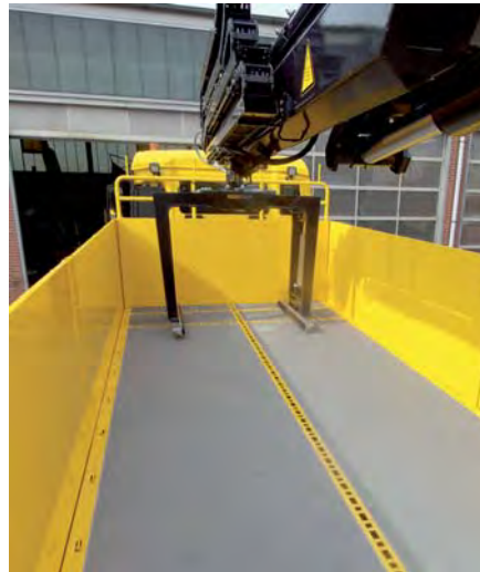
Foto 2: Pritschenboden mit höchster Rutschfestigkeit und integrierten Zurrmöglichkeiten.
