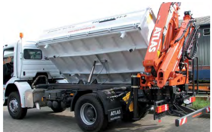
Foto 5: Unterbau eines Zweiseitenkippers mit belastungsgerecht angepassten Profilen.
