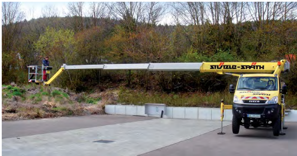
Selbst bei der außergewöhnlich hohen seitlichen Reichweite von 16,4 m bietet die Hubarbeitsbühne von Palfinger noch hohe Stabilität. (Foto: Palfinger)
