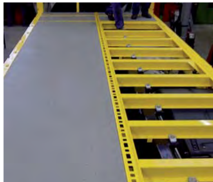
Foto 3: Unterbau einer geschraubten Pritsche in Leichtbauweise mit Z-Querträgern.
