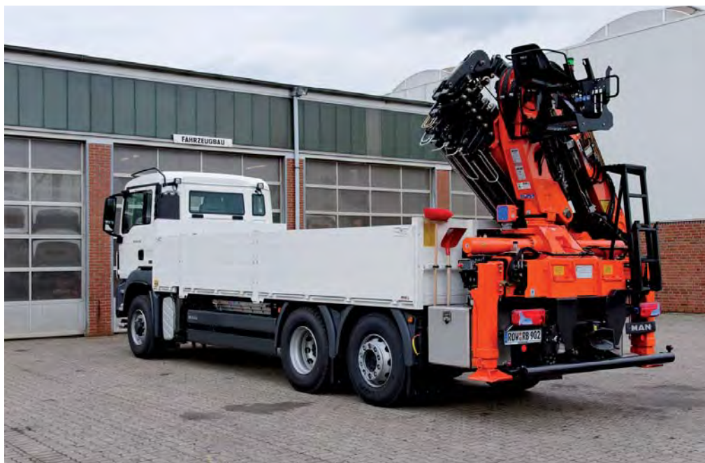
Foto 1: LKW mit Baustoffpritsche und Heckladekran für den Baustoff- und Baugerätetransport sowie Montagearbeiten. (Fotos: Atlas von der Wehl)
