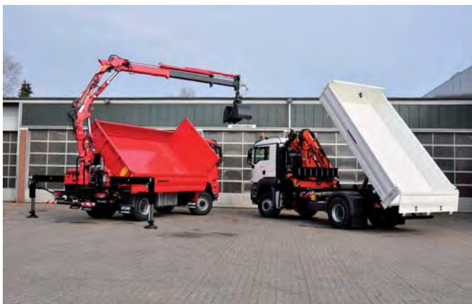
Foto 4: Zwei- und Dreiseitenkipper mit Heck- bzw. Frontkran. Transport von Bodenaushub und kleineren Geräten.
