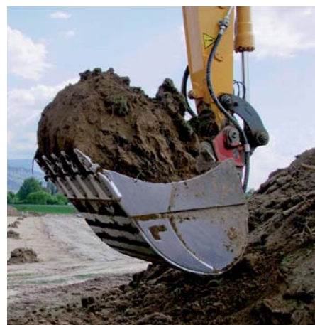
Viel Masse bewegen die Lehnhoff-Tiefloeffel durch ihre doppelt konische Form mit langem Boden und vorgezogener Schneide.
