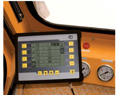
Bedieneinheit des Moba MDS-2000 zur Steuerung von Bohrgeräten. (Foto: Moba)
