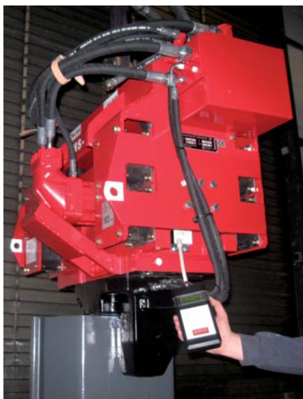
Vibrator MS-5 HFBV mit Datenlogger und Lesegerät.
