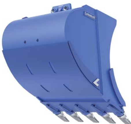
Der Sandwichboden der Lehnhoff GP-Universaltiefloeffel schützt zusätzlich vor Verschleiß und Schlageinwirkung. (Fotos: Lehnhoff)
