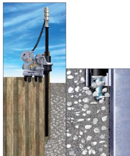
Bohr-Press-System Vorauseilendes Bohren unter Bohlenfuß.
