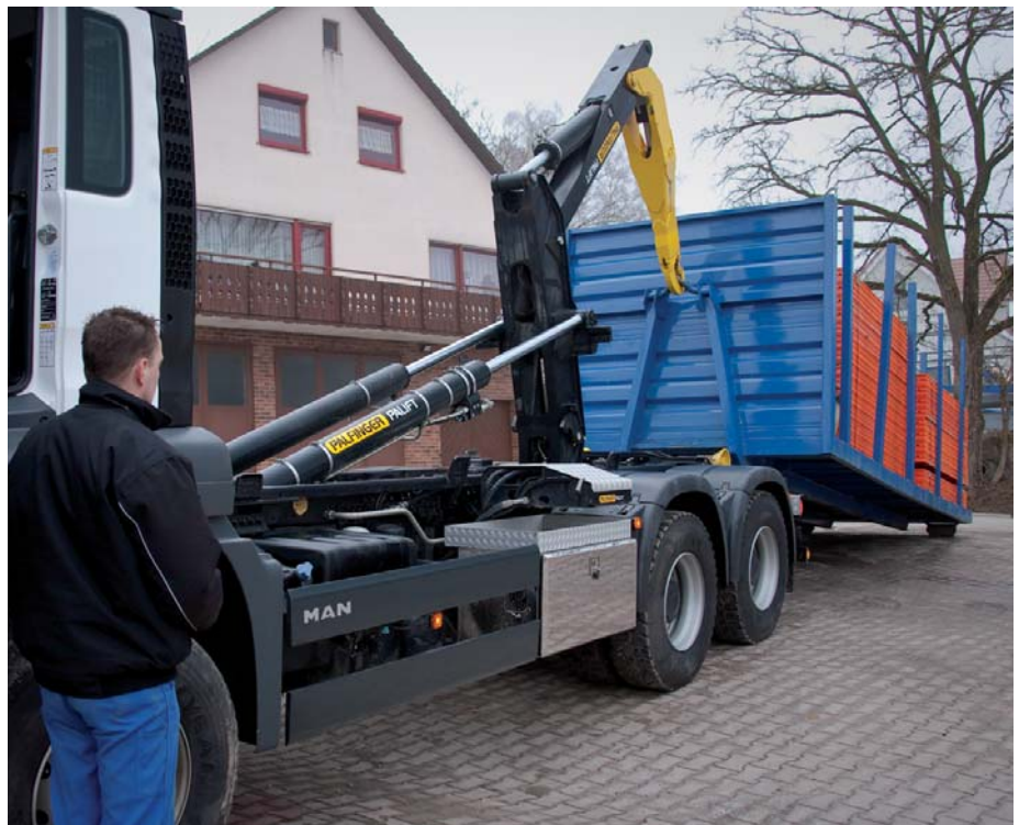
Aufnahme eines Rungencontainers mit Schalungen durch den Power Abrollkipper von Palfinger. (Foto: Palfinger)
