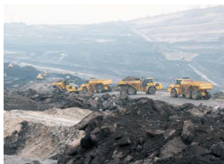
Förderkette: Im Wechsel fahren die E.ON-Dumper Kohle oder Abraum im Helmstedter Braunkohlerevier.
