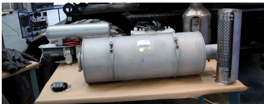
Ein Cat-Wechselfiltersystem zur schnellen Nachrüstung, hier für das Cat-Modell M316D.
