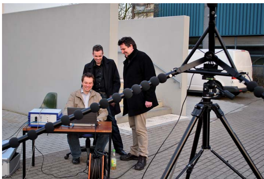
Akustische Kamera als Werkzeug zur akustischen Optimierung. (Foto: IBAF)
