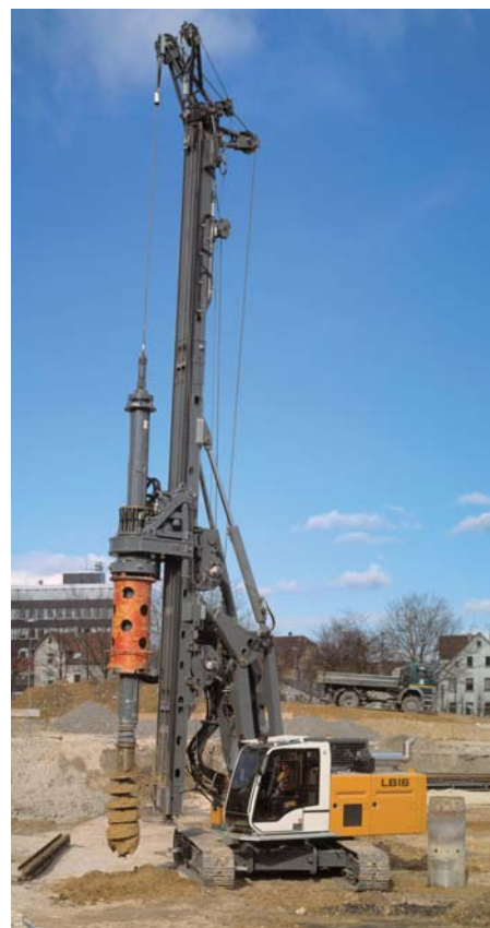
Die Parallel-Kinematik verleiht den Drehbohrgeräten große Stabilität. (Fotos: Liebherr)
