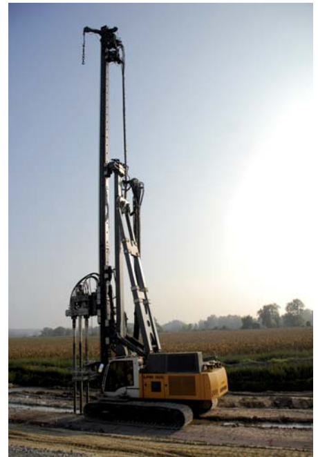
Vielseitig verwendbar: die Ramm- und Bohrgeräte mit Dreifach-Soil-Mixing-Ausrüstung.
