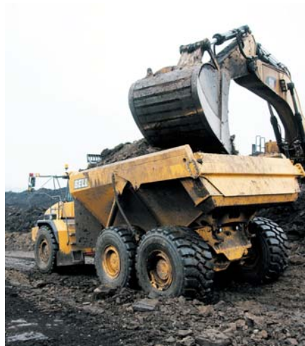
200 mm-Bordwanderhöhung ab Werk und die automatische Heckklappe steigern das Nennvolumen auf rund 30,5 m 3 .
