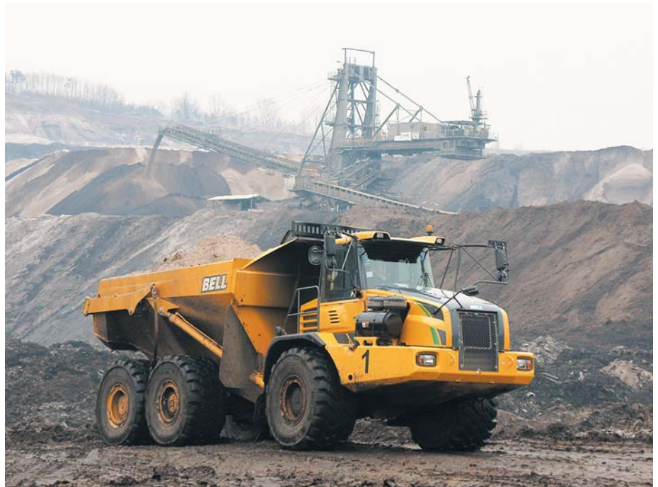
Die Bell B50D-Großdumper erreichen eine Tagesleistung bis zu 2.800 t pro Fahrzeug im Doppelschichtbetrieb. (Fotos: Bell Equipment/tb)
