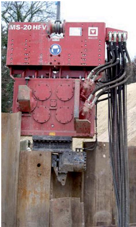
Vibrator MS-20 HFV im Einsatz.
