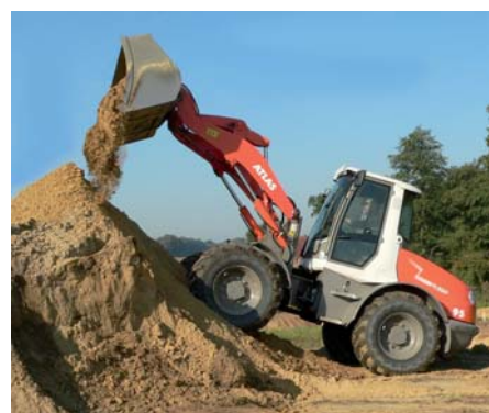
Modern: das aktuelle Modell AR 95 mit einer Leistung von 92 KW und einem Ladevolumen von bis zu 1,6m³.
