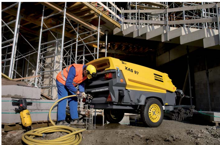
Mobile Schraubenkompressoren bieten eine zuverlässige Druckluftversorgung für Werkzeuge wie Druckluftmeißel, Druckluftpflömer, Schrauber, Schleifmaschinen und Stampfer. (Fotos: Atlas Copco)
