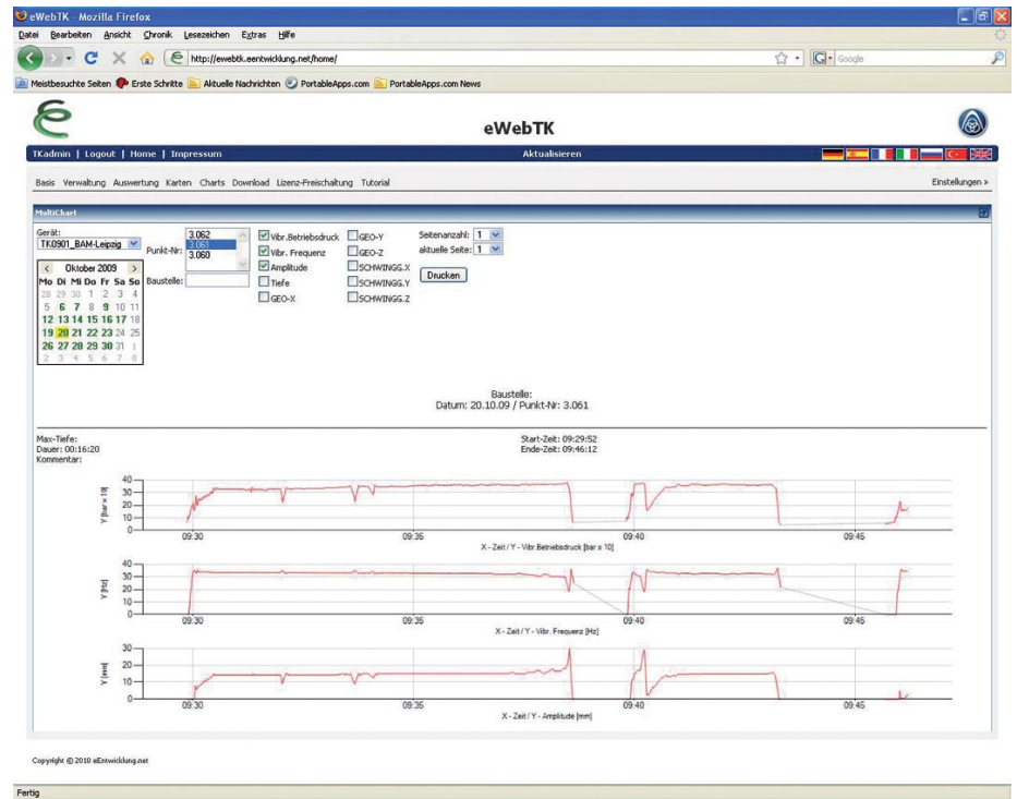
Internetprotokoll einer Rammung – Aufzeichnung von Druck und Frequenz.
