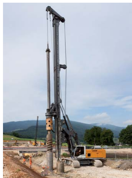
Stabiler Mäkler sowie robuste Kinematik mit großer Systembreite: der LB 28 von Liebherr. (Fotos: Liebherr)
