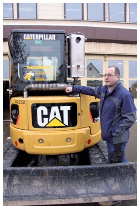
Frank Roller, Werkstattmeister der Otto Morof Tief- und Straßenbau GmbH, und der neue Cat Kurzheckbagger 305 CCR mit dem Wechselfiltersystem. (Fotos: Zeppelin)
