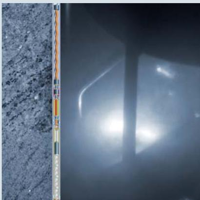
**Fast kein Verschleiß** beim Bohren entsteht, wenn statt der Druck- die Zugfestigkeit von Gestein per Elektroimpulsverfahren zu überwinden ist.
