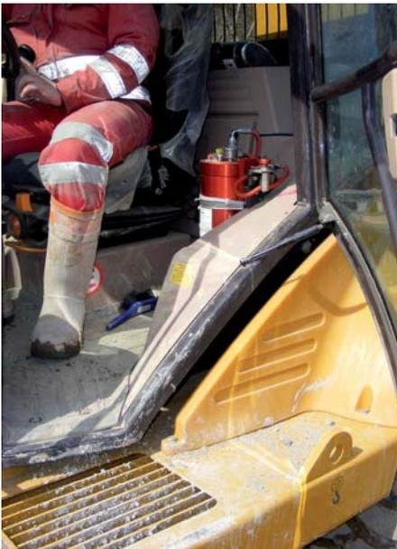
**Den Dumper rüstete** Hydrema u.a. mit einer Feuerlöschanlage aus.
