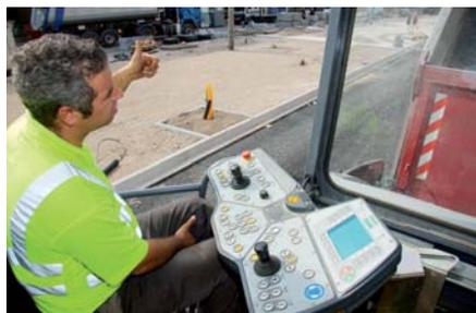
Alles im Griff dank ErgoPlus: Der aus-schwenkbare Fahrersitz erleichtert die Kommunikation mit dem Lkw-Fahrer. (Fotos: Vögele)
