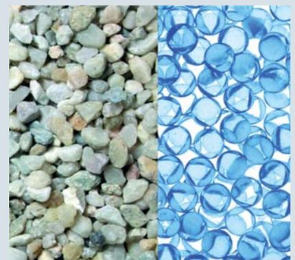
**Ochs setzt im Brunnenbau** statt Kies oder Splitt (li.) Kugeln aus Glas (re.) ein, die einen größtmöglichen freien Porenraum garantieren.
