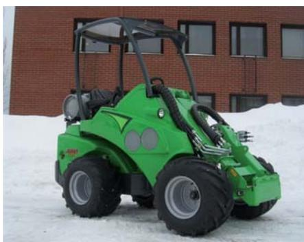
**Der neue Avant 525 lpg** wird mit Propangas betrieben und ist hervorragend für den Indoor-Einsatz geeignet.
