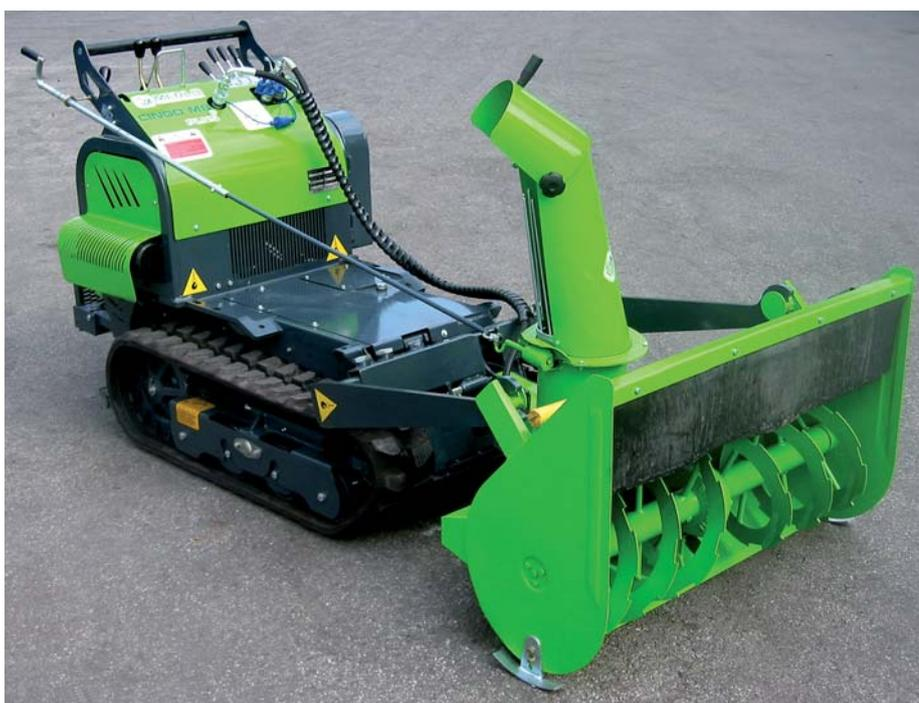
**Die Cingo-Transportraupen** sind als Ausrüstungsträger konzipiert: z. B. kann die Schneefräuseausrüstung in Minutenschnelle gegen Pritsche oder Mulde ausgetauscht werden. (Foto: Merlo)
