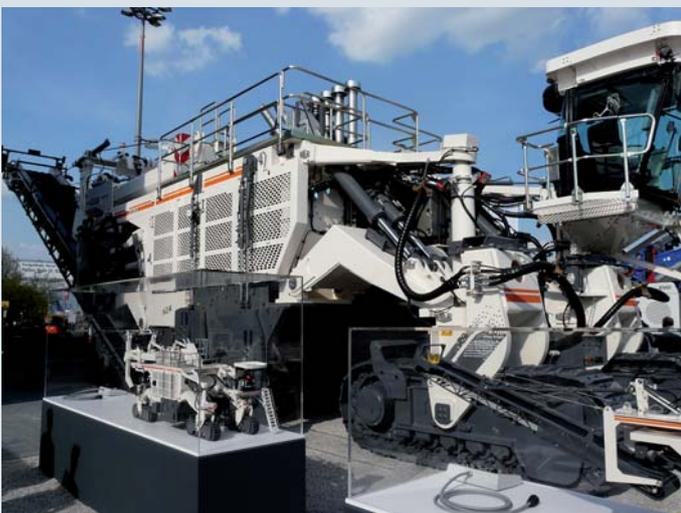
**Wenn die bauma ruft**, rollen die Giganten an. Ein Beispiel dafür war der Surface Miner 4200 SM von Wirtgen mit stolzen 200 t Eigengewicht bei einer Länge von 30 m.
