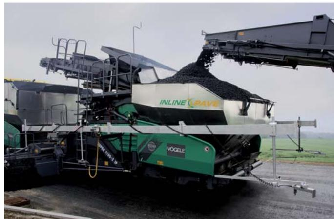
**Dieses Einbauverfahren** basiert auf dem Einsatz von normalen Serienmaschinen, die für den „Heiß-auf-Heiß“-Einsatz geringfügig modifiziert werden.
