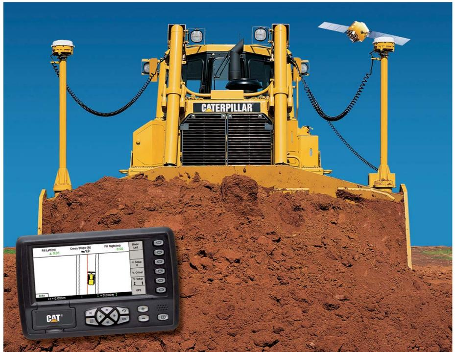
**Das Maschinensteuerungssystem** AccuGrade von Caterpillar macht die millimetergenaue Herstellung der vorgegebenen Geländeform ohne zeit- und kostenintensive Vermessungsarbeiten möglich. (Foto: Zeppelin)
