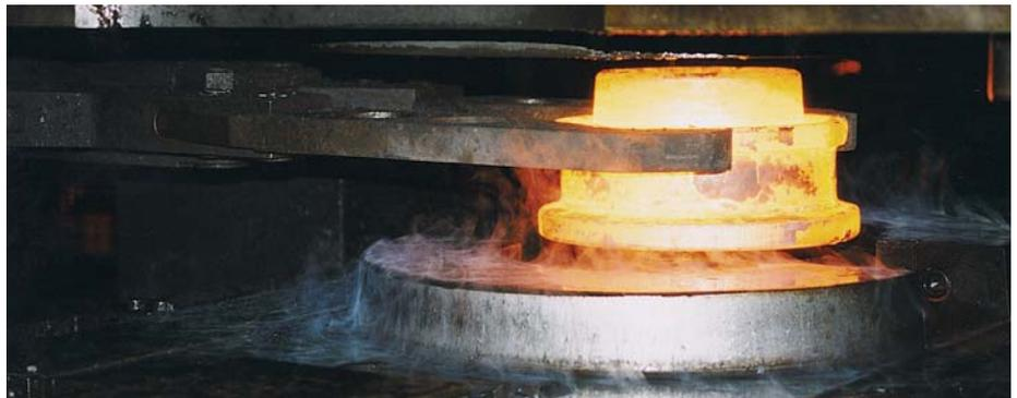
Eine Halbrolle wird durch Gesenkschmiedung gefertigt. (Fotos: Berco)
