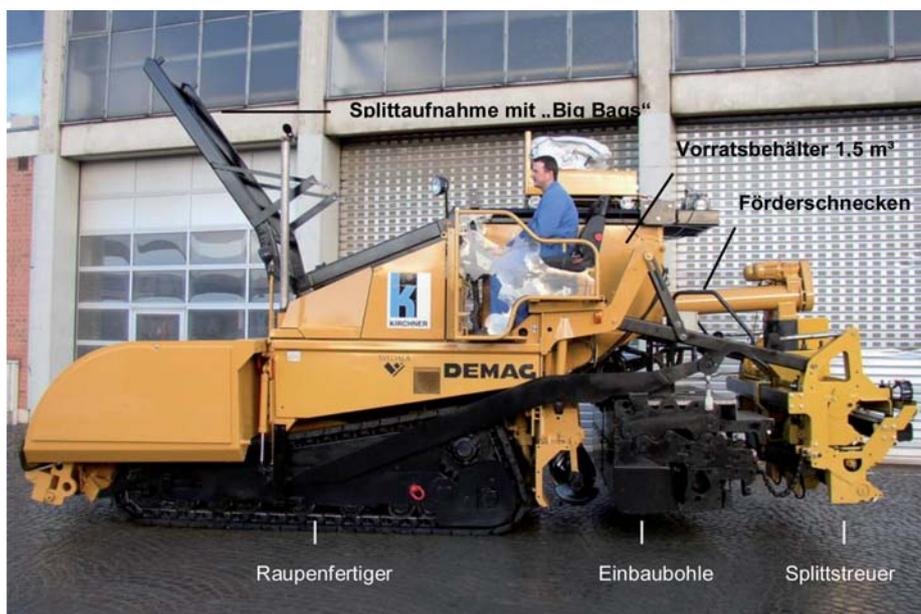
Asphaltstraßenfertiger mit integriertem Splittstreuer hinter der Einbaubohle. (Fotos: Kirchner GmbH)
