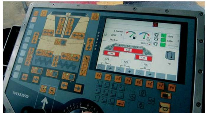
Das Bedienpult zeigt die Fertiger in Vogelperspektive. So kann der Fahrer auf den ersten Blick alle relevanten Funktionen erkennen.
