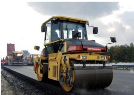
Die Tandem-Vibrationswalze CG 333 HF mit Hochfrequenz-Vibrationstechnik mit niedriger Amplitude verdichtet gut dünne Asphalt-schichten mit großer Körnung. (Fotos: Dynapac)
