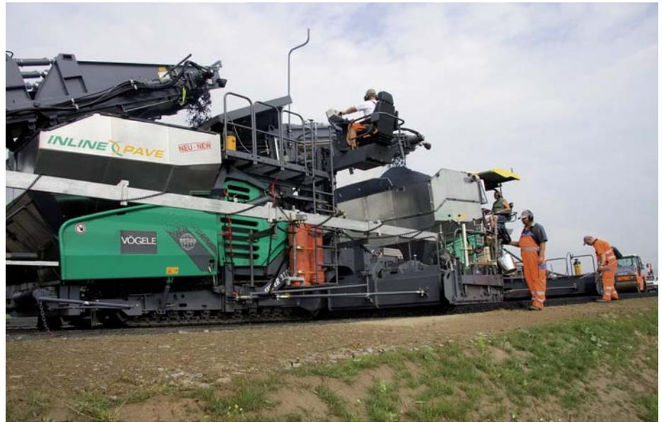
Beim InLine Pave-Verfahren wird der Asphalt „Heiß-auf-Heiß“ eingebaut.
