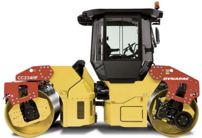
tisch auf die Leerlaufdrehzahl zurück. Dadurch werden die Emissionen reduziert, Kraftstoff gespart und der Lärm minimiert. Eine weitere automatische Funktion ist die Aktivierung der Feststellbremse nach drei Sekunden im Stillstand, wodurch das Risiko einer unerwarteten Bewegung der Walze vermieden wird.
