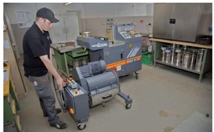
**Die WLB 10 S** ist eine komplette Einheit für eine umfassende Laboranalyse, die nur noch an das Starkstromnetz angeschlossen wird. (Fotos: Wirtgen)
