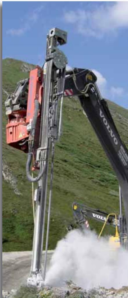
Die neuen Bohranlagen AB 2000T eignen sich für Trägergeräte ab 25 t Einsatzgewicht.
