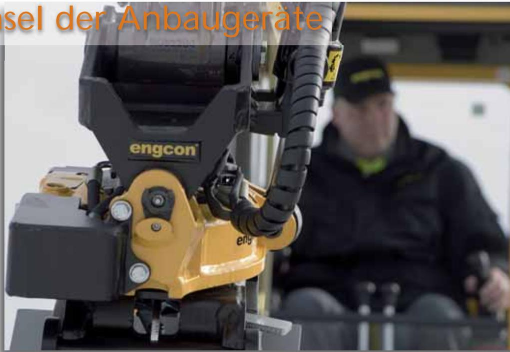
Der EC-oil-Schnellwechsler steht für eine neue Schnellwechslerreihe mit automatischen Hydraulikanschlüssen. (Foto: engcon)
