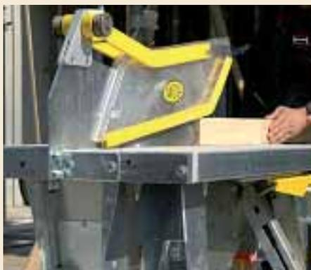
Die Sicherheitsschutzhaube SSH wird so an Baukreissägen arretiert, dass ein Sägen nur bei geschlossener Haube erfolgt. Das erhöht die Sicherheit und mindert Unfallrisiko.
