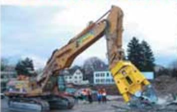
**OilQuick im Erdbau für Bagger von 1 bis 120 t**
