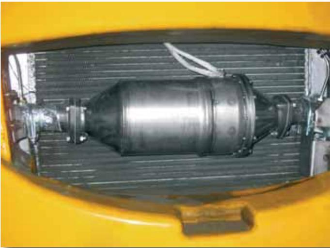
Der Dieselpartikelfilter SMR-AR im eingebauten Zustand, hier in einem Gabelstapler. (Abbildung/Foto: Mann+Hummel)
