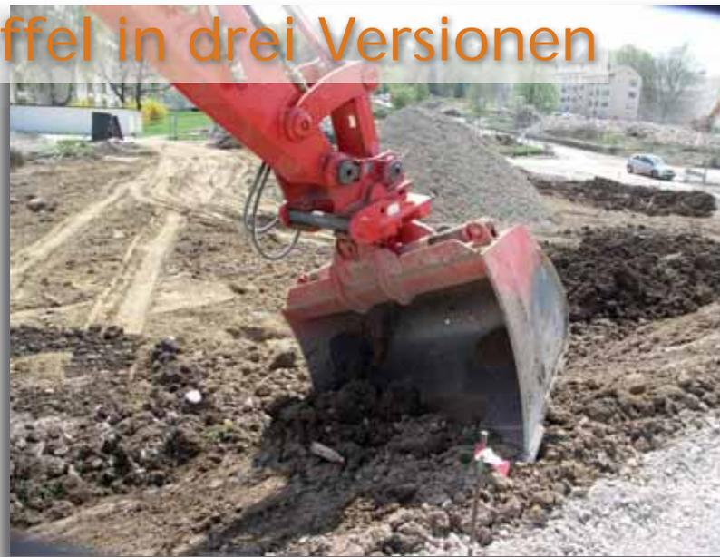
bereich von hoher Wichtigkeit. Lehnhoff hat die Schwenklöffel bis zum Schwenkkopf verschlaucht, um einen problemlosen Bewegungsablauf der Schläuche und eine lange Lebensdauer zu gewährleisten. Damit kann die Hydraulik des Schwenklöffels einfach und problemlos an jeden Bagger angeschlossen werden.
