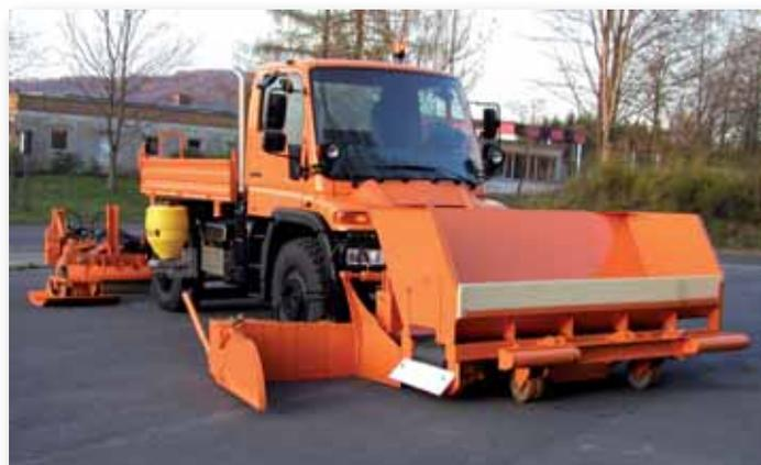
Maschinen auf einen Tieflader. Alle Anbaugeräte verbleiben zum Transport am Fahrzeug und sind hydraulisch auf die für den Straßenverkehr zulässige Breite einfahrbar. Mit dem Unimog als Trägerfahrzeug ist ein schnelles Umsetzen zwischen den Baustellen mit einer Transportgeschwindigkeit von 80 km/h möglich. Dieses Selbstfahrerkonzept sowie eine vollhydraulische Steuerung der Einbaukombination reduzieren die Rüstzeiten auf ein Minimum.
