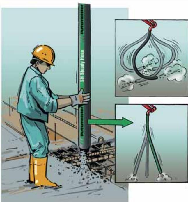
Sieger Kategorie „Neuentwicklungen im Bereich von Maschinenkomponenten“: gedämpfter Beton-Endschlauch vermindert das Unfallrisiko des Bedieners durch Ausschlagen des Schlauches. (Foto: Putzmeister)
