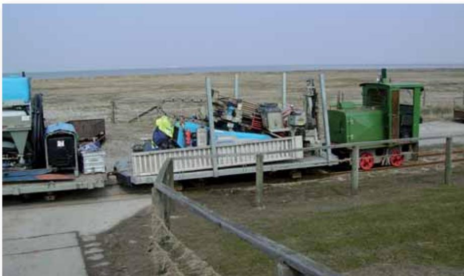
Der Transport der Bohranlage und sämtlicher Ausrüstung für den Bau der Kläranlagen und den dafür benötigten Abwasserrohren erfolgte mit der Lore.
