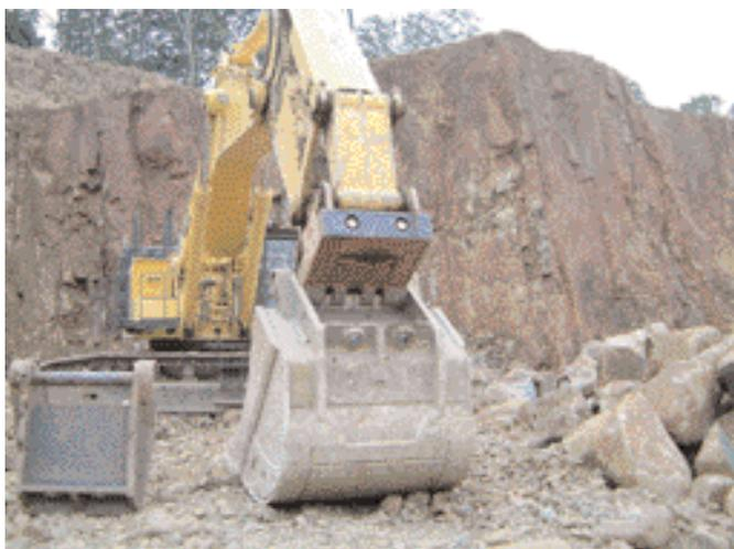
Komatsu-Bagger PC 1250 mit ca. 130 t Einsatzgewicht, ausgerüstet mit 6,5-m<sup>2</sup>-HD-Felslöffel zum Laden des gerissenen Gesteins.
