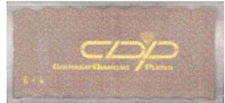
Gegen großflächigen Verschleiß: CDP-Verschleißschutzplatte vom Typ XuperWave in der Standardabmessung 1.500 x 3.000 mm. Auftragschweißung in Mäander-Form macht unabhängig von der jeweiligen Angriffsrichtung und führt zu besseren Standzeiten.
