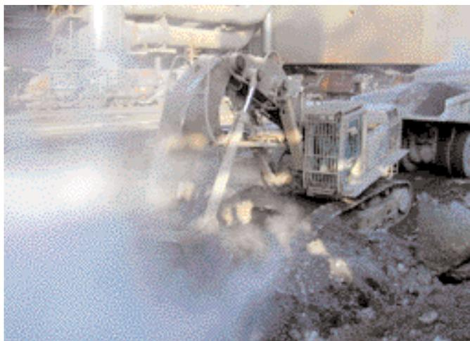
Der 70-t-Hochlöffelbagger schlägt zur Weiterverarbeitung zwischengelagerte Stahlwerkschlacke um.
