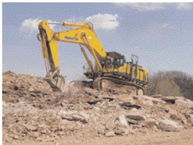
...und mit einem Reißzahn mit auswechselbarer Zahnschneidkante, Gewicht 2,4 t, zum Reißen und Lösen von schichtgelagertem Kalkstein. (Fotos: Lehnhoff)
