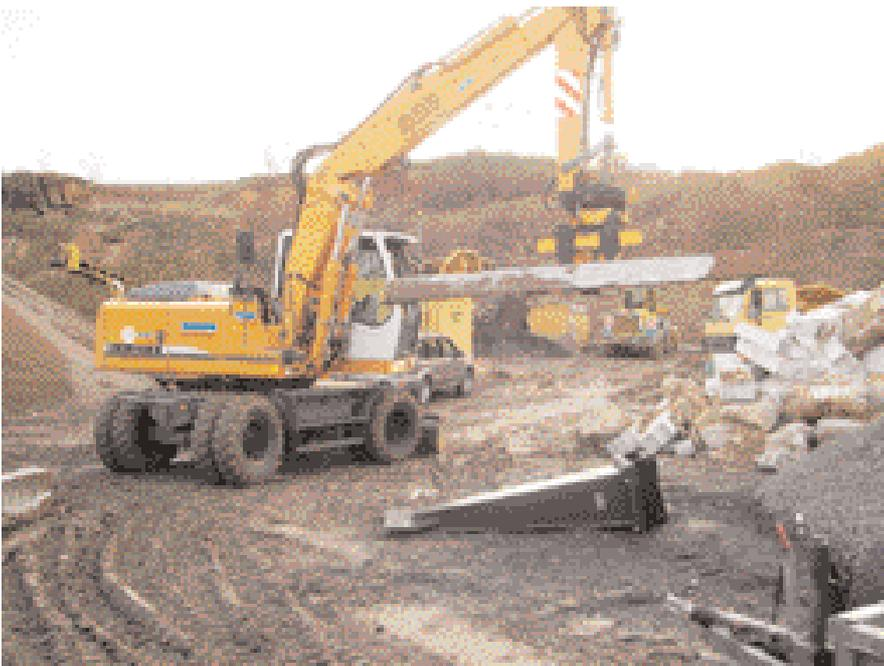
Tiltrotator mit angekuppelter Palettengabel ersetzt schon mal den Radlader.
