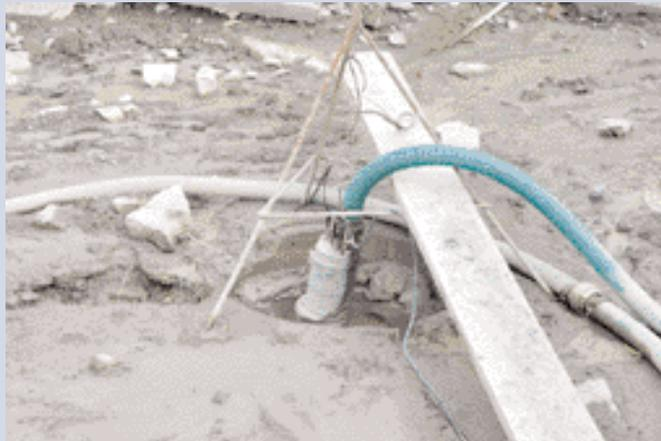
Vorbildlicher Pumpeneinsatz: Formstabiler Schlauch, Halteseil und zugentlastete Stromzuführung sichern Leistung und Lebensdauer elektrischer Tauchmotorpumpen. (Foto: Tsurumi)
