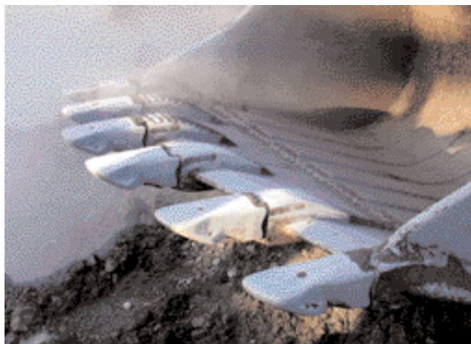
Die Spitzen des dreiteiligen Zahnsystems Super-V werden innerhalb weniger Minuten ohne Spezialwerkzeuge gewechselt.
