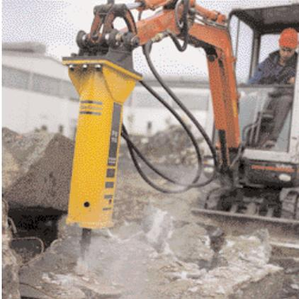
PB 110 im Betonaufbruch.
