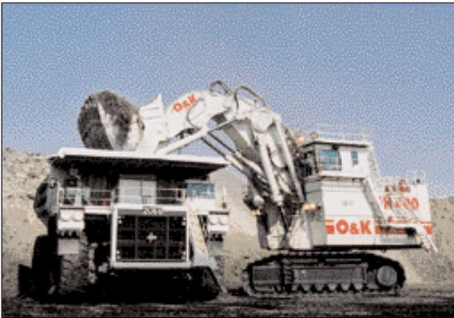
Bild 1: Terex RH 400 bei der Ölsandgewinnung.
