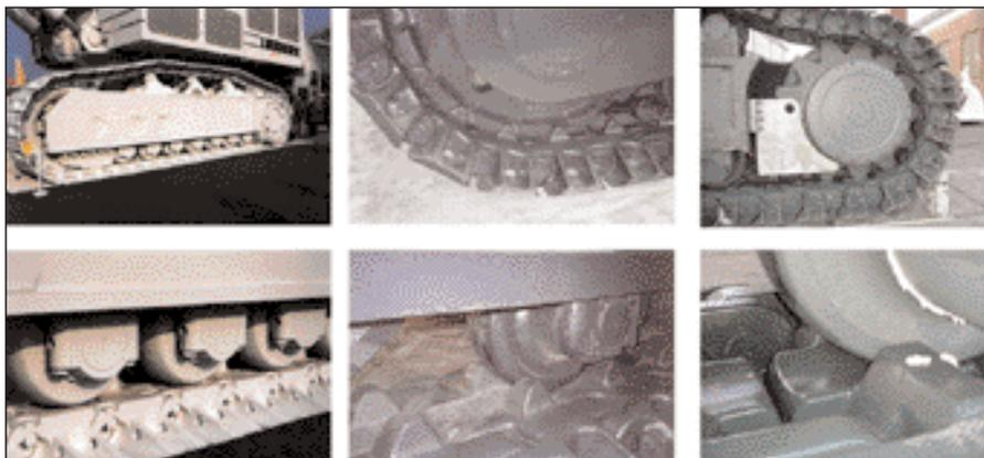
Bild 6: Unterschiedliche Laufwerkskonzepte für Groß-Hydraulikbagger.
