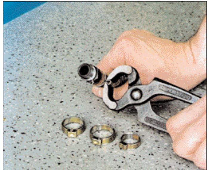
„Öhrchenklemmen“ können auch per Kneifzange aufgepresst werden. Doch dann eignen sie sich nur für Arbeitsdrücke bis etwa 6 bar.
