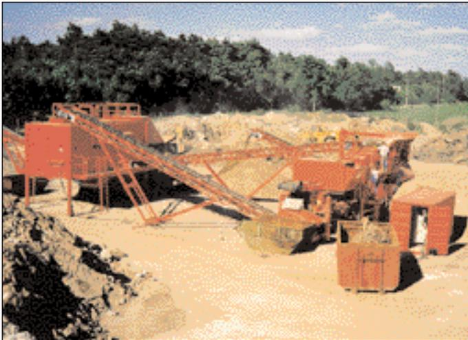
Mobile Prallbrecheranlage mit Fremdstoffabscheidung
