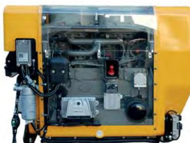
Der neue 4-Zylinder-Motor erreicht IIIb und Tier IV ohne Dieselpartikelfilter.
