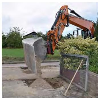
*Mit dem Roto-Top können alle Anbaugeräte mit ein und dem selben Rotator endlos gedreht werden.*
