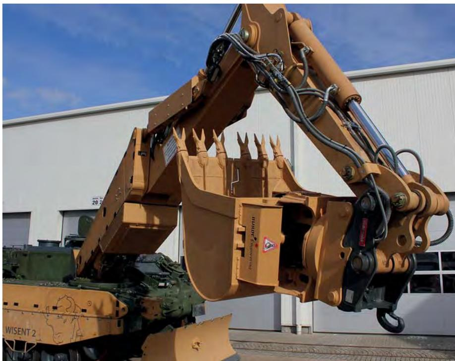
Das Wisent 2 mit seinem hydraulischen Baggerauslegersystem von FFG wird für knifflige Pionieranwendungen genutzt. (Fotos: Burde)
