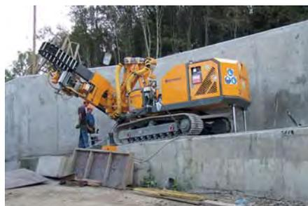
*Morath stellt u. a. diese Bohrmaschine mit Funkfernsteuerung vor.*
