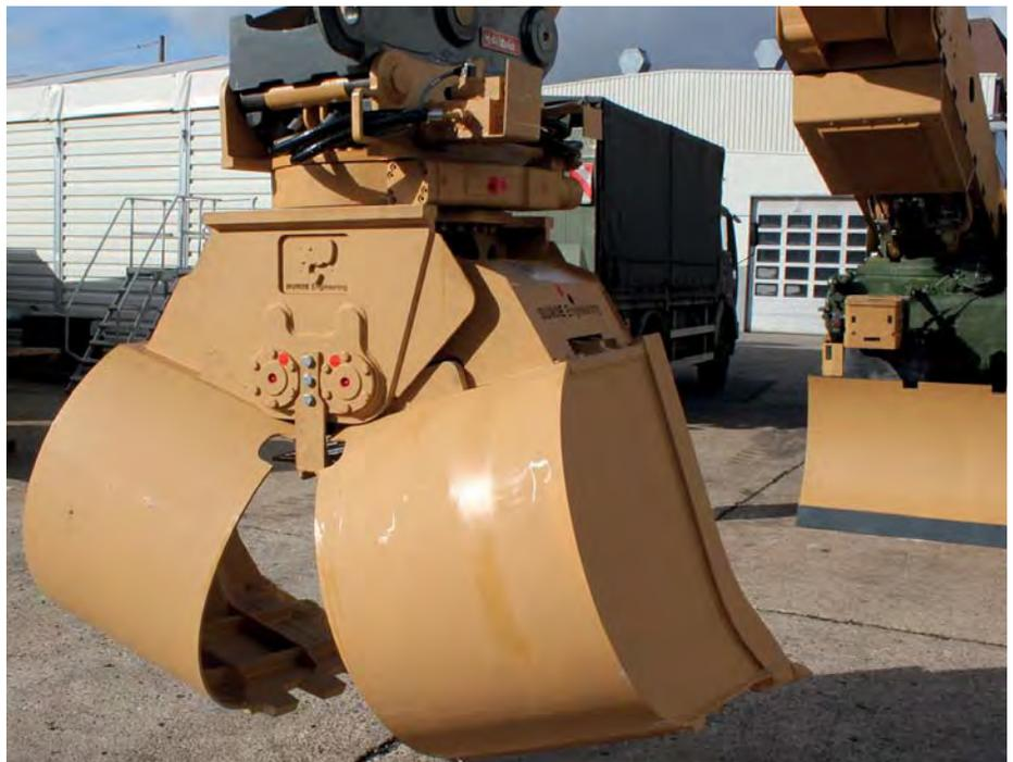
Multifunktionsgreifer von Burde mit Adapter von Oilquick und Zähnen von Esco.
