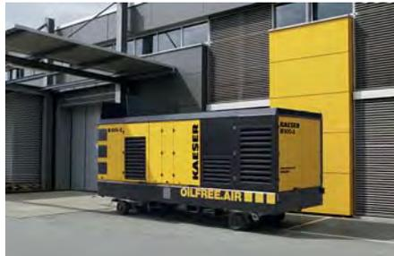
**Der neue M500-2 produziert Druckluft von 6,9 bis 10,3 bar.**
