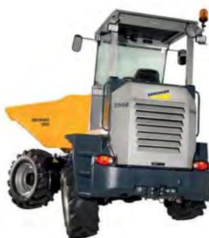
Das Schutzdach des neuen Kurzheckdumpers 2060 plus ist höhenverstellbar.
