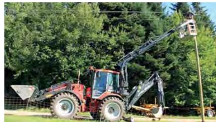
**Die am Huddig Volt seitlich angebaute Hubarbeitsbühne ist vollisoliert.**
