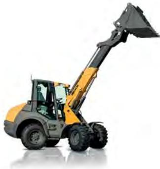
**Der AT 1050 verfügt über eine Ausschütthöhe von 4,05 m.**
