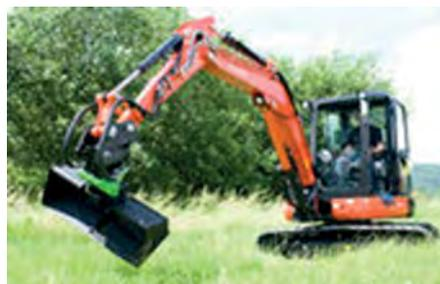
*Wie man es dreht und wendet: der TiltRotator von HKS ermöglicht flexibles Arbeiten.*
