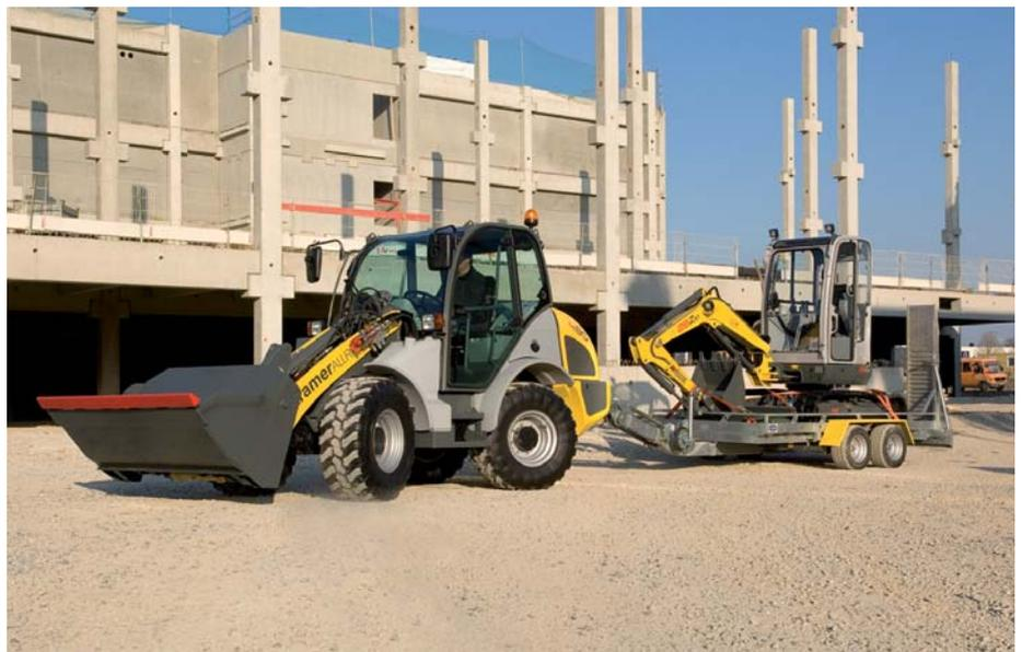
*Der 480er von Kramer mit dem hydrostatischen Ecospeed-Schnellganggetriebe. Damit lässt sich die Geschwindigkeit stufenlos bis zu einer Höchstgeschwindigkeit von 40 km/h anpassen. (Foto: Kramer)*
