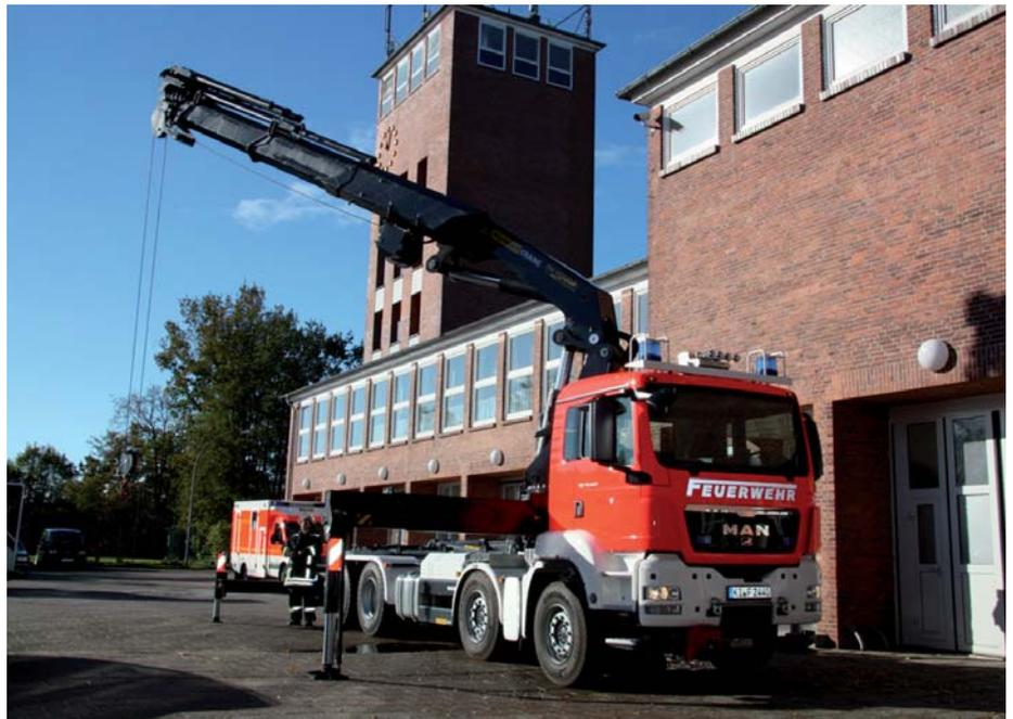
Die Feuerwehr Kiel setzt auf ein neues Wechsellaaderfahrzeug mit Ladekran, Wechsellaadereinrichtung und einer Fahrzeugwinde. (Foto: Palfinger)
