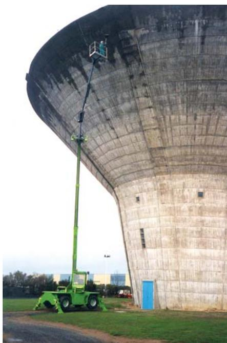
**Mit der gelenkigen Zusatzkinematik Space-System werden heute mit Merlo-Teleskopmaschinen punktuelle Arbeitshöhen von mehr als 36 m erreicht. (Foto: Merlo)**
