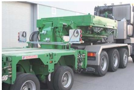
**Der neue Schwanenhals, hier auf einem Trailer montiert, ist auf die Sattellast stufenlos einstellbar.**
