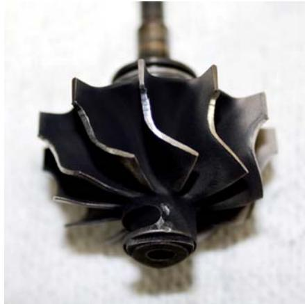
*Ein Abgasturbolader besteht aus einem Verdichter und einer Turbine wie der abgebildeten – die, angetrieben von den Abgasen des Motors – die Antriebsenergie für den Verdichter liefert.*
