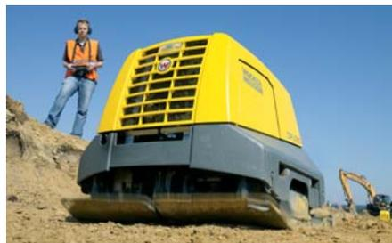
**Die gezeigte Vibrationsplatte DPU 130 ist für den bauma-Innovationspreis nominiert.**
