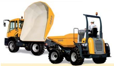
**Der neue Dumper 3009 als Rundkipper und der beliebte Dumper 2090.**
