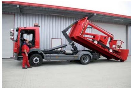
**Aus der Telescopic-Reihe wurden Palift-Abrollkippermodelle modifiziert, hier der T 10-13.**
