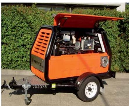
**Jetzt von Tsurumi lieferbar:** Dieselmotorpumpen der Marke Primax, hier das Modell Yakka 150 für Förderleistungen bis 132 l/s. (Foto: Primax)
