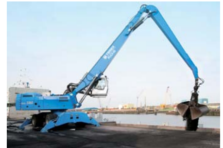
Der Ausleger erreicht eine maximale Reichweite von 21 m. (Fotos: Terex/Kiesel)
