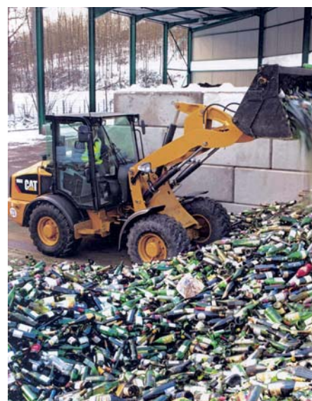
Der Cat Radlader 906H überzeugt mit starken Ausbrech- und Rückkippräften und ist dank Schnellwechsler äußerst flexibel einsetzbar.
