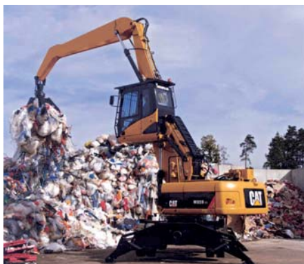
Der Cat Umschlagbagger M322D MH bietet mit seiner hydraulisch ausfahrbaren Fahrerkabine eine gut Rundumsicht.
