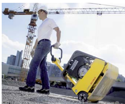
Ankippen und los: Die DPU 3050 H E verfügt über einen E-Start und integrierten Radsatz. (Foto: Wacker Neuson)
