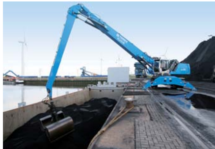
Der MHL380D hat sich beim Hafenumschlag von trockenen Schüttgütern als zuverlässige und leistungsstarke Umschlagmaschine erwiesen.
