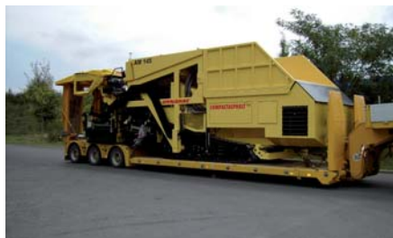
Neue maschinentechnische Entwicklung für die Herstellung kompakter Asphaltbefestigungen. (Fotos/Abbildungen: Autor)
