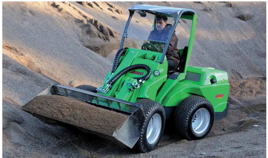
Die neue Avant-700-Serie: Hier der Funktionslader 750 mit 1,7 t Eigengewicht, einer Hubkraft von 1,35 t und einer Fahrgeschwindigkeit von bis zu 24 km/h. (Foto: Avant)
