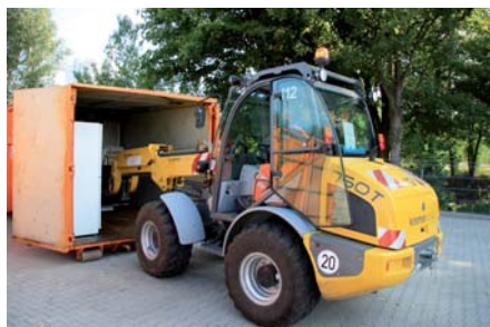
Mit seiner Palettengabel kann der Teleradlader problemlos Kühlschränke und Waschmaschinen in einen Container einlagern. (Fotos: Kramer)
