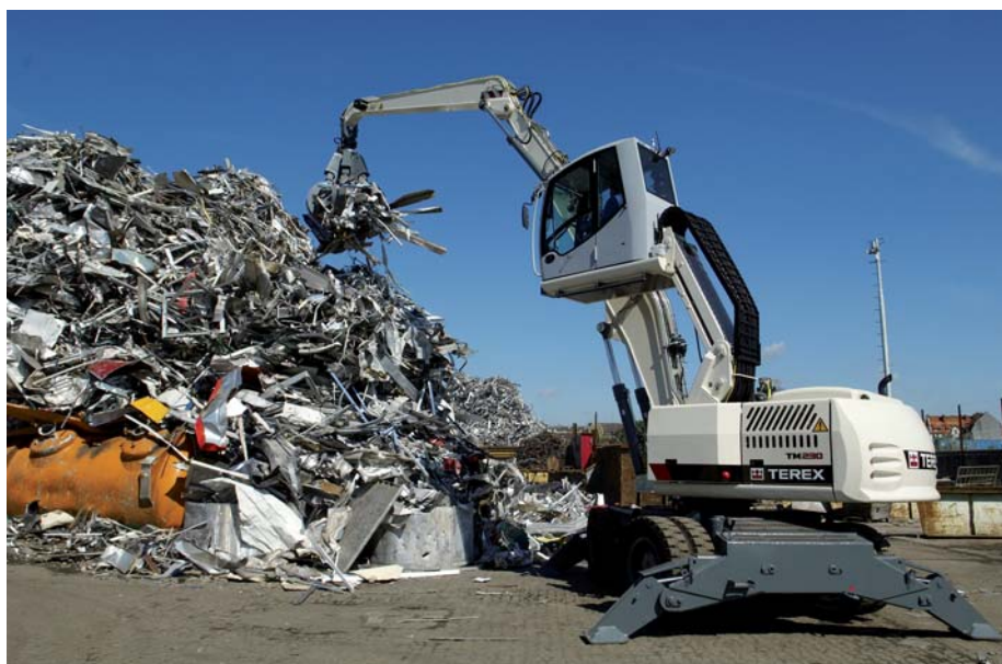
Der Mobilbagger TM 230 mit hochfahrbaren Fahrerkabine sortiert auf Schrottplätzen das Material.
