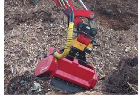
Maximale Flexibilität: Schwenkrotator mit unterschiedlichen Werkzeugen wie Baumschere, Grabenräumlöffel und Wurzelstockfräse. (Fotos: Rädlinger)
