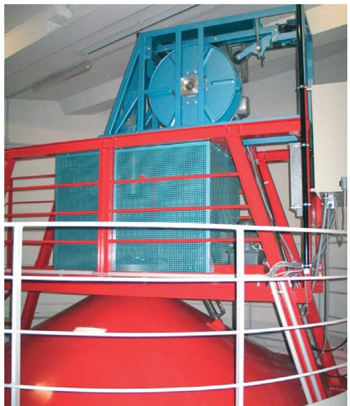
Das Hochziehen der Fallkapsel im Bremer Fallturm übernimmt ein tirak Typ X 3000 mit 150 m Seilspeicher. (Fotos: Greifzug)
