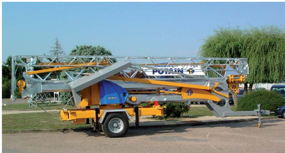
Zusammengeklappt lässt sich der Schnellmontagekran Igo MC 13 einfach und problemlos transportieren. (Fotos: Manitowoc)
