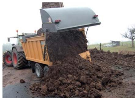
Beim neuen Baustellenmuldenkipper handelt es sich um einen Abschiebewagen, der nicht durch Abkippen entleert wird, sondern bei dem das Material durch ein Schild nach hinten abgeschoben wird. (Fotos: Stehr)
