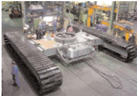
Montage eines Bandabsetzers B9, Gewicht 250 t
