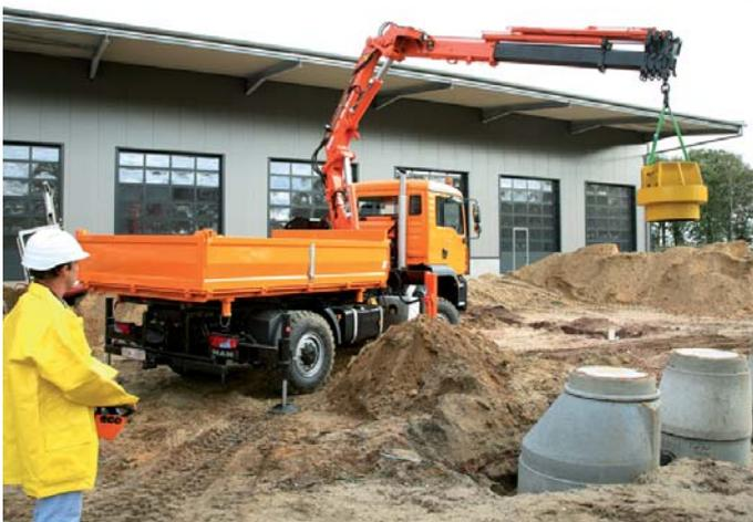
Das neue Allrad-Baufahrzeug der Firma Kuhlmann wurde mit einem Terex Atlas Ladekran vom Typ 190.2E ausgerüstet, hier beim Abtransport einer sogenannten Rammhaube.
