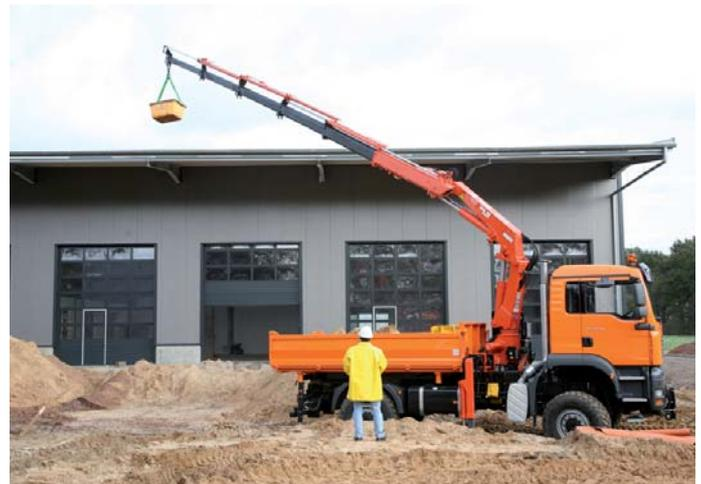
Das Baufahrzeug setzt hier mittels Ladekran einen Werkzeugbehälter auf das Dach eines Industriegebäudes. Der seitlich versetzte Knickarm ist hydraulisch fünfmal ausschiebbar. (Fotos: Terex)
