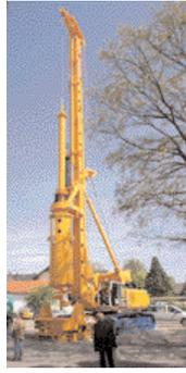
Bauer-Großdrehbohrgerät BG 40
