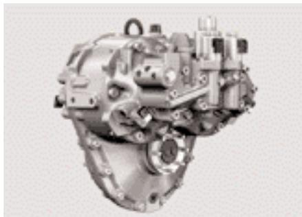
Das neue hydrostatische Getriebe 2 HC 85
