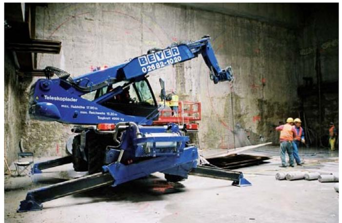
Das mit einem Rußpartikelfilter ausgestattete Gerät ist äußerst kompakt: Bei geringen Abmaßen lässt sich die Hubhöhe von 18 m auch klein einfahren.
