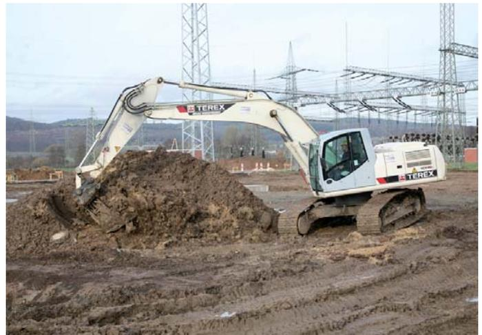
Rund 33.000 m<sup>3</sup> Bodenmaterial muss der Bagger mit seinem Betriebsgewicht von 25,1 t ausheben. (Fotos: Terex)
