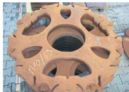
Antriebs-scheiben für Erdverdichtungsmaschinen
