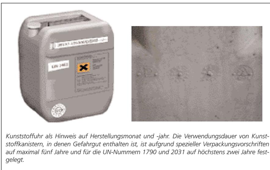
Kunststoffuhr als Hinweis auf Herstellungsmonat und -jahr. Die Verwendungsdauer von Kunststoffkanistern, in denen Gefahrgut enthalten ist, ist aufgrund spezieller Verpackungsvorschriften auf maximal fünf Jahre und für die UN-Nummern 1790 und 2031 auf höchstens zwei Jahre festgelegt.
