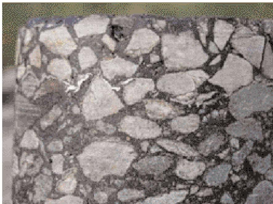
Bohrkern Kompaktasphalt im Querschnitt [1].
