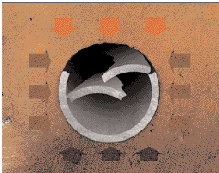
Bruch eines biegesteifen Rohrmaterials (Quelle: ATV 1999).
