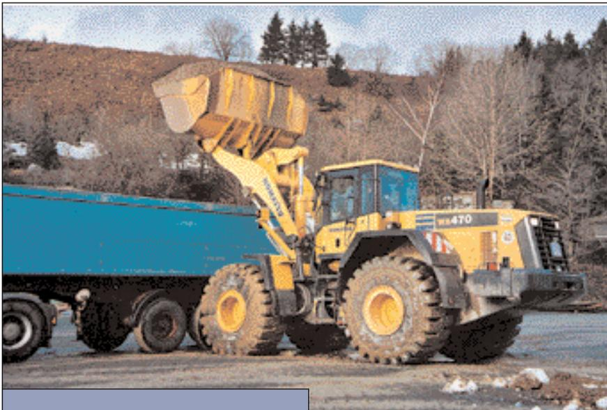
**M**it dem neuen 4,5-m<sup>3</sup> Radlader WA470-5 aus hannoverscher Produktion stellt Komatsu in dieser Klasse zweifelsfrei das modernste und leistungsstärkste Gerät.
