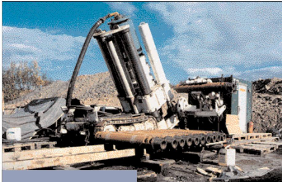
Die neue Robbins 73 RM-VF Raisebohrmaschine für Bohrdurchmesser zwischen 1,8 und 3,1 m hat einen neuartigen drehzahlgeregelten Antrieb. Weil damit die Drehzahl des Räumkopfs bzw. Pilotbohrers stufenlos geregelt werden kann, lassen sich bessere Schneidökonomie und höhere Produktivität erzielen.
