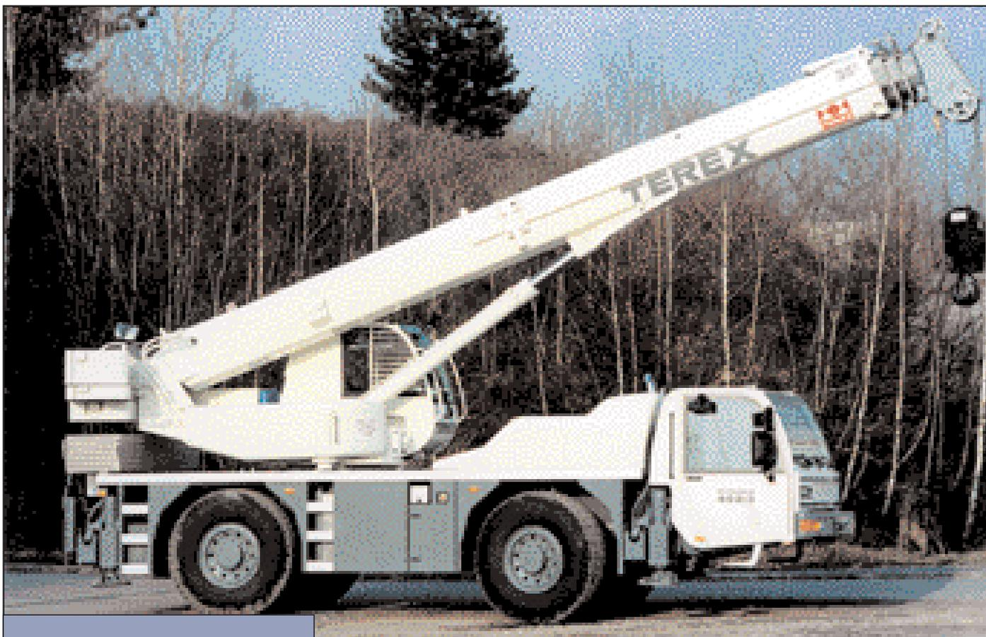
Der Terex-PPM ATT 400/3 ist die jüngste Evolutionsstufe des seit vielen Jahren produzierten All-Terrain-Kranes. Wichtigste Neuerungen des aktuellen Jahrganges sind eine verringerte Fahrzeugbreite von nur 2,55 Meter mit 14.00 oder 16.00-Bereifung und das geringe Fahrzeuggewicht. Die Hakenhöhe des vierteiligen Auslegers beträgt 31,6 Meter. Sie kann mit einem Doppelspitzenausleger um 15 Meter verlängert werden. Die maximale Traglast des Terex-PPM ATT 400/3 beträgt 35 Tonnen.
