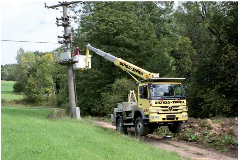
**Test bestanden:** Der Einsatz von Hubarbeitsbühnen in Steigungen bis 11° ist anspruchsvoll, aber möglich. (Foto: Palfinger)
