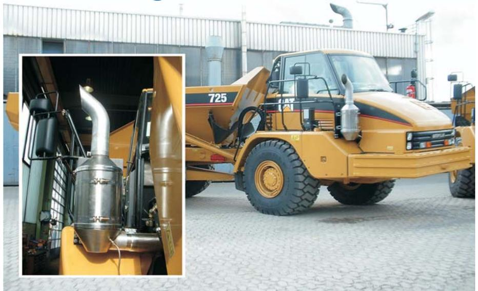
**Nachgerüstete Partikelfilter** könnten die Sicherheit des Bedieners gefährden oder zum Verlust der Straßenverkehrszulassung führen. (Foto: Puritech)
