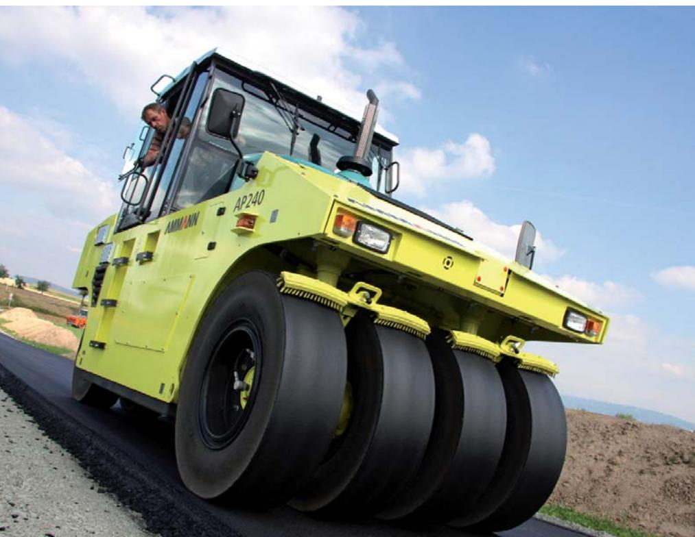
**Eine Gummiradwalze** wie hier von Ammann ermöglicht eine vibrationsfreie Verdichtung. (Fotos: wyynot GmbH / Karen Dörflinger)
