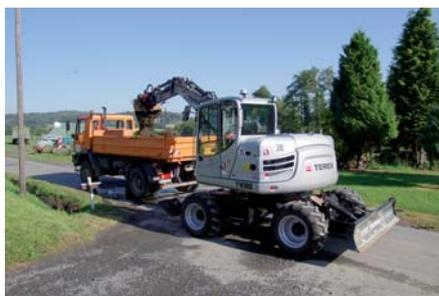
*Dank Schild und zwei Prätzen steht der Terex sicher, der Rototilt von Indexator erhöht die Flexibilität.*
