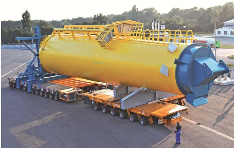
Zwei IHT-Fahrzeuge und 2 x 12 Achslinien SPMT befördern einen Teil eines Windturms zum wartenden Kran. (Fotos: Scheuerle)
