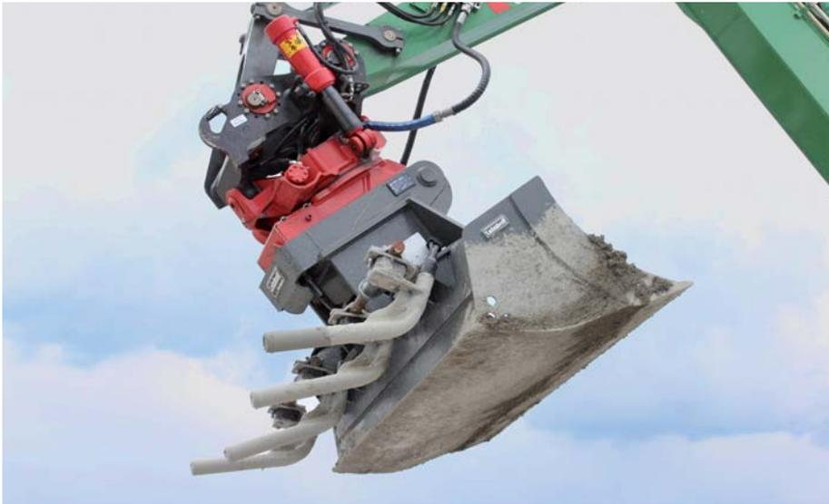
An der Rückseite des Löffels sind vier hydraulisch betriebene Rüttelflaschen in Reihe angebracht. (Fotos: Lehnhoff)
