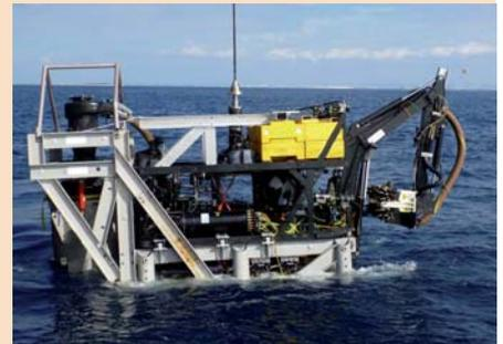
**Funktionierte 2 km** unter dem Meeresspiegel: das Trägergerät mit einer Terex-Anbaufräse. (Foto: Terex)
