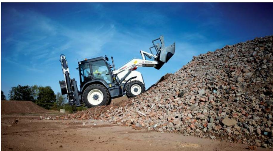
*Ein neues Hochdruck-Hydrauliksystem und ein modifizierter Ausleger machen schnelles Verfüllen mit dem Terex-Baggerlader möglich. (Foto: Terex)*
