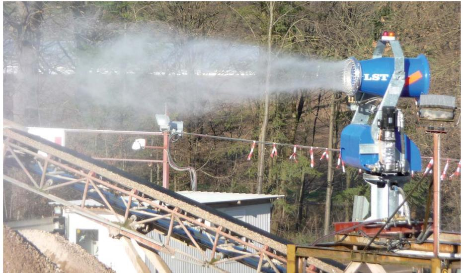
**Ferngesteuert und programmierbar** minimiert das LST-Staubbindesystem die Staub- und Geruchsbildung auf Deponien. (Foto: LST)
