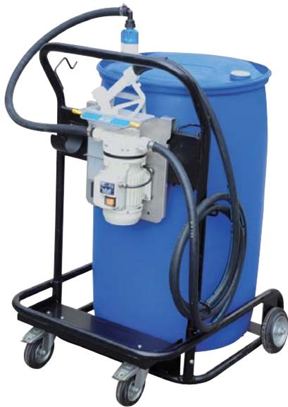
Die Komponenten sind so angeordnet, dass sich die gängigen AdBlue-Fässer mit 210 l Inhalt ganz schnell und einfach auswechseln lassen. Man muss nur die Schnellkupplung des Saugschlauchs vom Fass lösen, nimmt das alte Fass weg und schiebt das Neue auf den Wagen. Die Förderleistung der Pumpe beträgt maximal 35 l pro Minute, der Druck reicht bis zu 1,5 bar. Die Pumpeneinheit ist wahlweise mit oder ohne Zählwerk und mit manueller oder automatischer Zapfpistole erhältlich.
