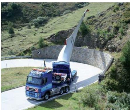
**Eine spezielle Hebe- und Senkfunktion** macht die Kurve erst passierbar. (Foto: Scheuerle)
