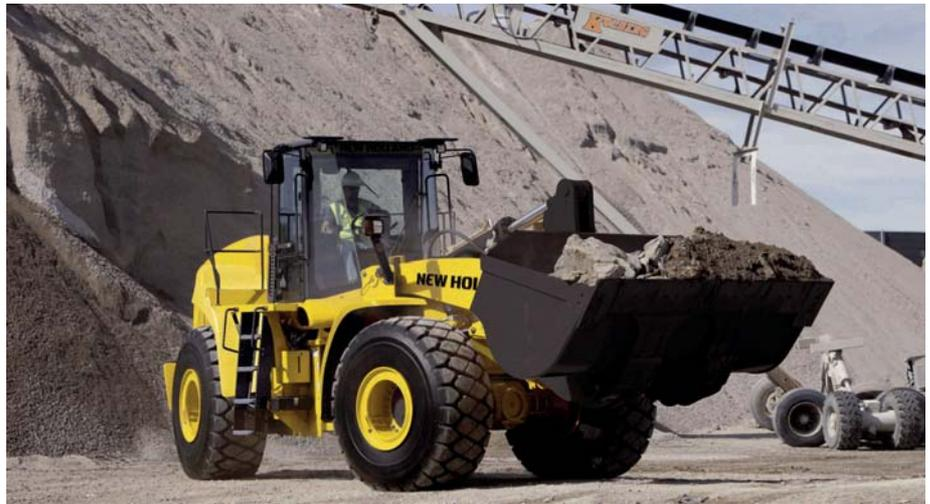
**Erfüllen die Abgasnorm Tier IV interim:** die neuen New Holland-Radlader der C-Serie.
