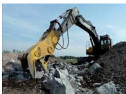
Atlas Copco hat zwei neue hydraulische Haufwerkspulverisierer im Programm. Durch die neue gewinkelte Bauform eignen sich die Haufwerkspulverisierer BP 2050 und BP 3050 ideal für sekundäre Abbrucharbeiten und die Zerkleinerung von armierten Betonelementen. Dank eines optionalen hydraulischen Drehwerks ist die BP-Bau-
