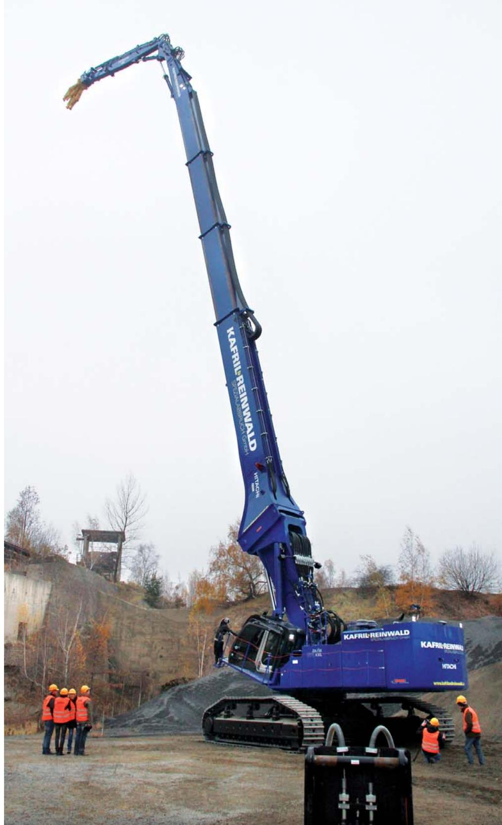
*Der Hitachi ZX 870-3 ist eine umgebaute Erdbau- und Steinbruchmaschine. Der Abbruchbagger reicht mit seinem längsten Ausleger 50 m hoch. (Fotos: Atlas Copco MCT)*
