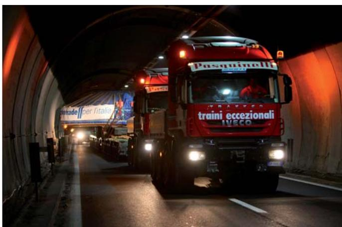
Nur wenige Millimeter blieben zwischen Tunnelwand und dem Transport. (Fotos: Goldhofer)
