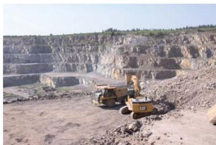
**Im Steinbruch** samt Schotterwerk wird hochabrasives Material abgebaut – ein echter Härtestest für Radladerschaufeln und Baggerlöffel.
