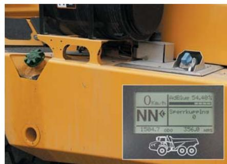
**Der bodennah** sicher erreichbare Adblue-Tank (rechts) bietet Reserven für drei Dieselfüllungen. Füllstand und Funktion des Blu@dvantage-Systems sind jederzeit per Cockpit-Display ablesbar.
