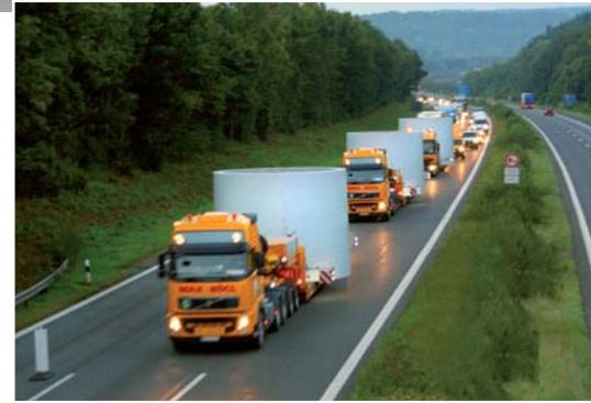
**Mehr Leistung:** Für Transporte von Fertigteilen zum Bau von Windkraftanlagen setzt Max Bögl Volvo FH16 600 ein.
