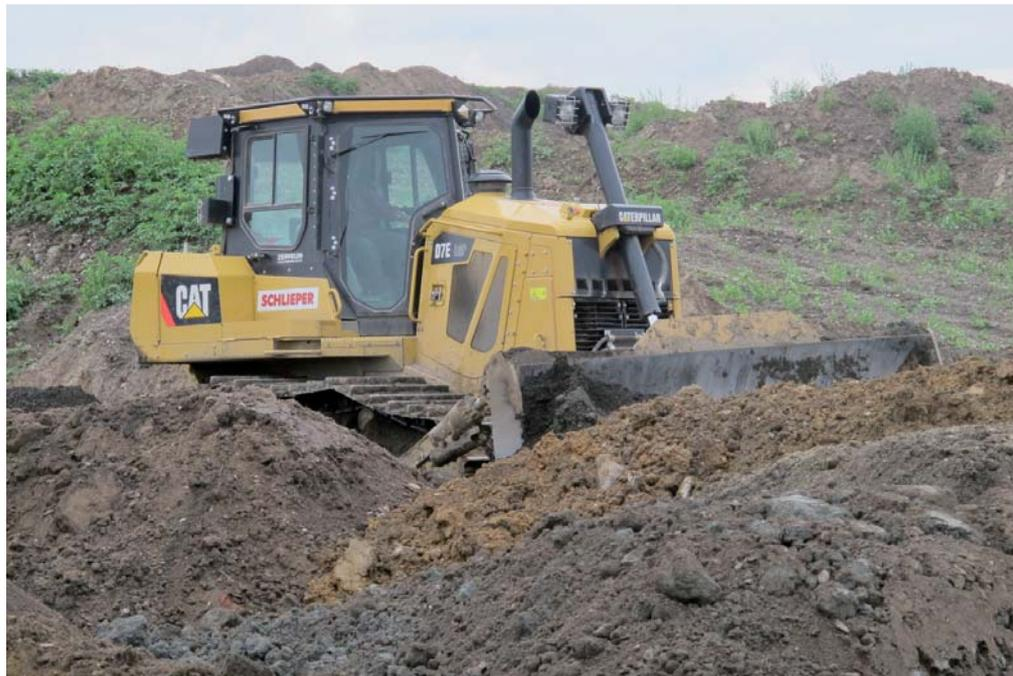
**Starke Schubleistung:** Der neue Cat-Dozer Typ D7E im Einsatz bei der Schlieper Baustoff & Transport GmbH. (Fotos: Zeppelin)
