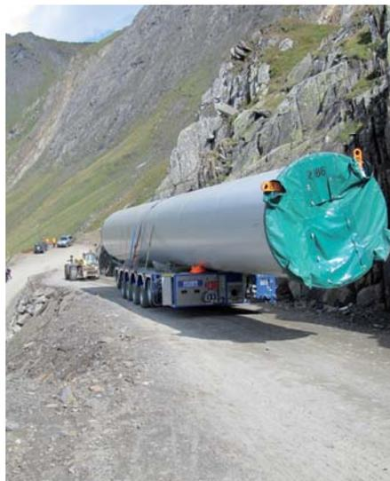
**Der InterCombi SP** befördert Turmsegmente über den Nufenenpass bis zur Montagestelle in 2.465 Metern Höhe. (Fotos: Scheuerle)
