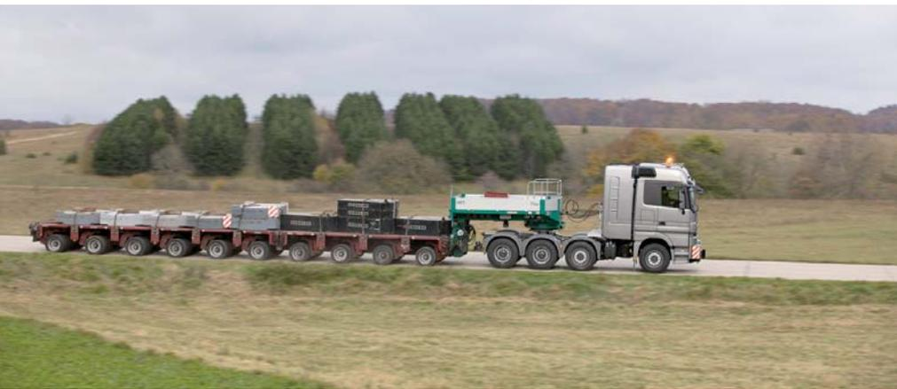
**Der Actros SLT** ist für Gesamtzuggewichte bis 250 Tonnen entwickelt worden. Seine hydrodynamische Turbokupplung ermöglicht maximale Anfahrzugkraft bereits bei niedrigen Motordrehzahlen. (Foto: Daimler)
