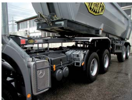
Schnell und unkompliziert: Das Fahrzeug hebt nach der Unterfahung den Kippsattelanhängen an. (Foto: Meiller)
