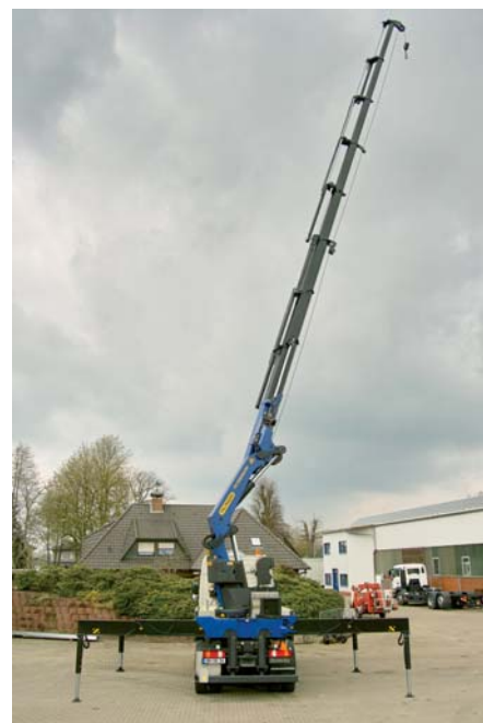
Hydraulische Reichweite satt: Der Kunde wählte einen 8-fach hydraulischen Ausschub und eine Seilwinde mit 3,5 t Zugkraft.
