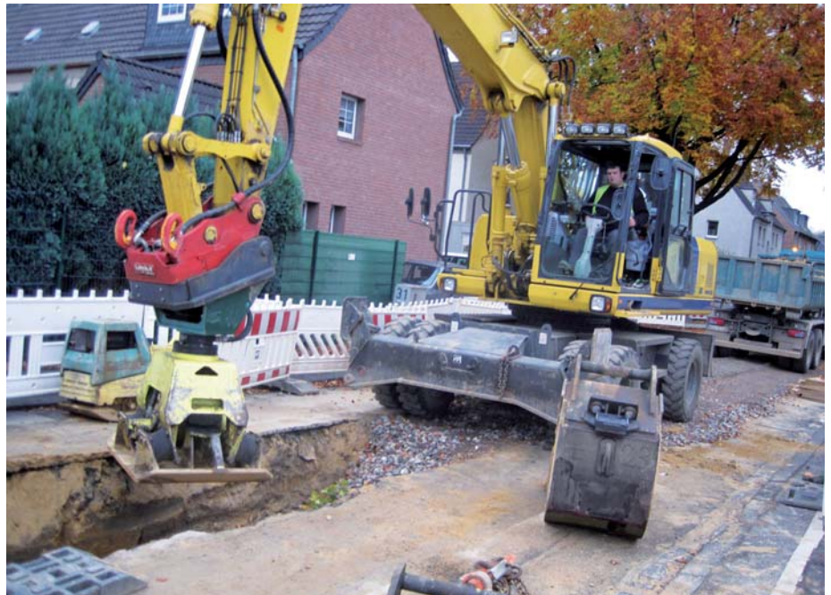
Das hydraulische Schnellwechselsystem mit Powerlift-Schwenkmotor eignet sich besonders gut für Kompaktbagger. (Fotos: Lehnhoff)
