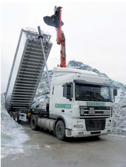
Der Sattelkipper mit Aluminium-Kastenmulde in Leichtbauweise erhielt auf Kundenwunsch einen Ladekran.
