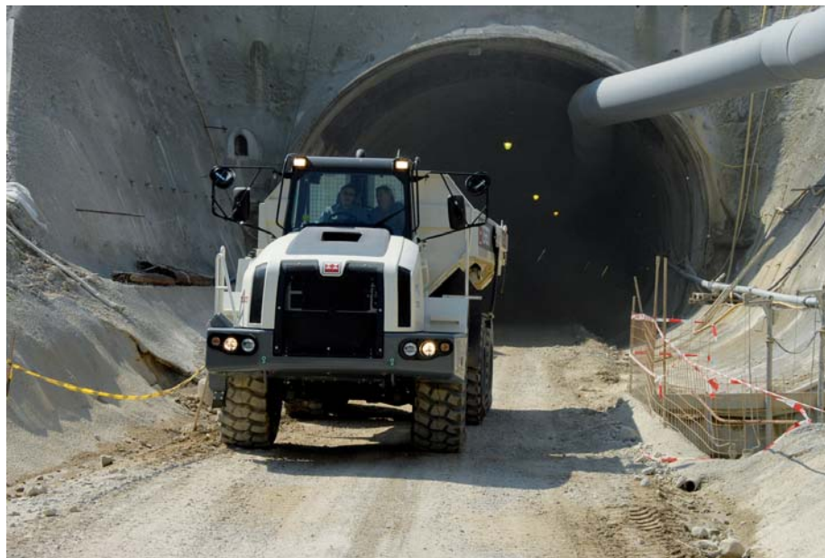
Rückwärts rein , beladen und wieder raus: Große Außenspiegel und Rückfahrkamera ermöglichen optimale Sicht nach hinten. (Foto: Terex)
