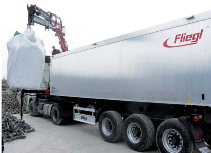
Ausgestattet mit einem Zweischalengreifer am Kranarm verlädt der Fahrer das zu recycelnde Altglas in seinen Auflieger.
