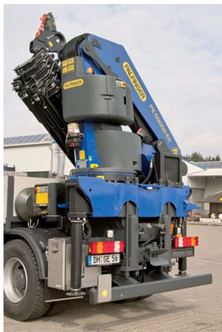
Schluss mit Hydraulikschlauch-Wirrwarr – der Ladekran ist sauber aufgebaut.
