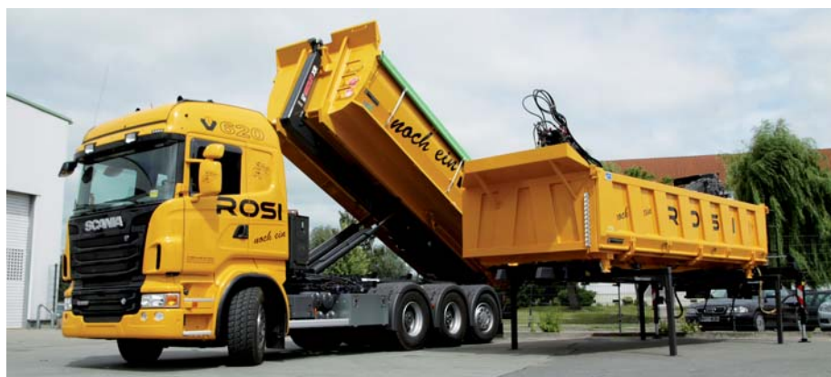
Das Schnellwechselsystem Cameleont ermöglicht ein schnelles Wechseln der Aufbauten, z. B. von einem Abroll- zu einem Kippsattelanhänger. (Foto: Hüffermann)
