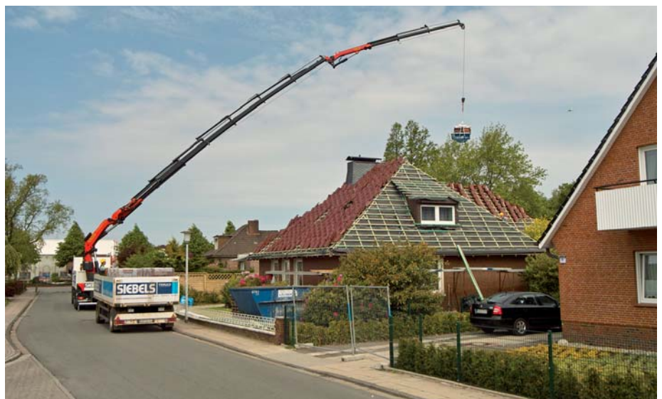
Reichweite bringt Vorteile: Palfinger PK 40002-EH mit Knick-Verlängerung und Seilwinde in der Hochkranlogistik. (Foto: Palfinger)
