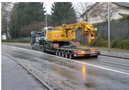
Die neue Schwerlastkombination ist für eine Nutzlast von knapp 77 t ausgelegt. (Foto: Goldhofer)
