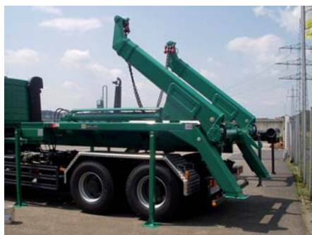
Hier unterfährt die Zugmaschine den Absetz-Kipper-Aufbau. Heben, Senken und Verriegeln erfolgt hydraulisch. (Foto: Meiller)
