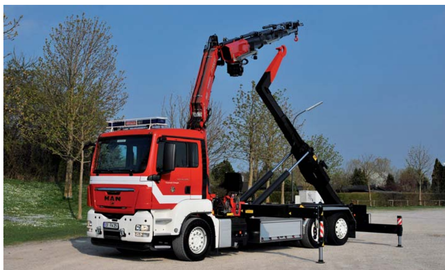
Flexiblen Einsatz versprechen Wechselladerfahrzeuge wie dieser MAN TGS 26.400, der mit einem Hakenabrollgerät und einem Ladekran ausgestattet ist. (Foto: MAN)
