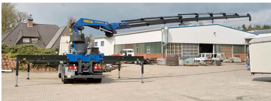
Gut zu sehen , der Knickarm kann überstreckt werden – ein Vorteil in bestimmten Einsatzsituationen.
