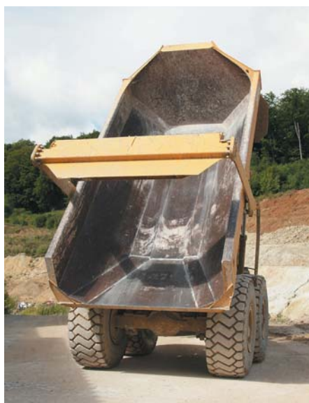
Nahezu rückstandsfrei entlädt der Bell B25D mit abgasbeheizter Mulde seine Fracht. (Alle Fotos: Bell Equipment/Thorsten Block)
