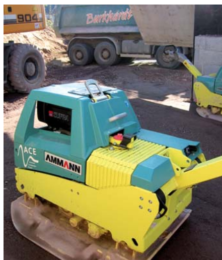
Das ACE-Display an den Rüttelplatten zeigt alle wichtigen Parameter an, die für eine optimale Verdichtung notwendig sind. (Foto: Ammann)
