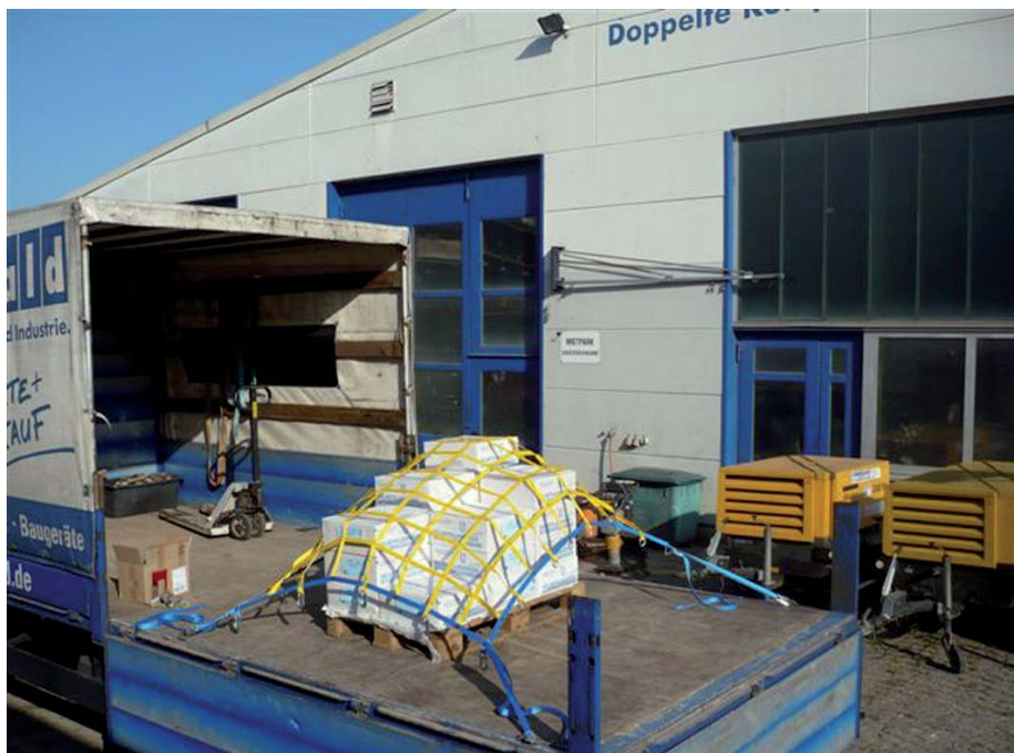
Mit dem neuen Gurtband-Ladungssicherungsnetz lassen sich kleine Ladegüter und große Einzelstücke rutschticher verzurren. (Foto: Eberle-Hald)
