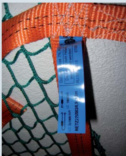
Das Etikett dieses orangenen Ladungssicherungsnetzes enthält die Benennung der Zurrkraft. (Foto: Trautmann)
