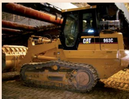
Der Kettenlader Cat 963C arbeitet sich durch Leipzigs Untergrund. Dafür wurde er mit einem Huss-Dieselpartikelfilter FS 80 MKM ausgestattet.
