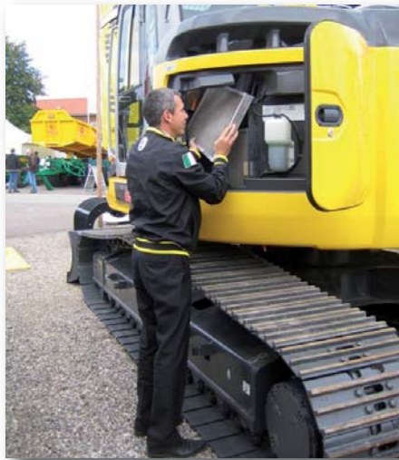
Die Filterelemente des New Holland Kettenbaggers E235B SR schützen den Motor vor Staub und die Umwelt vor Lärm. Sie sind mit einem Handgriff aus- oder eingebaut.
