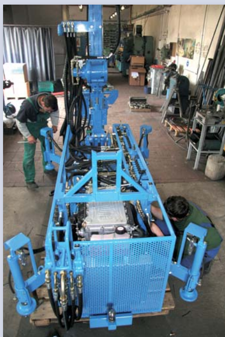
Nur mit einem kompakten und zugleich leistungsstarken Motor wie dem 4W35 sind Bohrgeräte wie das hier vorgestellte KB 13 von Kurth überhaupt realisierbar. (Foto: Sepp Rixner)
