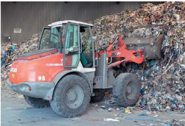
Die spezielle Ausstattung machen den Atlas-Radlader AR 95 resistent gegen Staub, Lärm und Hitze. Eine robuste Bereifung sorgt für lange Standzeiten. (Foto: F. Weyhausen)
