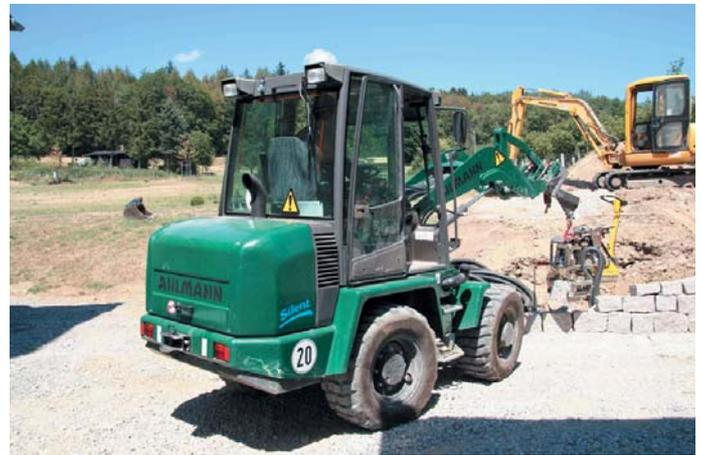
Mit der Greifzange am Ausleger werden Steine sicher und schnell verlegt. (Fotos: Ahlmann)
