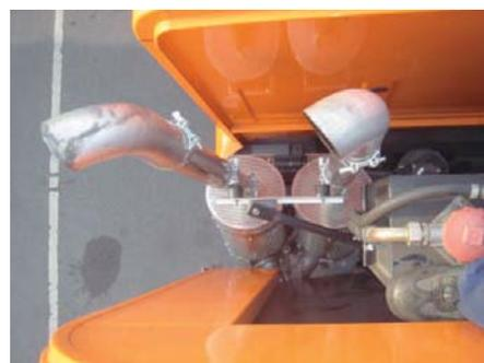
Blick von oben auf das an der Kabinenrückwand des Econic befestigte Doppelfiltersystem.
