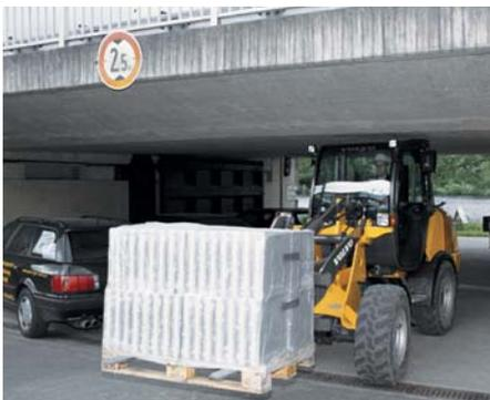
Die Kompakt-Radlader verfügen über beeindruckende Hubkräfte. Der abgebildete L25B ist besonders gut manövrierfähig – auch bei niedriger Deckenhöhe.
