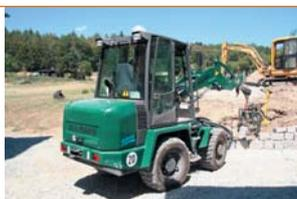
Sie müssen zugkräftig, leistungsstark und natürlich wendig und vielseitig einsetzbar sein: Radladermodelle mit Schaufelinhalten von 0,5 bis 1,5 Kubikmeter werden vorrangig für knifflige Aufgaben auf beengten Baustellen und im Rahmen von GaLaBau-Maßnahmen eingesetzt. Moderne Modellreihen von 0,5 bis 1,5 Kubikmeter Ladevolumen entpuppen sich als wahre Multitalente, denn sie arbeiten zuverlässig dort, wo es auf Ladeleistung in kompakten Abmaßen ankommt.
