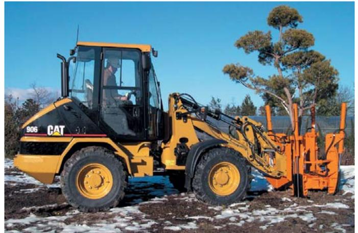
so dass die Maschinen selbst auf glattem Untergrund im Winter standsicher sind. Darüber hinaus haben die Lader nichts an Wendigkeit eingebüßt. Im Gegenteil: Aufgrund ihres kurzen Hecks sind sie auch auf engstem Raum einsatzfähig. Die Knicklenkung macht es besonders leicht, präzise zu arbeiten: Kurzes Einlenken und schon kann das Anbaugerät eingefädelt werden, ohne dabei immer wieder vor und zurück fahren zu müssen.
