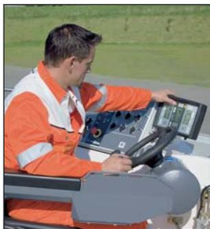
Präzise und sichere Nivelliersysteme zählen zu den Kernkompetenzen des Frässpezialisten aus Windhagen. Wirtgen hat jetzt ein eigenes, richtungsweisendes System mit einer speziell für Kaltfräsen programmierten Software entwickelt. Das Gesamtsystem besteht aus Sensoren, einer Regler-Einheit sowie einem Bedienpanel für den Fahrer.
