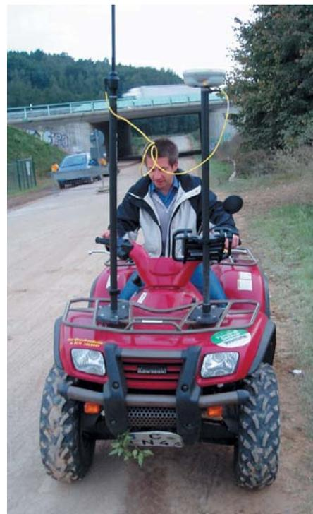
Die Steuerung lässt sich nicht nur an Baggern installieren, sondern wie hier dargestellt auch an einem Quad, der gerade die Trasse abfährt.
