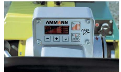
Die AVH 6030 mit ACE verdichtet wahlweise im manuellen oder im Automatikmodus und verhindert so eine Überverdichtung des Bodens.
