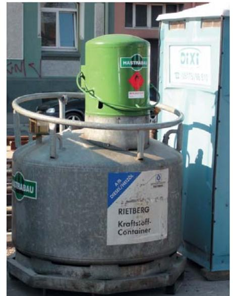
Großpackmittel mit entsprechender Kennzeichnung und Gefahrzettel, wie sie im Baugewerbe oft verwendet werden.
