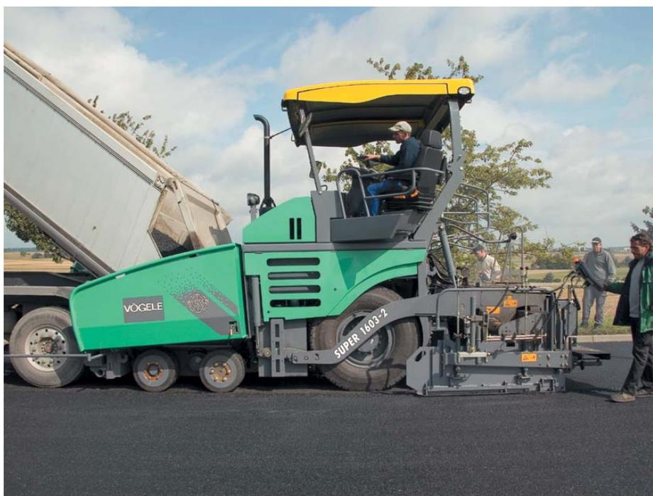
Hydrostatische Einzelantriebe in beiden Hinterrädern sorgen für eine maximale Kraftübertragung. Optional können zusätzlich zwei Vorderräder angetrieben werden. (Fotos: Vögele)
