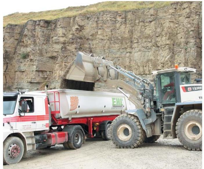
Der Terex TL 450 startet mit der Beladung eines Sattelzuges. Mit seiner 4,5-m<sup>3</sup>-Standardschaufel kann er jeweils bis zu 8 t mineralische Rohstoffe aufnehmen. (Foto: Terex)
