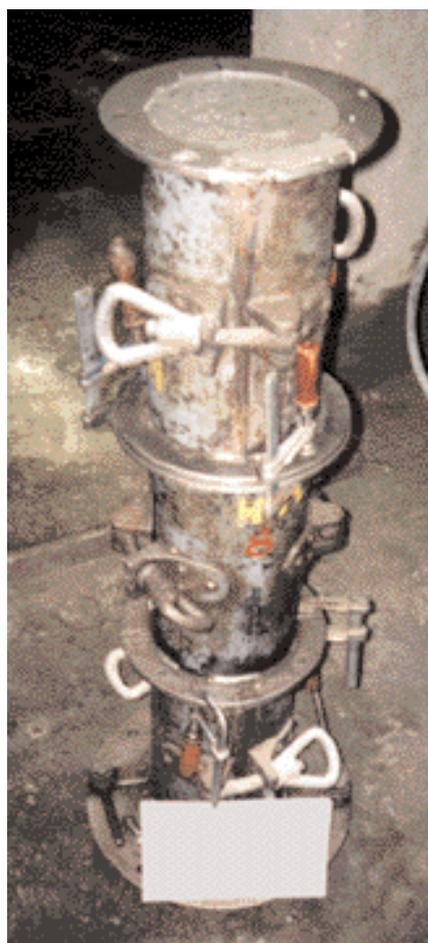
Bild 4: Versuchsaufbau des „Drei-Zylinder-Tests“ /8/.
