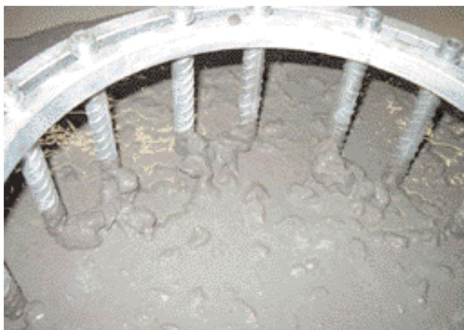
Bild 2: Blockierender SVB beim Blockieringversuch.
