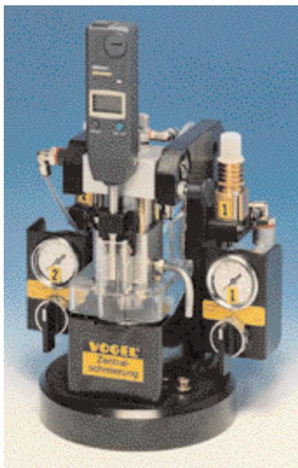
Fett-Testgerät überprüft die Eignung für den Einsatz in Progressiv-Zentralschmieranlagen. (Fotos und Grafik: Vogel)
