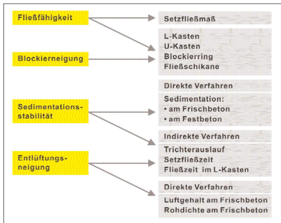
Bild 1: Frischbetoneigenschaften und -prüfungen von Selbstverdichtendem Beton /6, 7/.
