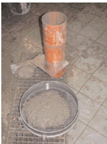
Bild 6: Sedimentationsversuch am Frischbeton.
