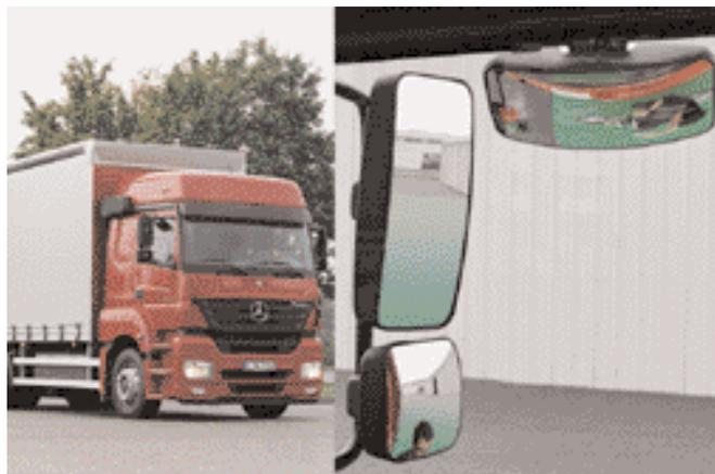
der auf der Beifahrerseite oberhalb der Tür installiert ist. Letzterer ist entscheidend dafür verantwortlich, dass das Umfeld bis Stoßfänger, Beifahrertür und Bereich der Vorderreifen deutlich vom Fahrer wahrgenommen werden kann. Für mehr Sicht nach hinten sorgen Rückfahr- und der Weitwinkelspiegel. Mit ihrer um 50 mm weiter nach außen verlagerten Position verbessern diese Spiegel die Sicht nach hinten ganz erheblich. Der Weitwinkelspiegel zeigt dem Fahrer
