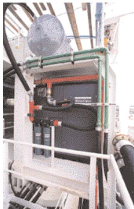
Für den Stützdruck beim Werkzeugwechsel sind in der Tunnelbohrmaschine zwei GA-Kompressoren installiert. (Fotos: Atlas Copco)
