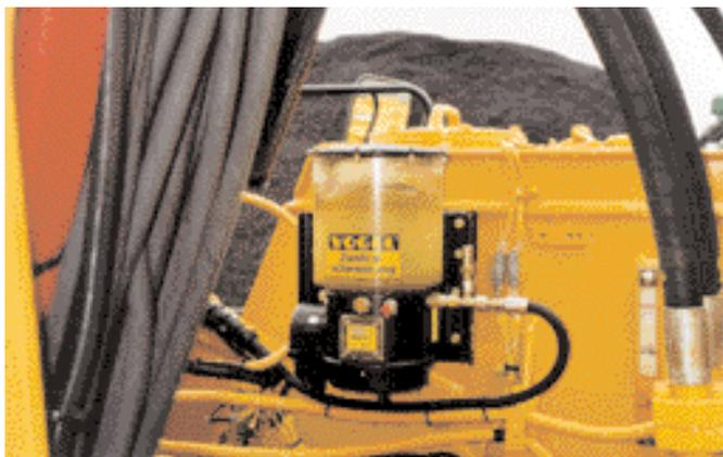
Für jede Baumaschinengröße der passende Fettvorrat: Motorpumpenaggregat der Baureihe KFGS mit 6-l-Behälter.
