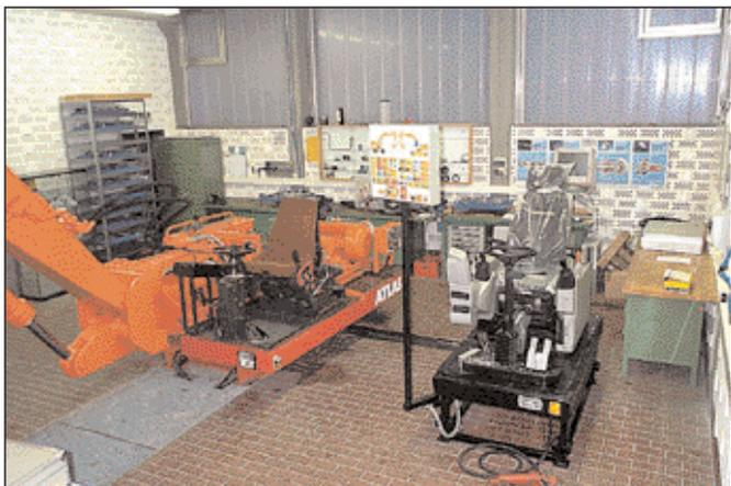
Simulationsanlagen zur Steuerungstechnik von Atlas und Liebherr.
