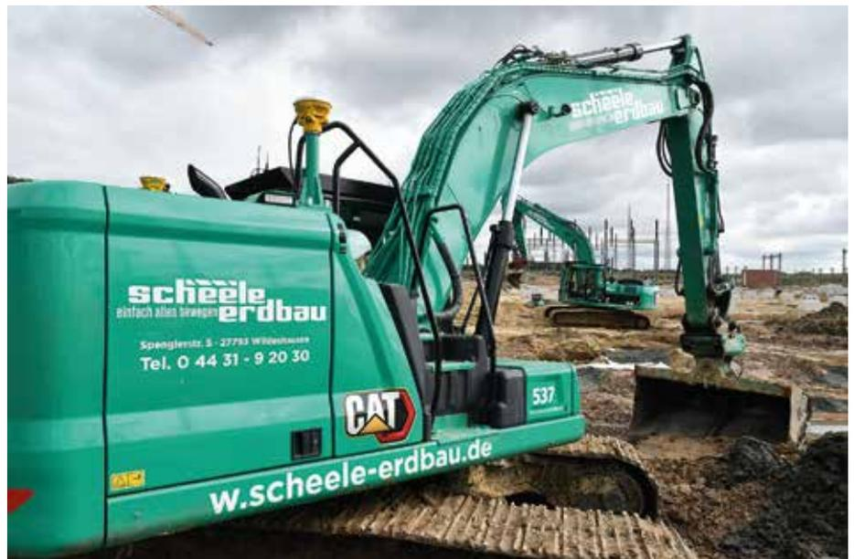
**Digitalisierung geglückt:** Vor anderthalb Jahren hat das Erdbauunternehmen Scheele eine erste Maschine mit einer 2D-Maschinensteuerung ausgerüstet und kann nun bereits größere Erdbauprojekte effizient umzusetzen. (Foto: Scheele GmbH & Co. KG)
