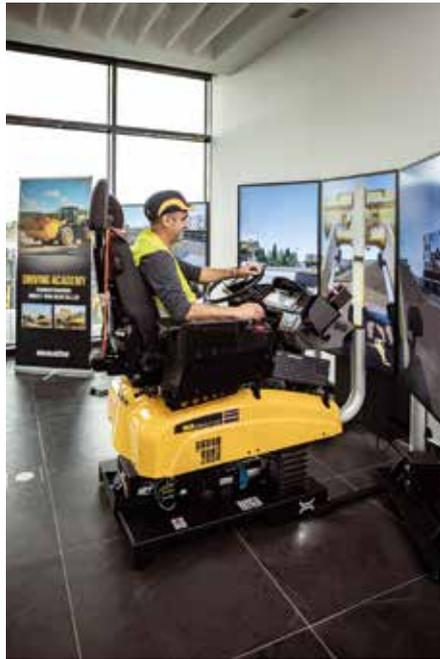
**Abbildung der Baumaschine:** Im Baumaschinensimulator wird die Frontperspektive aus Sicht des Fahrers mittels drei 55"-Monitoren wiedergegeben.
