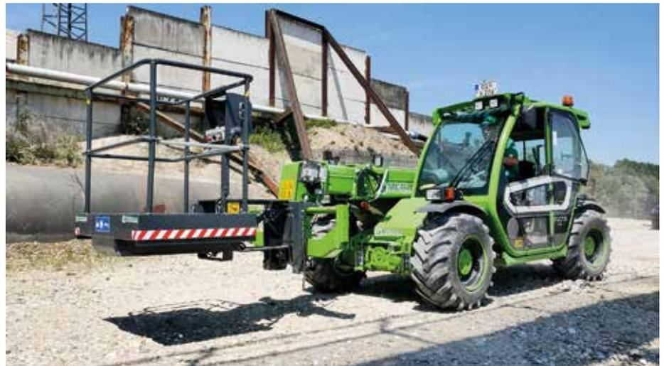
**Flexibel:** Im Handumdrehen lässt sich der P 27.6 von Merlo von der Hubarbeitsbühne zum Radlader oder zur Kehmaschine verwandeln. (Foto: Merlo)
