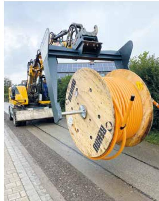
**Einfache Handhabung:** Mithilfe des Kabelmasters von Ellsäßer Engineering können Kabeltrommeln von nur einer Person transportiert und abgerollt werden. (Foto: Ellsaesser Engineering)
