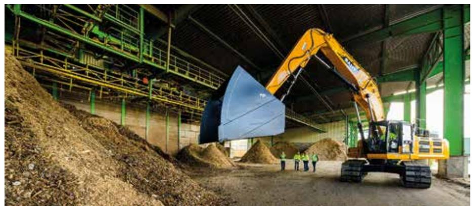
**Verwandlung:** BSS heavy machinery hat einen Sany SY 500H in einen kettenbetriebenen Hochleistungslader umgebaut. (Foto: BSS)
