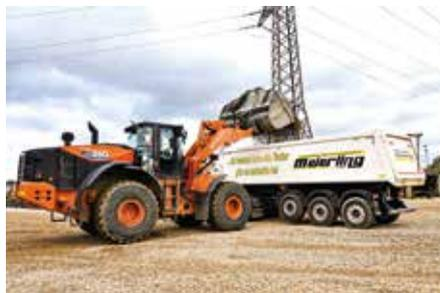
**Volle Kontrolle:** Die eingebaute geeichte Waage der Firma Pfreundt unterstützt den Fahrer beim Umschlag.
