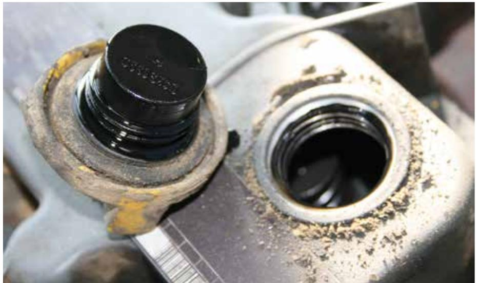
**Motorenpflege:** Vor der Winterpause sollten verschmutztes und überaltertes Öl sowie Ölfilter gewechselt werden. (Foto: GMI)
