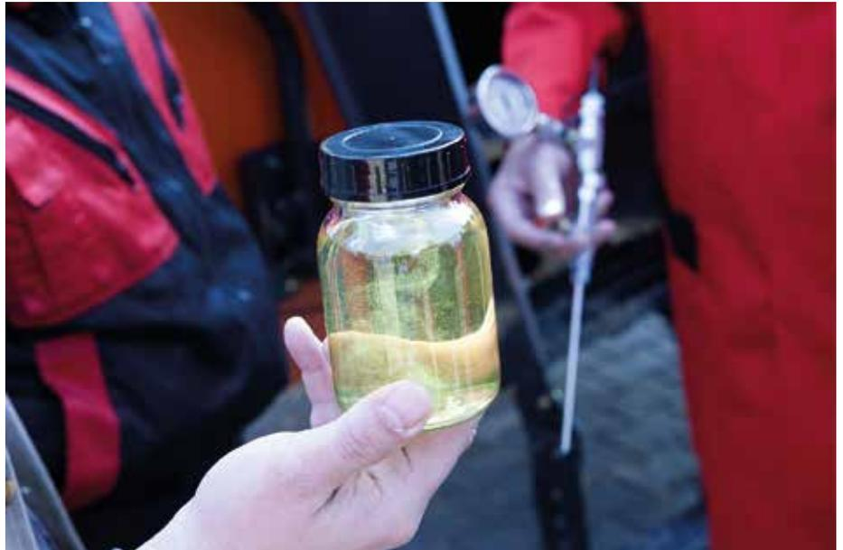
**Gefahr erkannt:** Bis zu 80 % der Ausfälle in hydraulischen Systemen sind auf eine unzureichende Pflege und Wartung der Hydraulikflüssigkeiten zurückzuführen. (Foto: Hansa-Flex AG)
