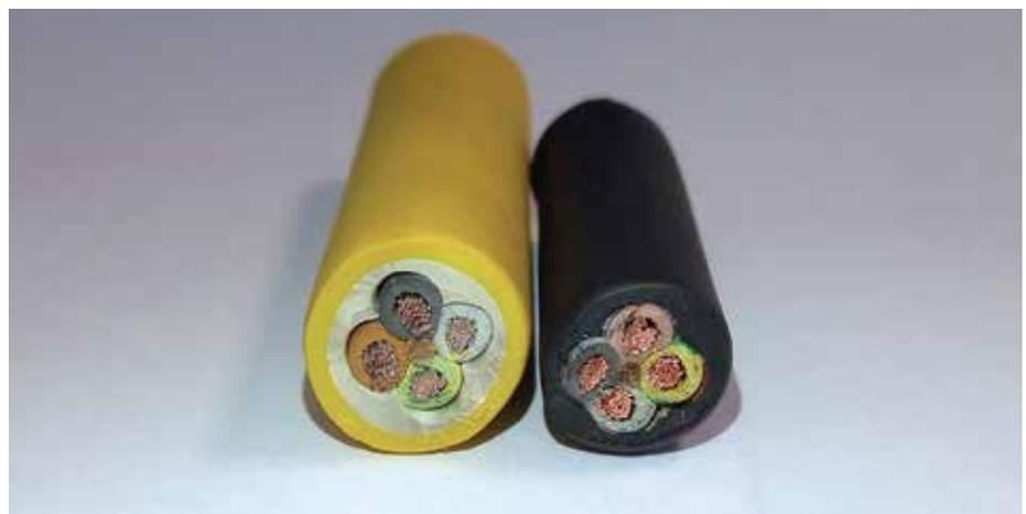
**Deutlicher Unterschied:** Links das Tsurumi-Kabel in Bergbauqualität, rechts ein Standardkabel. (Foto: Tsurumi)
