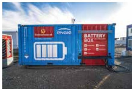
**Kraftpaket:** Mobile Stromaggregate können aus dem Stand heraus maximal 40 % Leistung erbringen, die Battery Box von Bredenoord liefert von Beginn an 100 %.
