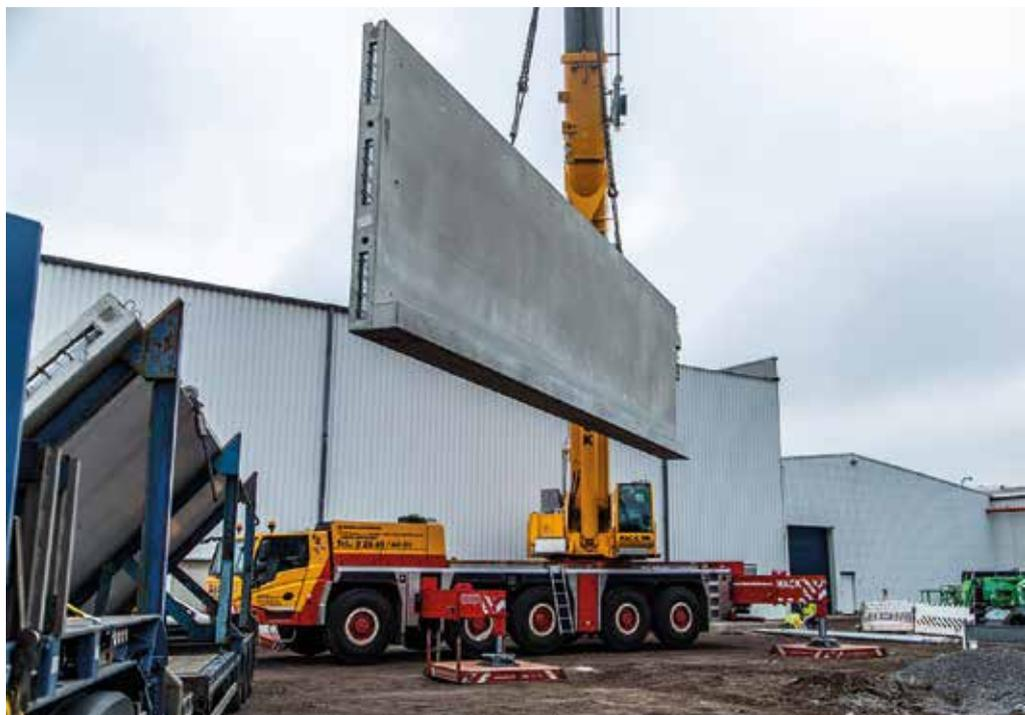
**Kein Hilfskran vonnöten:** Dank seiner zweiten Winde kann der ATF-220-5.1 Fertigbauteile heben und auch drehen. (Foto: Tadano)
