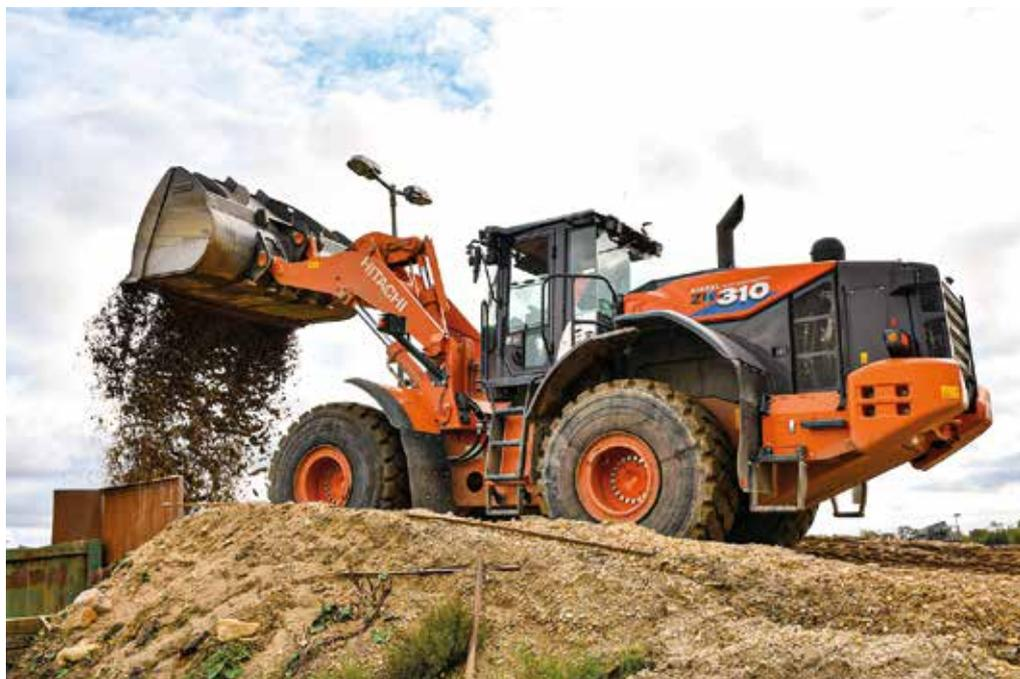
**Kraftvoll und unermüdlich:** Z-Kinematik und Hitachi-Spezialschaufel mit Überlaufschutz ermöglichen einen schnellen und effizienten Kiesumschlag. (Fotos: Dieter Göllner)
