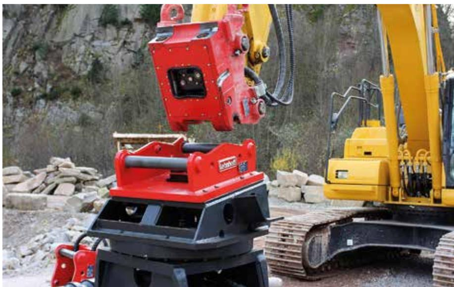
**Beschleunigtes Arbeiten:** Die neuen vollhydraulischen SQ-Wechsler von Lehnhoff sind für die Baggerklassen von 8 bis 43 t verfügbar. (Foto: Lehnhoff Hartstahl)
