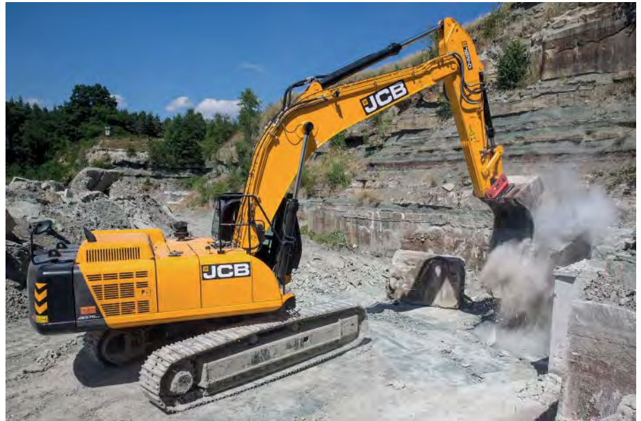
Hart zupacken: Der JS370 reißt einen großen Block Sandstein aus der Wand, der vorher mit der Schrämmsäge gelöst wurde. (Fotos: JCB)
