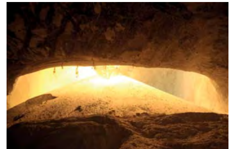
Blick in den Flachbunker Hattorf: Der neue Radlader muss über 11.000 t Rohsalz pro Schicht aus den vier Bunkerkammern mit 100.000 t Lagerkapazität fördern.
