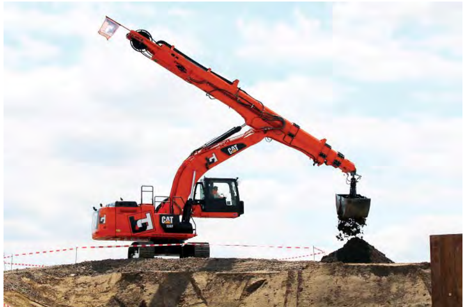
Der Teleskopbagger , eine Zeppelin-Spezialanfertigung auf Basis eines Cat-Kettenbaggers 336F, wird hydraulisch mit Zylindern ausgefahren und kann so einen punktuellen Druck auf das Erdreich ausüben. (Fotos: Jessica Haberlandt)
