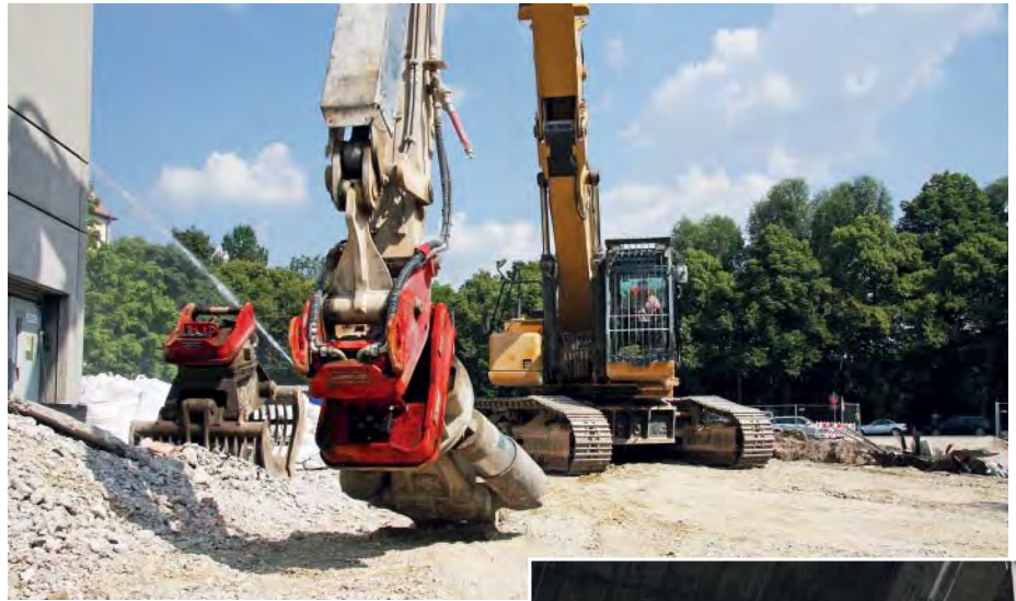
Der Werkzeugwechsel dauert selbst bei den Longfront-Baggern weniger als eine Minute. (Fotos: Lehnhoff)
