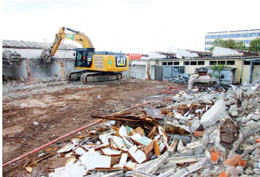
Entscheidende Bewegungen: Beim Schwenken gewinnt der Hybridbagger Energie für den nächsten Arbeitstakt zurück. (Fotos: Zeppelin)
