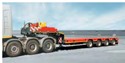
Die neue Achstechnik des EuroAxle ist wartungsfrei und sorgt für extrem niedrigen Reifenverschleiß. (Foto: Scheuerle)
