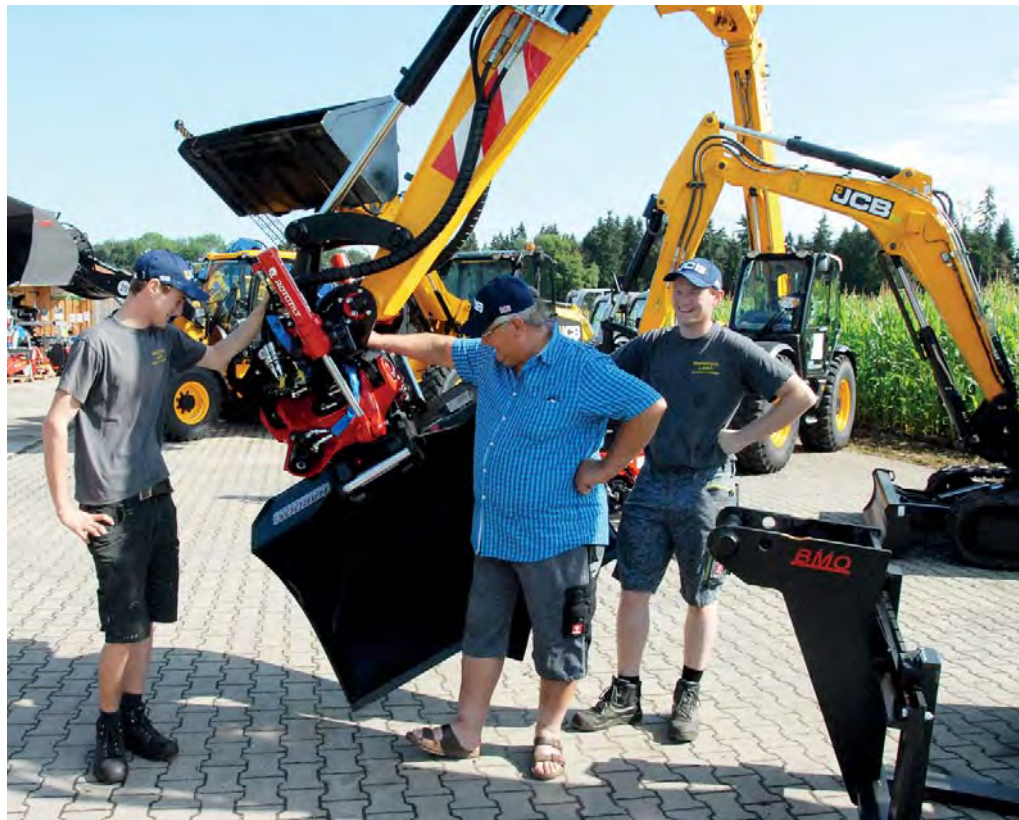
Praktisches Geburtstagsgeschenk: Johann Lang jr., Johann Lang sr. und Stefan Lang (v.l.) haben den ersten JCB Hydradig W110 mit einem Rototilt RT30 ausgerüstet. Der Baggerhersteller setzt das Gerät nun als Vorführmodell ein. (Foto: Rototilt)
