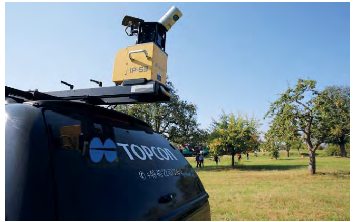
Dieses 3D-Datenerfassungssystem von Topcon ist flexibel auf nahezu jedem Fahrzeug installierbar und liefert wertvolle Daten bei der Überfahrt.
