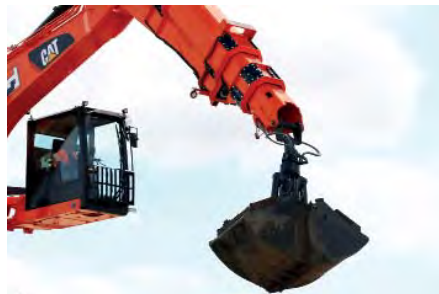
Der Ausleger samt Teleskopstiel wurde für den Einsatz mit einem 1,5 m 3 großen Zweischalengreifer konstruiert.
