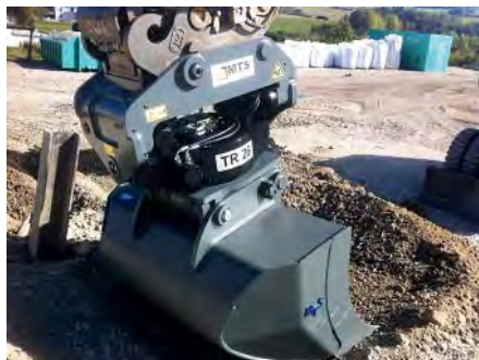
Größte Bewegungsfreiheit: Die innenliegenden hydraulischen Schwenkzylinder sorgen für eine komplette Seitenfreiheit und damit beschädigungsfreie Bedienung im Grabenbau. (Foto: MTS).
