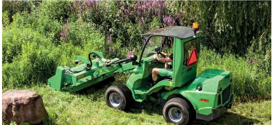
Seeidylle: Mit dem Schlegelmulcher befreit der kleine Radlader die Uferböschung des Baggersees von Wildwuchs. (Foto: Avant Tecno)
