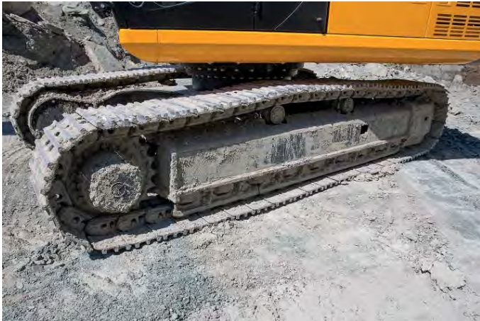
Verringert den Verschleiß: Die durchgehende Kettenführung verhindert das Eindringen von Steinen.
