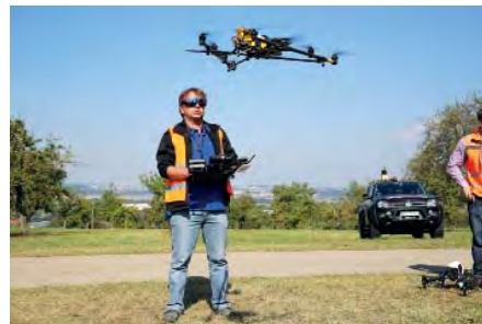
Der Oktokopter Falcon 8 von Topcon mit seiner patentierten v-förmigen Bauweise ermöglicht hochpräzise und hochauflösende Bilder des zu bearbeitenden Geländes.
