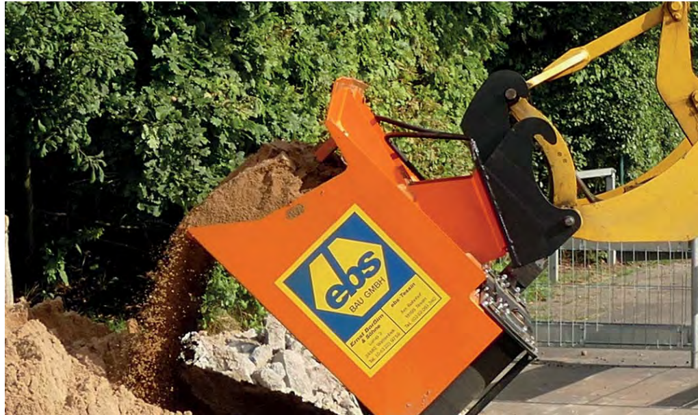
Der Finliner ist um 90° schwenkbar und nimmt wie eine Schaufel problemlos das Material auf. (Fotos: Optimas)
