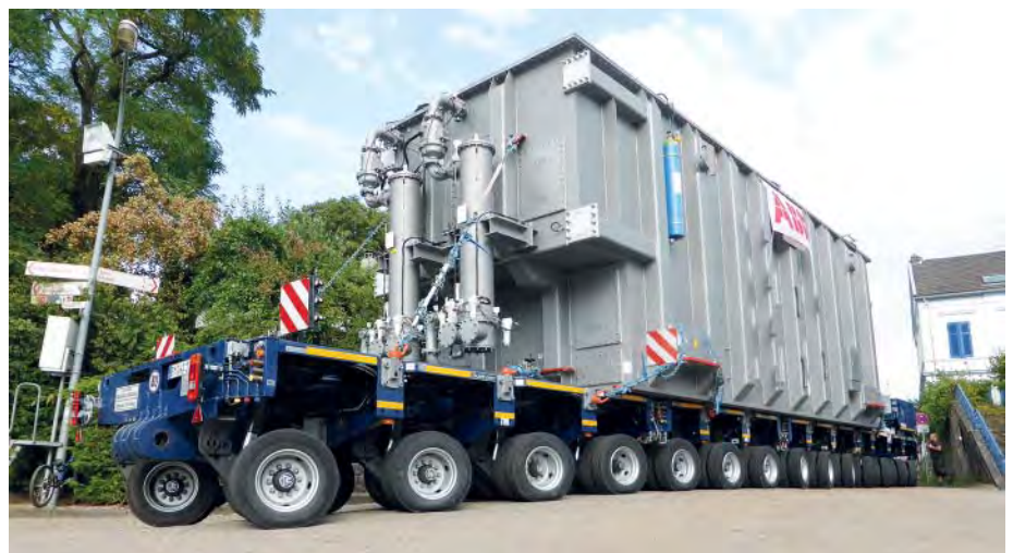
Der Transformator wird zur NATO-Rampe gefahren. Immer wieder musste das 280 PS starke PowerPack nachlenken und das Niveau ausgleichen: (Foto: Wasel)
